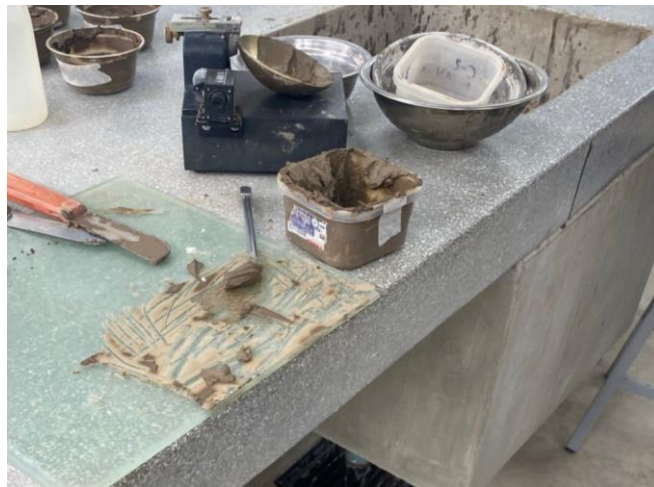
Imagen 15: Ensayo con cuchara Casagrande
