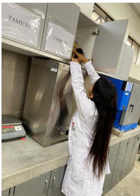
Imagen 13: Realización del ensayo por medio de tamices
