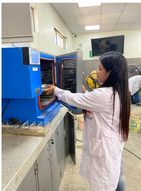
Imagen 12: Colocación de la muestra en el horno
