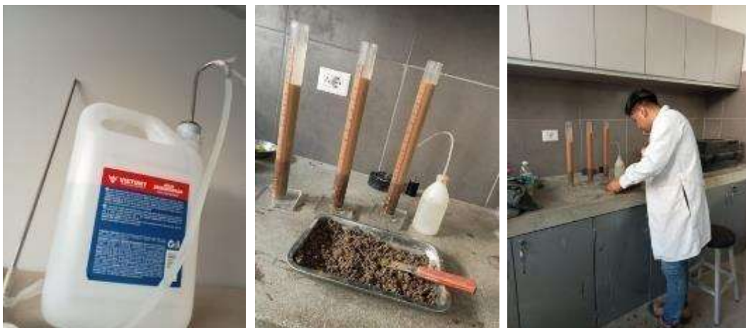
Ilustración 30: Solución con tubo irrigado y muestra de Equivalente de arena
