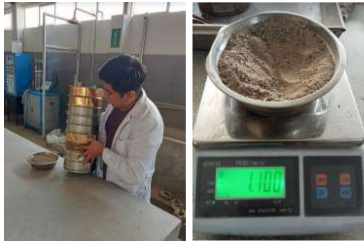
Ilustración 28: Tamizado y peso del agregado fino para la mezcla asfáltica
