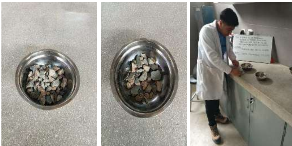
Ilustración 24: Muestras, dimensiones y conteo de caras fracturas
