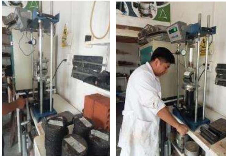
Ilustración 47: Asentamiento gradual sin agrietamiento mediante el ensayo de estabilidad
