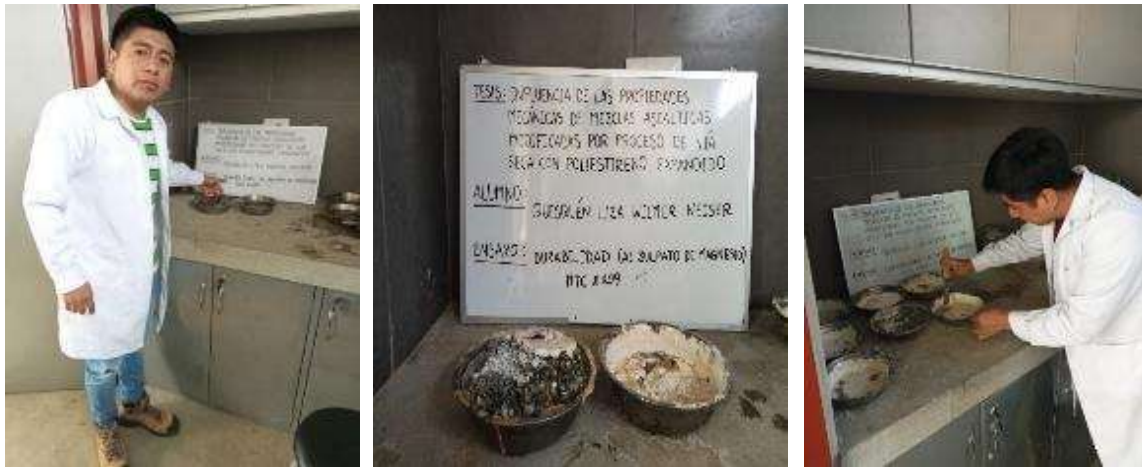
Ilustración 27: La desintegración del agregado grueso expuestos al sulfato de magnesio
