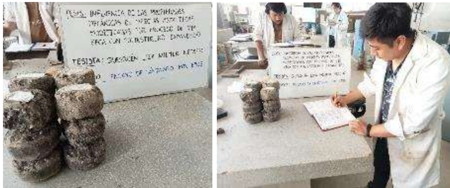
Ilustración 42: Briquetas después del ensayo de Cántabro por desgaste
