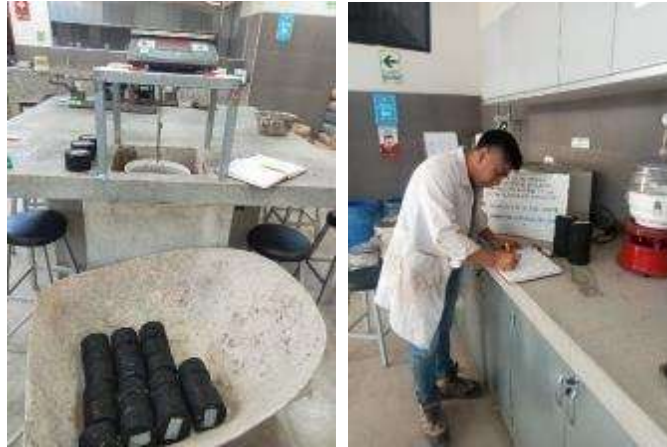
Ilustración 43: Peso específico y Rice para el ensayo de Lottman
