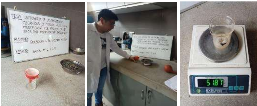
Ilustración 26: Muestra y filtración de Sales solubles en agregado grueso
