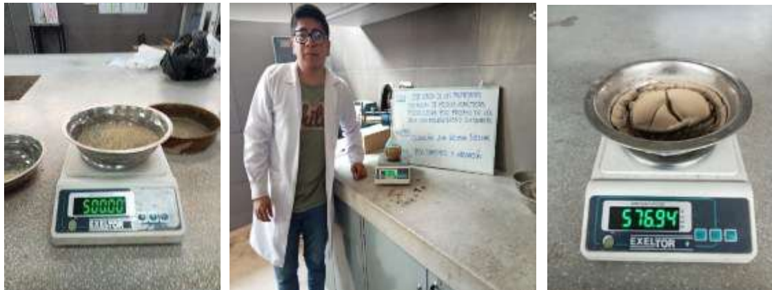
Ilustración 31: Peso específico y muestra final sacado del horno del agregado fino
