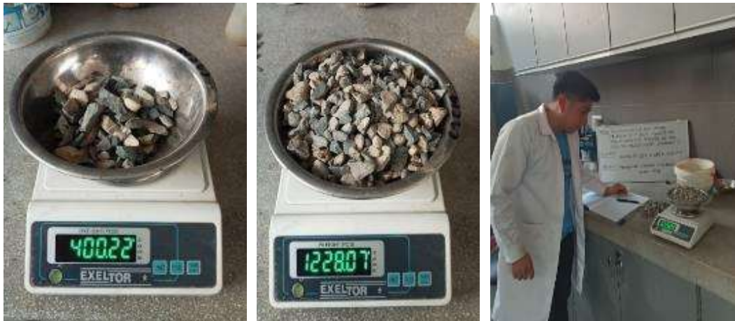
Ilustración 25: Selección de muestras y peso de caras fracturas y alargadas
