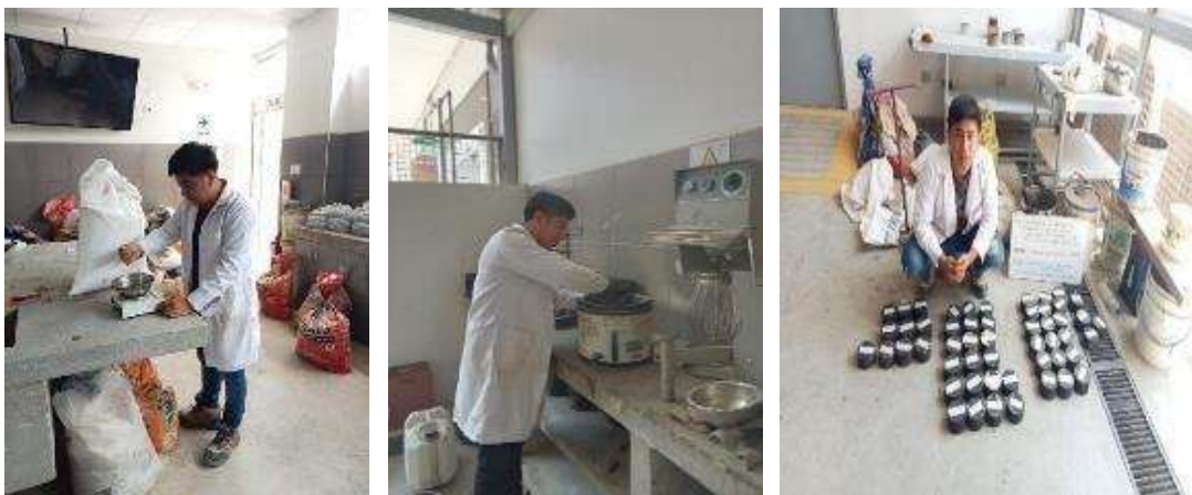
Ilustración 39: Briquetas experimentales con perlas de poliestireno expandido Fuente: Propia, 2024
