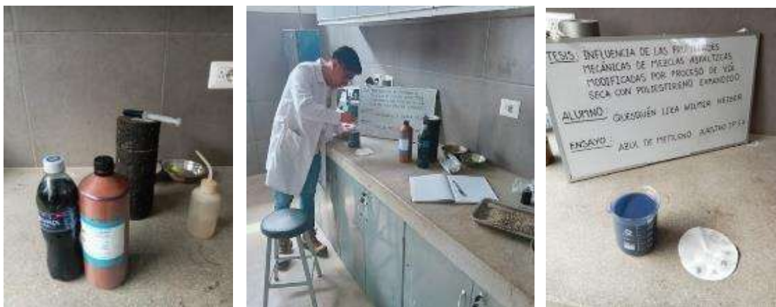
Ilustración 34: Ensayo de azul de metileno
