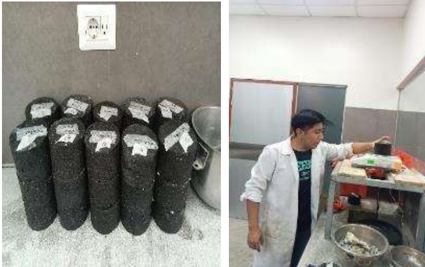
Ilustración 37: Peso y desmoldadas de briquetas
