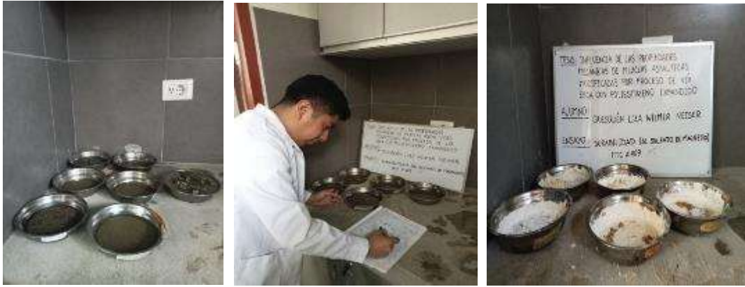
Ilustración 36: La desintegración del agregado fino expuestos al sulfato de magnesio
