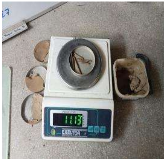
Azul de metileno del agregado fino
