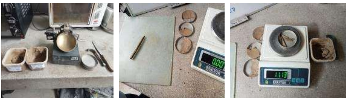
Ilustración 32: Muestras finales por la malla #200 del Índice de plasticidad
