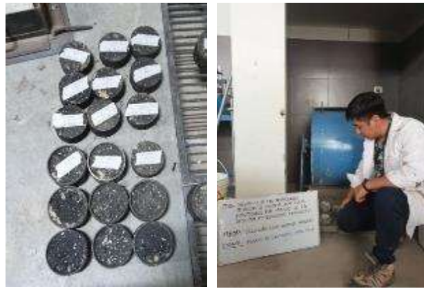
Ilustración 41: Briquetas para el ensayo de Cántabro de pérdida por desgaste
