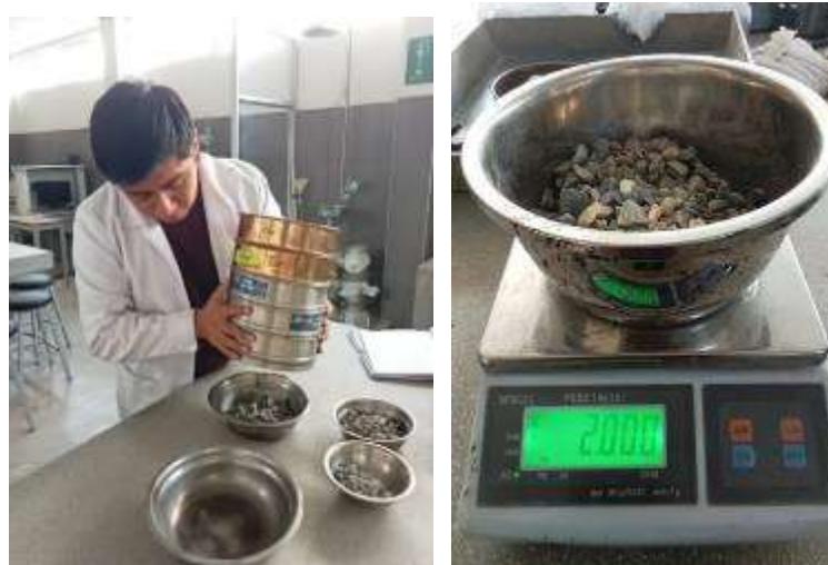
Ilustración 17: Tamizado del agregado grueso y muestra
