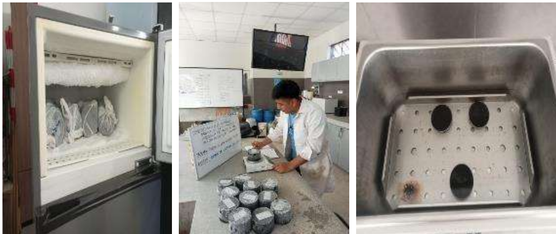
Ilustración 44: Briquetas a 60^{\circ}\text{C} y a -18^{\circ}\text{C}
