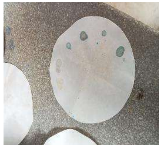
Azul de metileno del agregado fino
