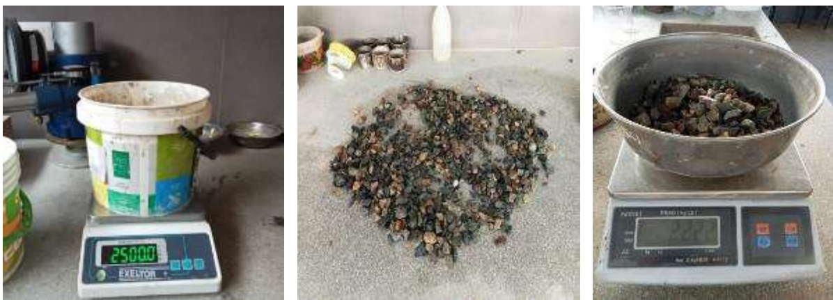
Ilustración 22: Absorción del agregado grueso y su muestra final
