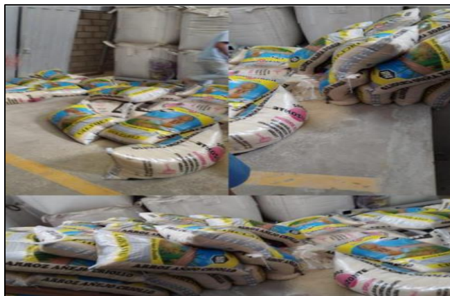
Figura 3. Caídas por inadecuada distribución
