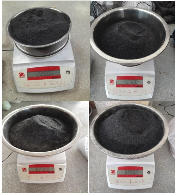
Ilustración 25: Pesos de la CCA para adicionar a las muestras para el ensayo de CBR
