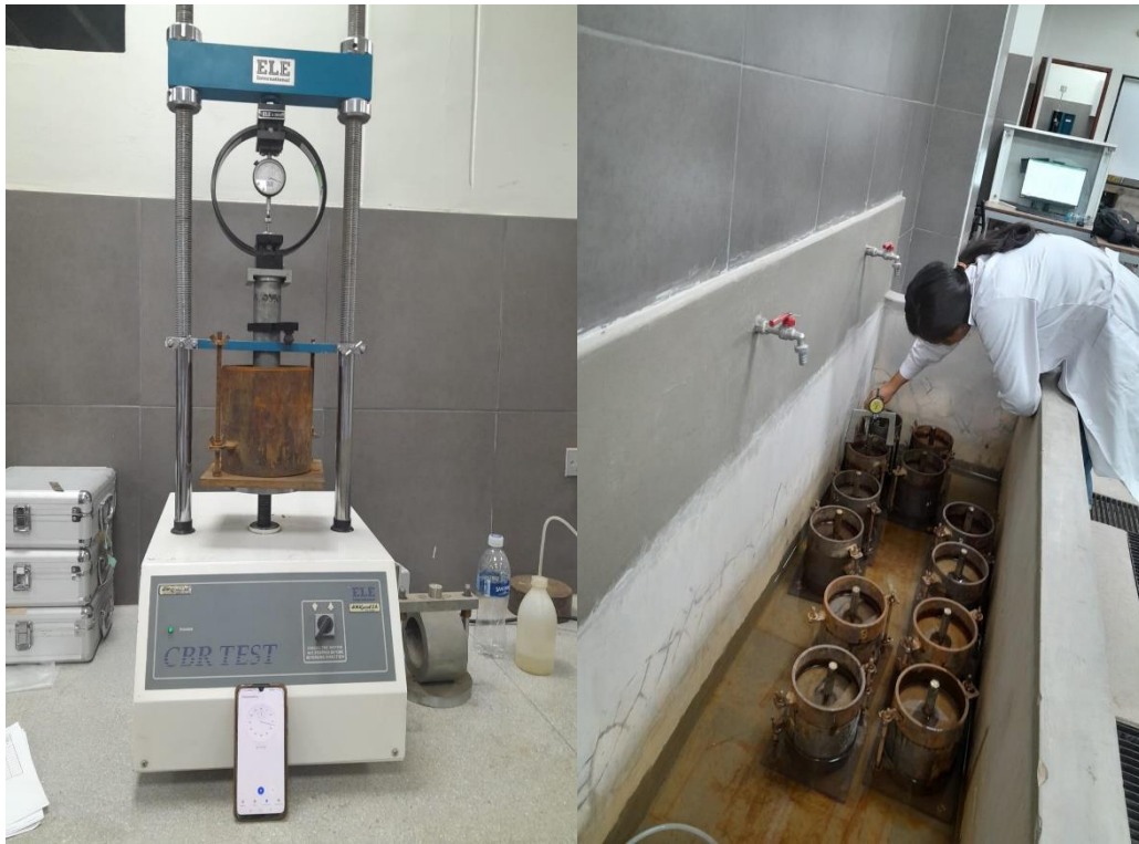
Se observa los moldes de CBR saturados, asimismo se observa la penetración de CBR
