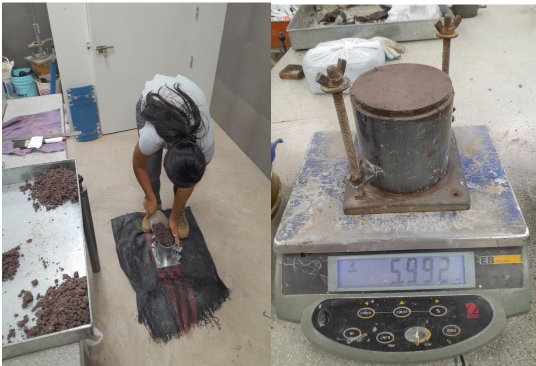
Ensayo de Proctor modificado
