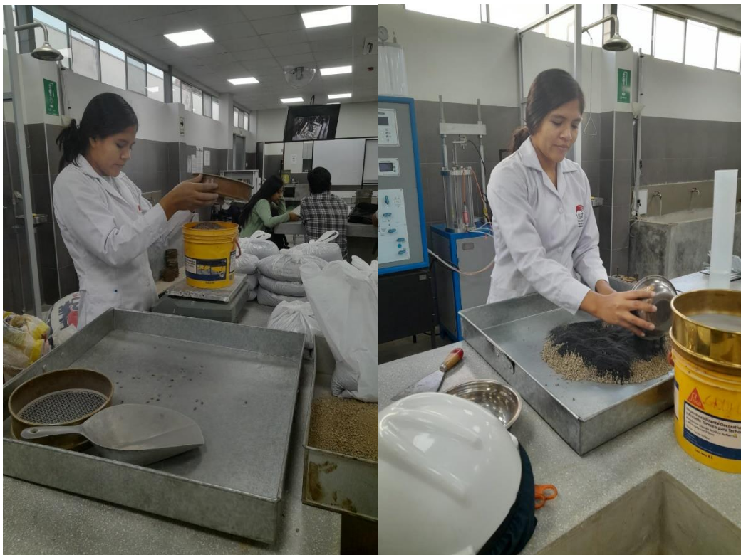
Se observa realizando el tamizado de la muestra y adicionando la CCA
