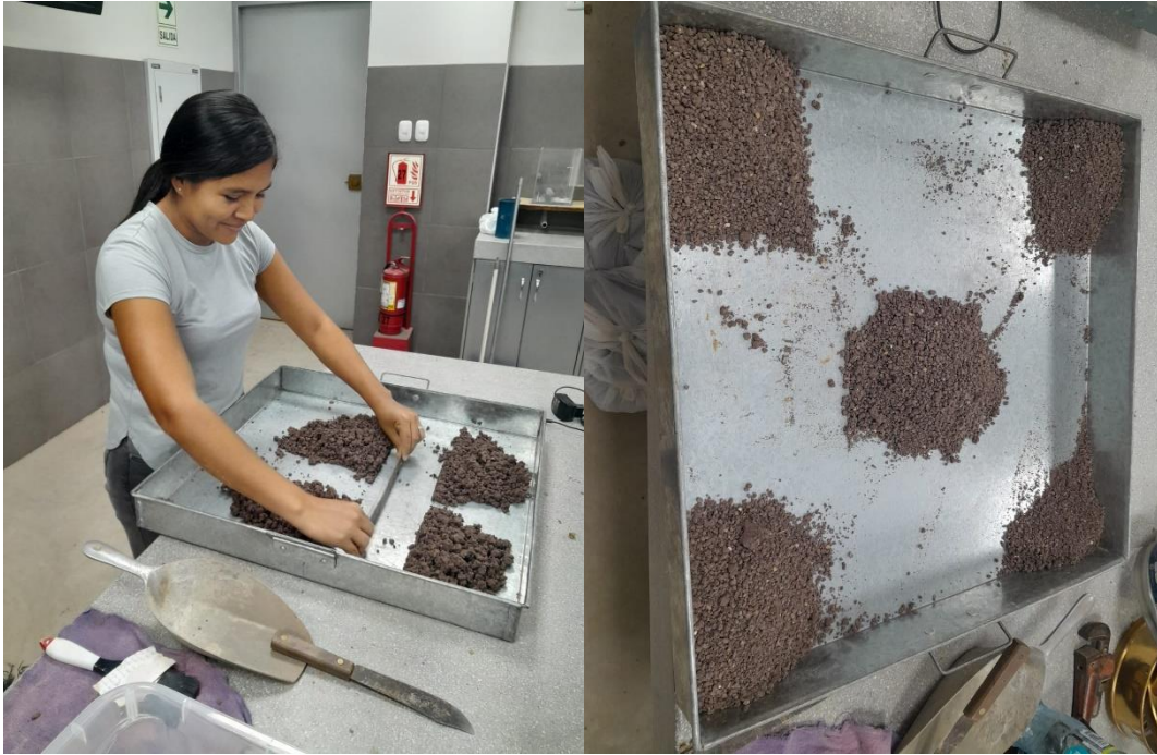
Se observa el cuarteo de la muestra para realizar el ensayo de Proctor modificado
