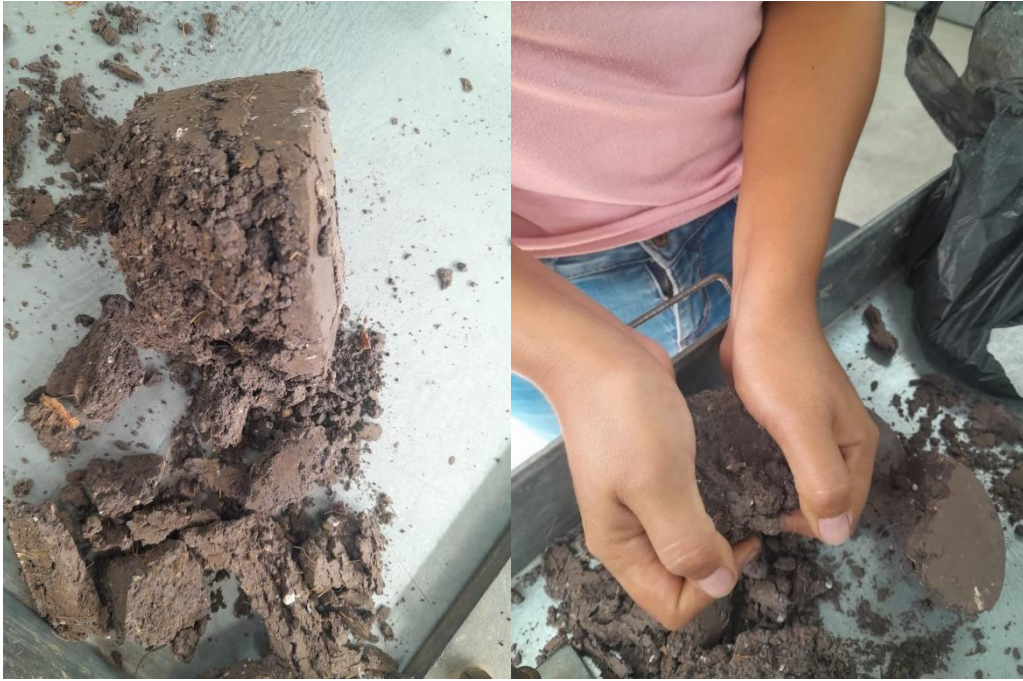
Se observa la fibra de coco cuando se realiza la compactación
