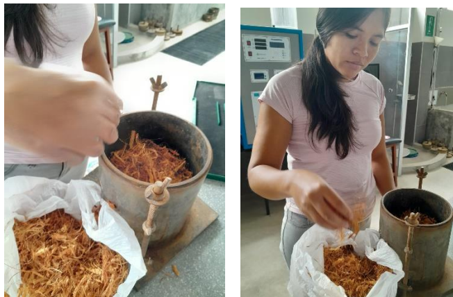
Ilustración 21: Colocación de la fibra de coco en el molde CBR
