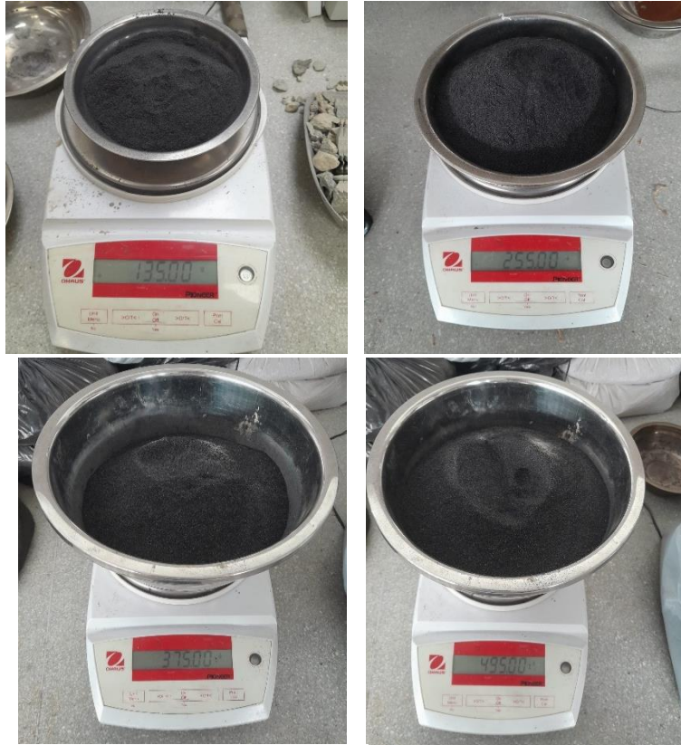
Ilustración 23: Pesos de la CCA para adicionar a las muestras para el ensayo de Proctor modificado
