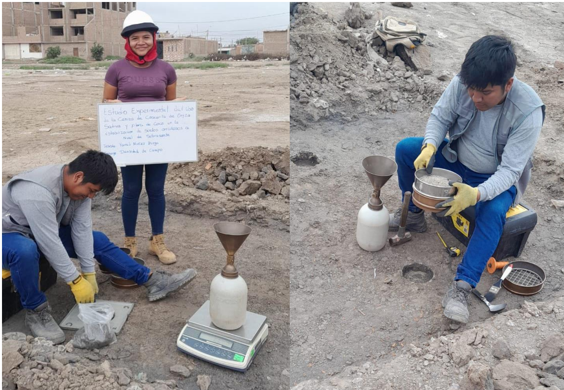
Extracción de las muestras compactadas para los ensayos correspondientes
