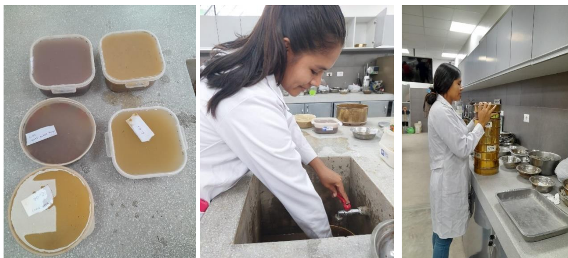
Ilustración 15: Granulometría por tamizado
