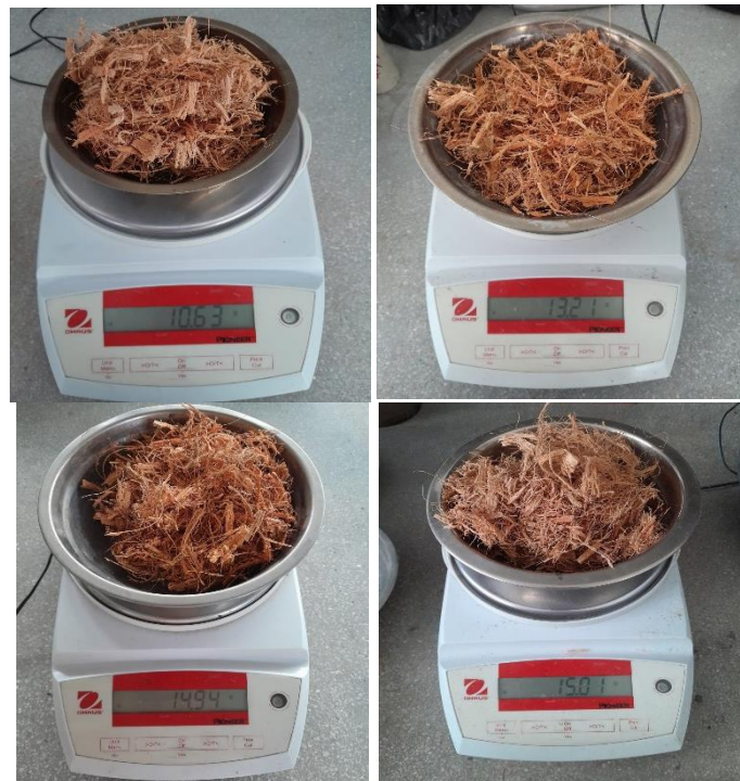
Ilustración 26: Pesos de la FDC para adicionar a las muestras en el ensayo de CBR
