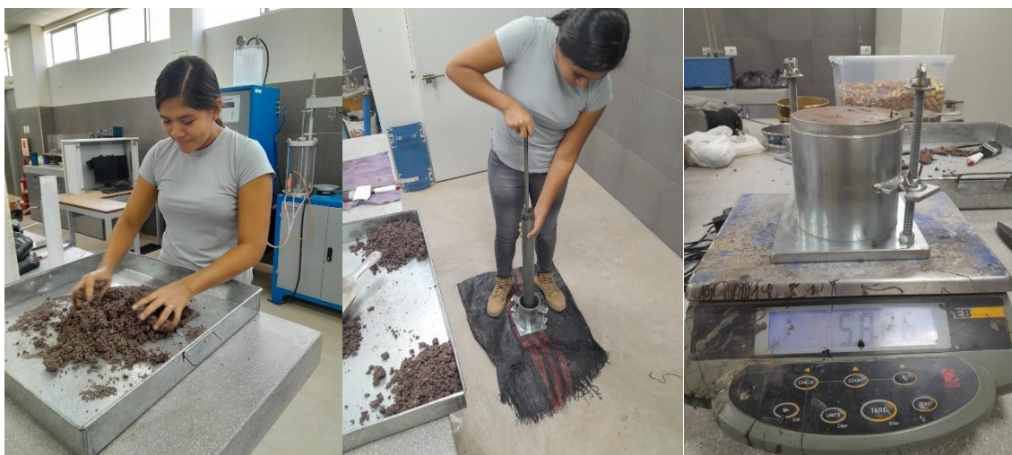
Ilustración 19: Ensayo de Proctor modificado
