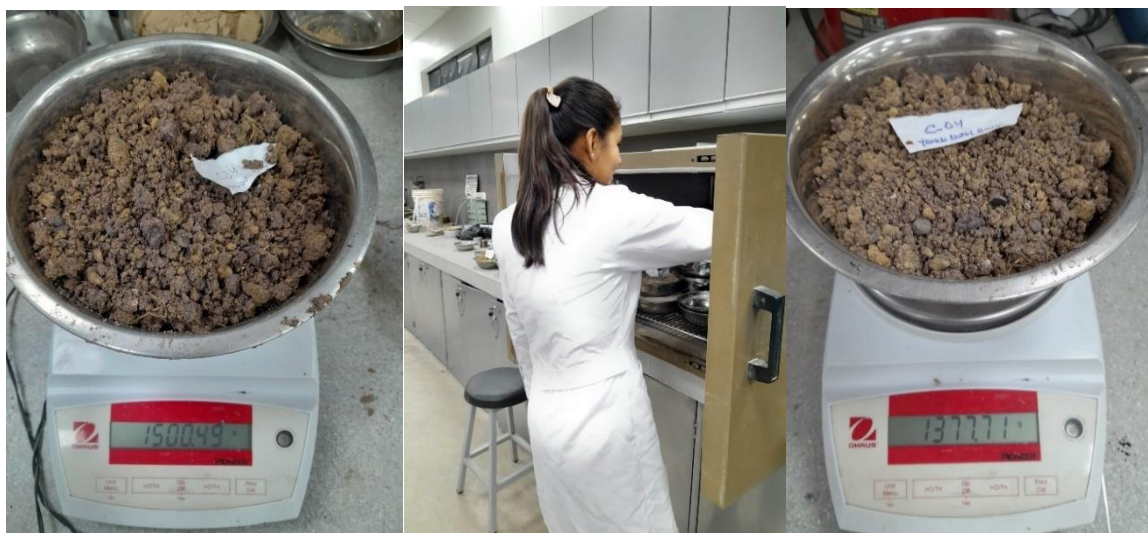
Ilustración 14: Determinación del contenido de humedad
