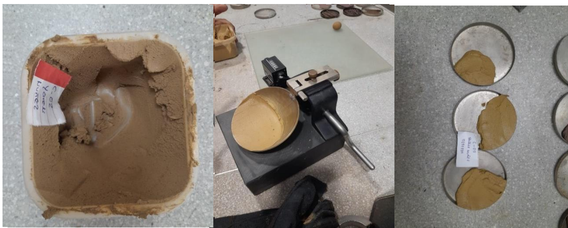
Ilustración 17: Ensayo de límite líquido
