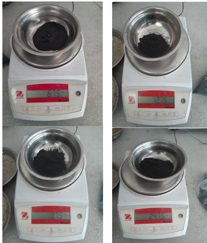
Ilustración 22: Peso de CCA para adicionar a las muestras para los límites de Atterberg
