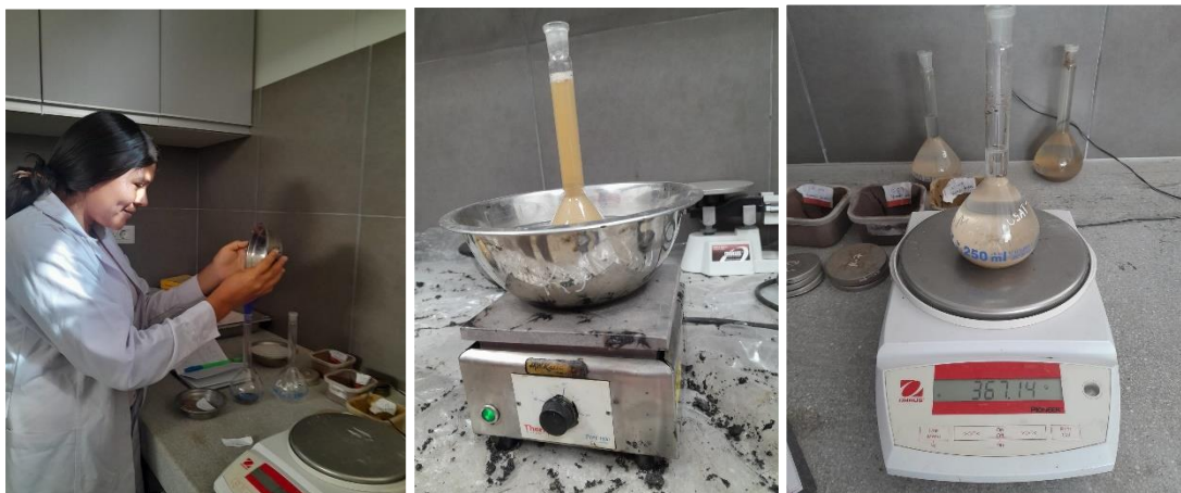
Ilustración 16: Ensayo de gravedad específica
