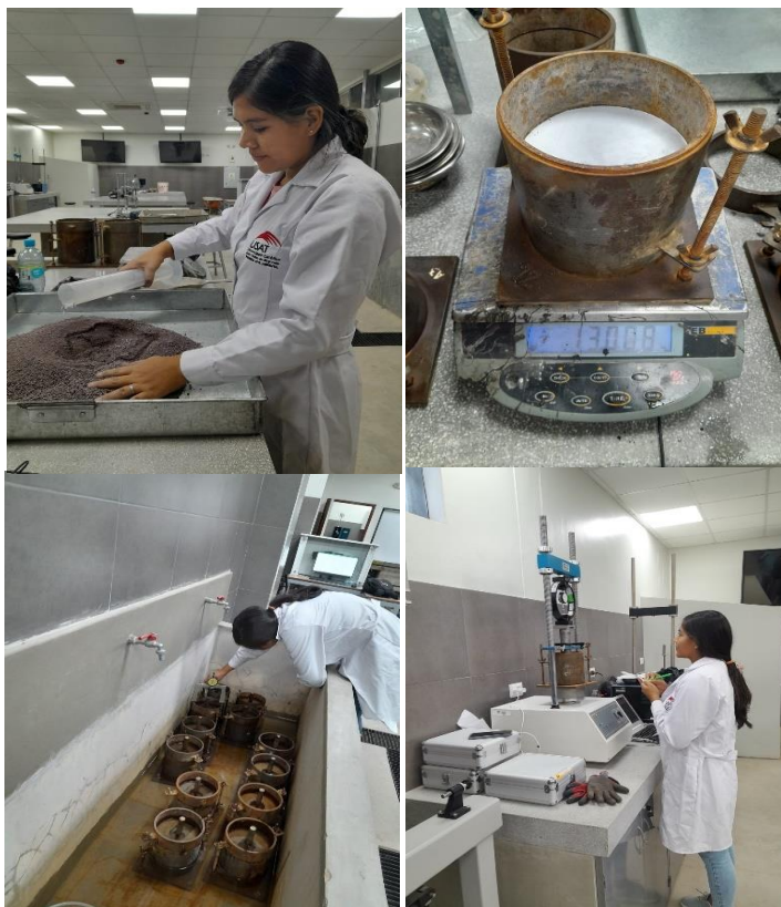
Ilustración 20: Ensayo de CBR
