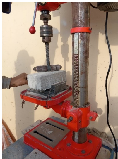
Fig. 81. Máquina de abrasión para adoquines
