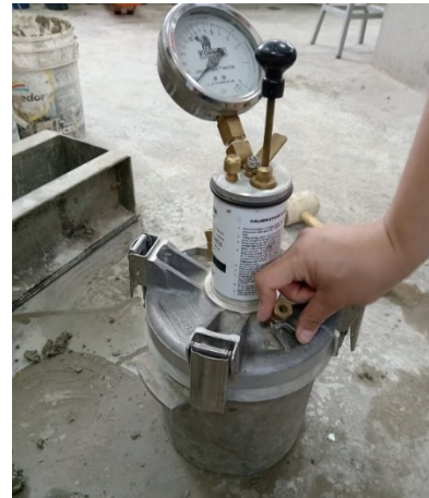
Fig. 58. Aparato de medición de contenido de aire por presión
