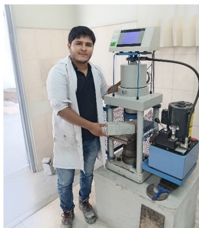
Fig. 71. Ensayo de Resistencia a la compresión
