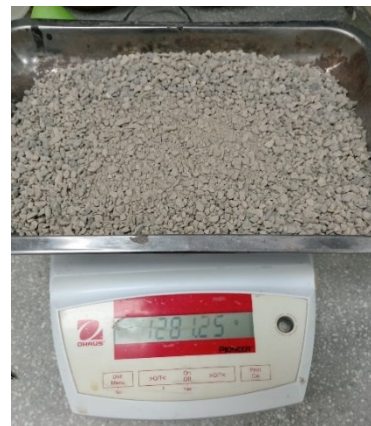
Fig. 53. Peso sobrante después del ensayo
