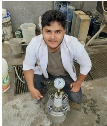
Fig. 60. Ensayo de contenido de aire en el concreto
