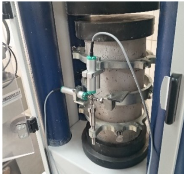
Fig. 86. Instalación de sensores
