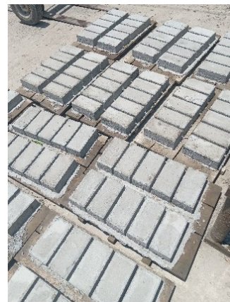
Fig. 66. Adoquines después de 24 horas de elaboración
