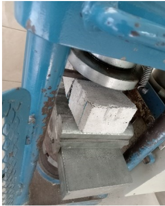
Fig. 72. Colocación de los adoquines en la máquina de flexión
