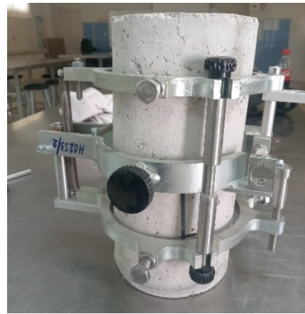
Fig. 85. Instalación de compresómetro
