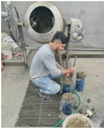
Fig. 84. Elaboración de probetas.
