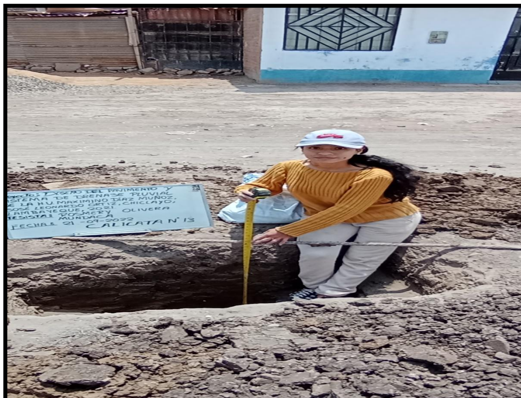
Ilustración 45: Exploración de Calicatas-C13
