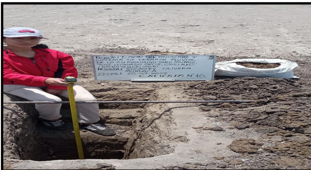
Ilustración 44: Exploración de Calicatas-C10
