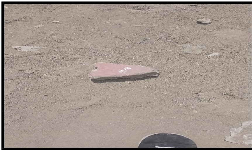
Ilustración 34: Levantamiento Topográfico-Punto de Cambio
