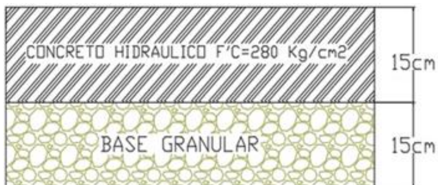
Ilustración 22: Resultados de Pavimentos Flexible Método AASHTO -93
