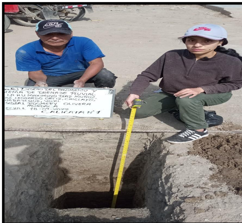
Ilustración 39: Exploración de Calicatas-C1
