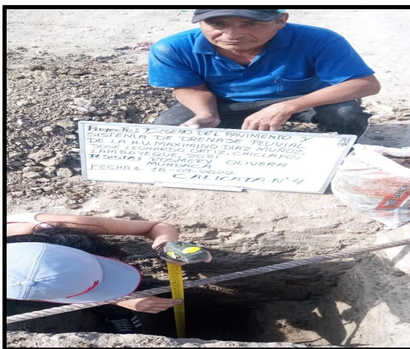
Ilustración 42: Exploración de Calicatas-C4
