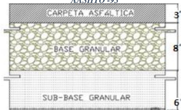
Ilustración 14: Resultados de Pavimentos Flexible Método AASHTO -93
