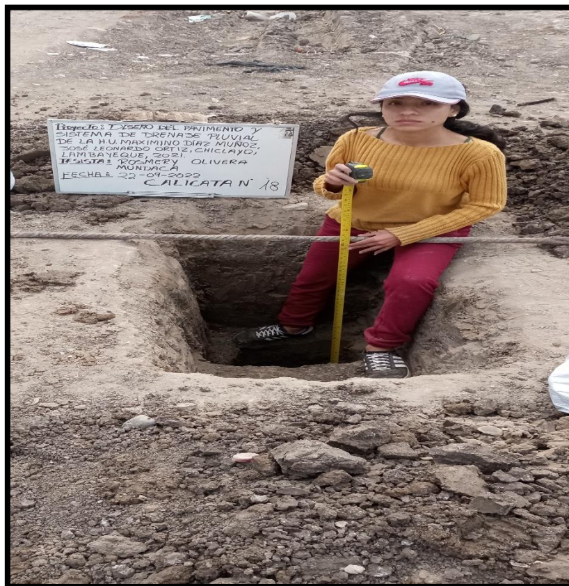
Ilustración 46: Exploración de Calicatas-C15
