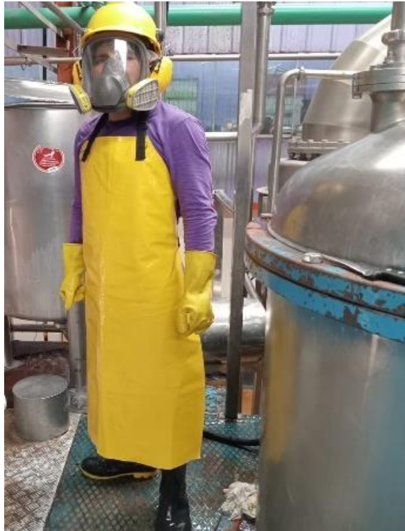
Uso correcto de EPPs durante la limpieza química de equipos
