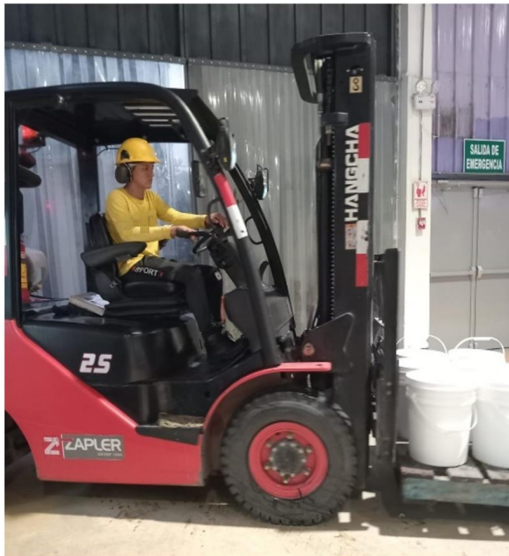
Personal operador de montacargas no utiliza el cinturón de seguridad
