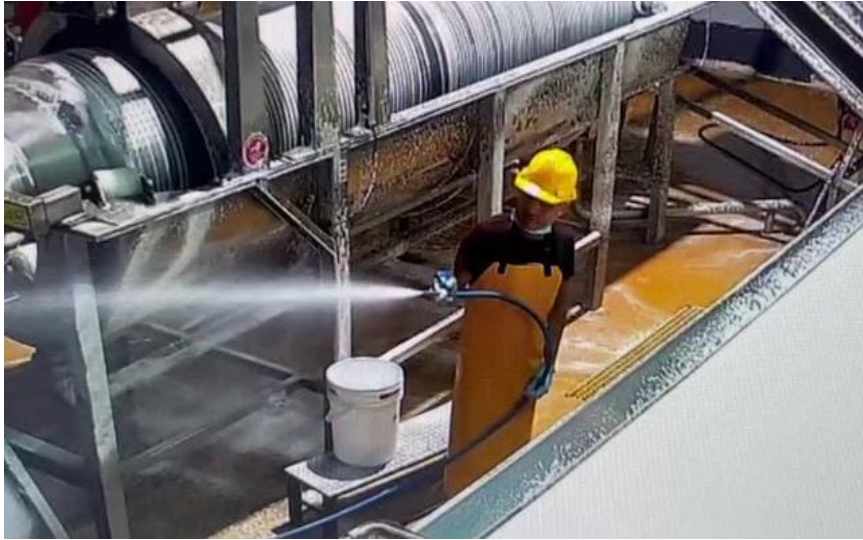
Personal auxiliar de planta realiza limpieza de equipos con agente químico: detergente Hypofoam, sin hacer uso de sus lentes de seguridad
