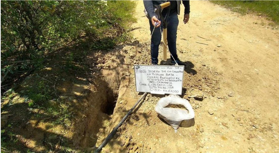
Fotografía 36: Panorama a cielo abierto de los estratos de la calicata N°02 – KM. 1+000
