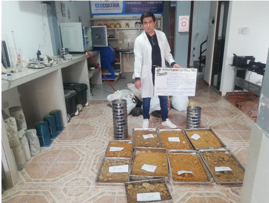
Fotografía 57: Vista de las muestras para Análisis Granulométrico
