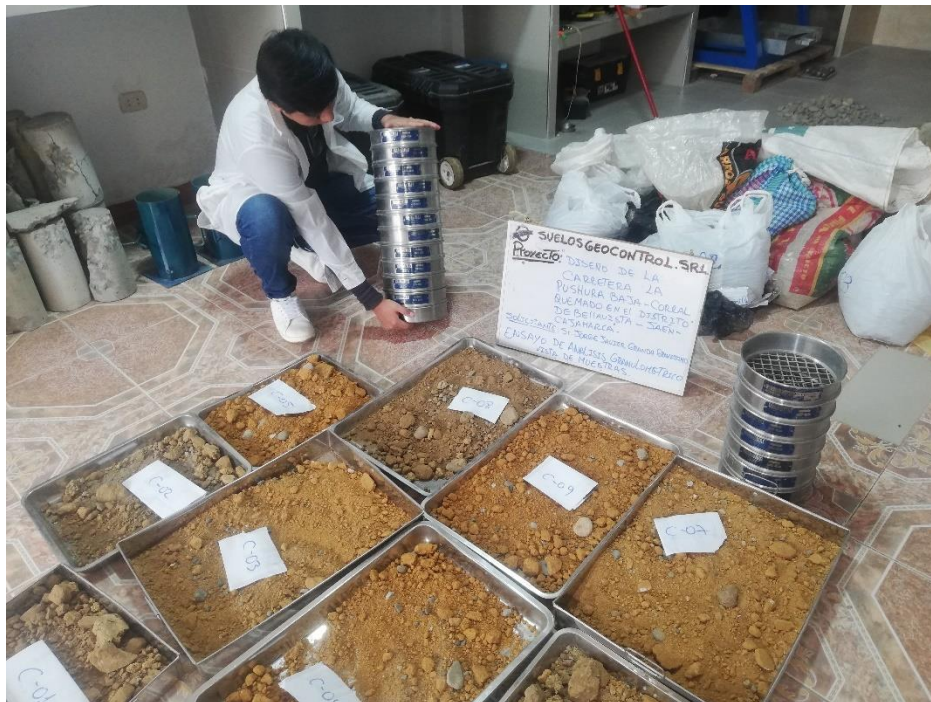
Fotografía 58: Tamizado de las muestras
