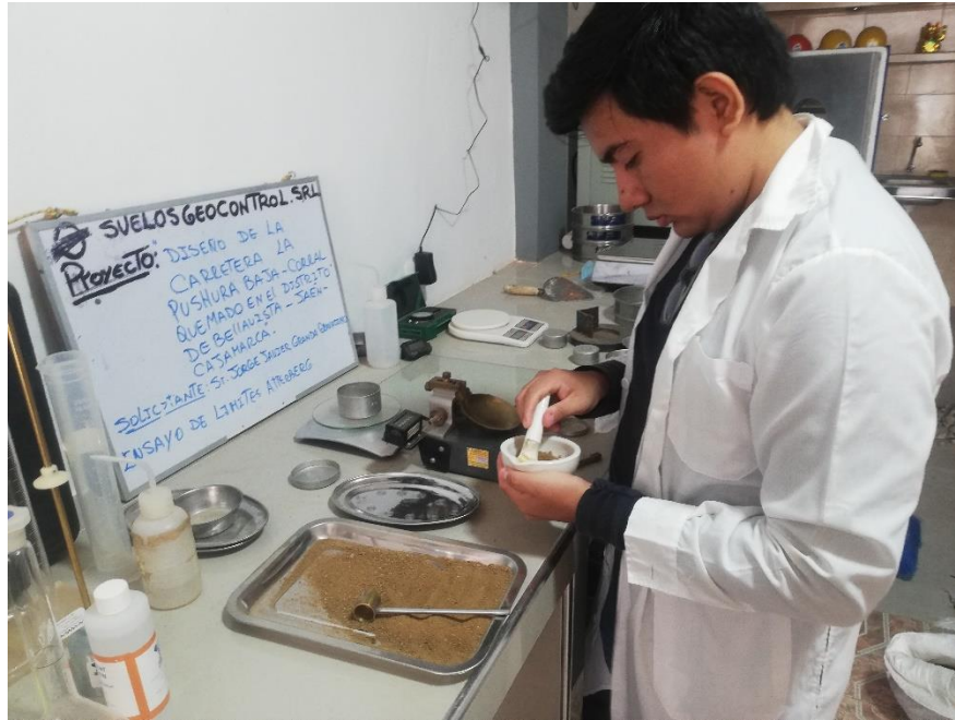
Fotografía 59: Ensayo de Límites de Atterberg
