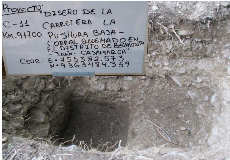
Fotografía 55: Panorama a cielo abierto de la calicata N°11 – KM. 9+700
