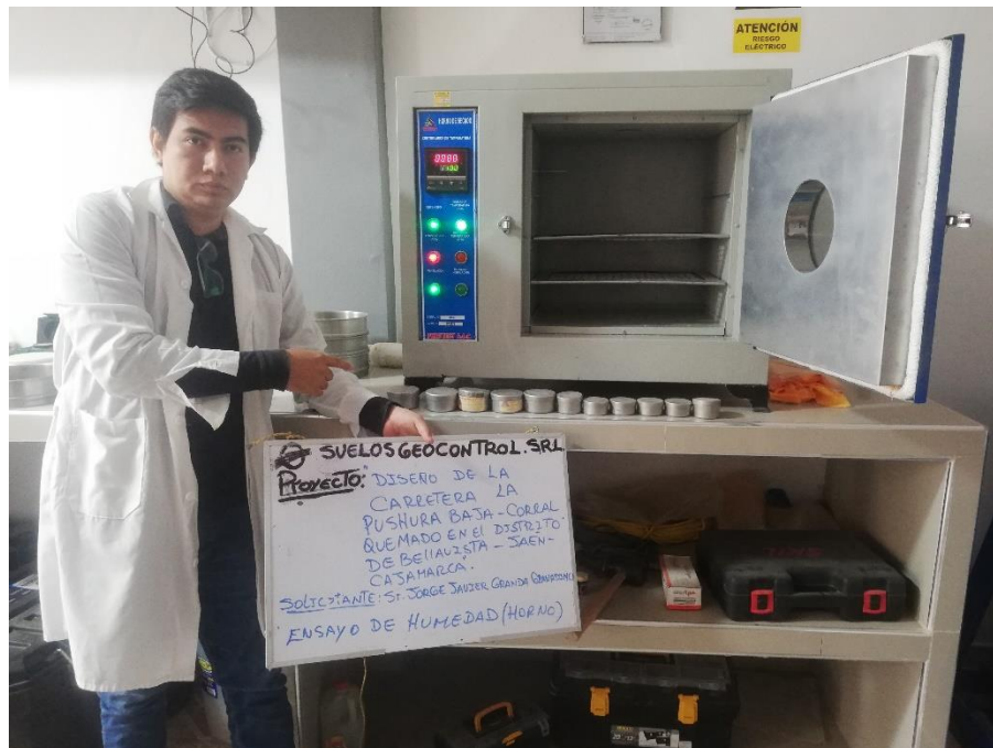
Fotografía 60: Ensayo de Humedad
