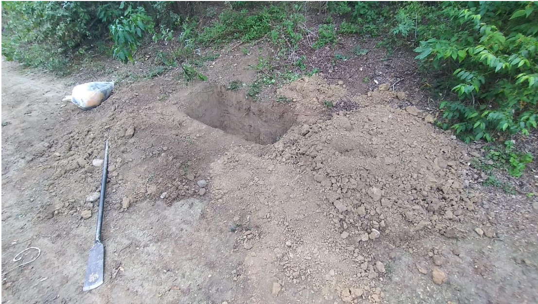
Fotografía 50: Panorama a cielo abierto de la calicata N°09 – KM. 8+000
