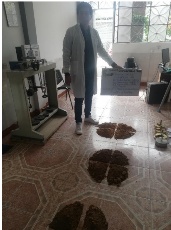
Fotografía 56: Cuarteo de la muestra
