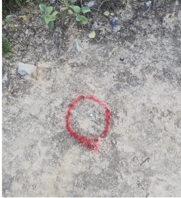
Fotografía 18: Punto de referencia para cambio de estación con ayuda de clavos para techo con cabeza de paraguas
