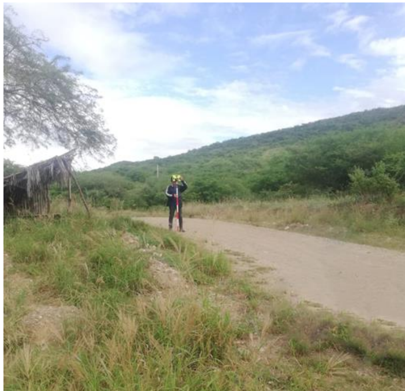
Fotografía 17: Nivelación del prisma para la toma de puntos
