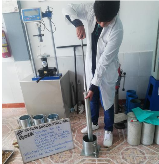
Fotografía 61: Ensayo de Proctor Modificado
