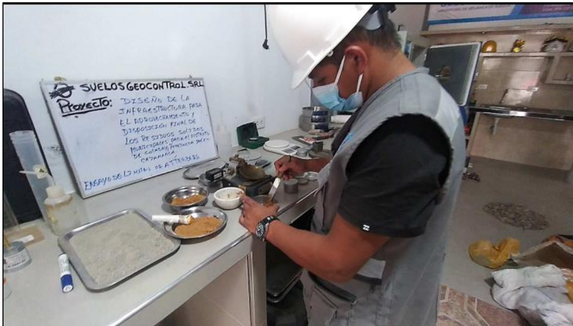
Foto 13. Ensayo de límites de Atterberg - Estudio de mecánica de suelos
