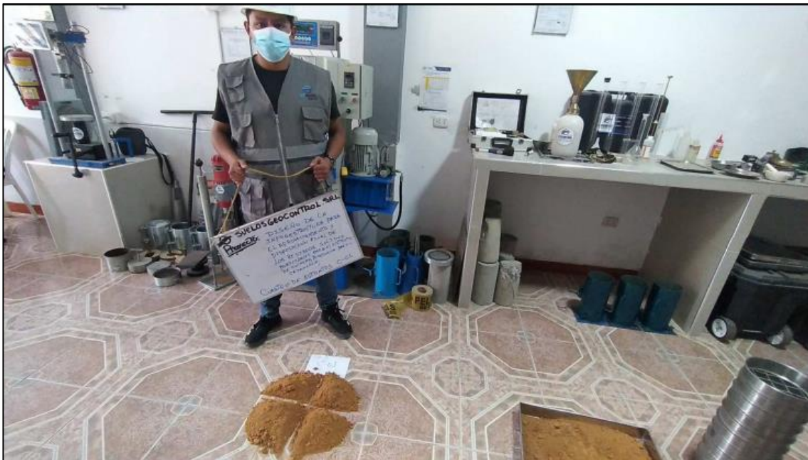
Foto 11. Cuarteo de estrato de Calicata N°1 - Estudio de mecánica de suelos
