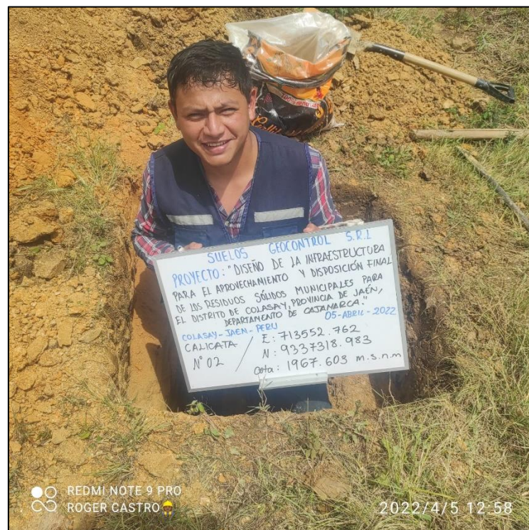
Foto 8. Calicata N°2 - Estudio de mecánica de suelos
