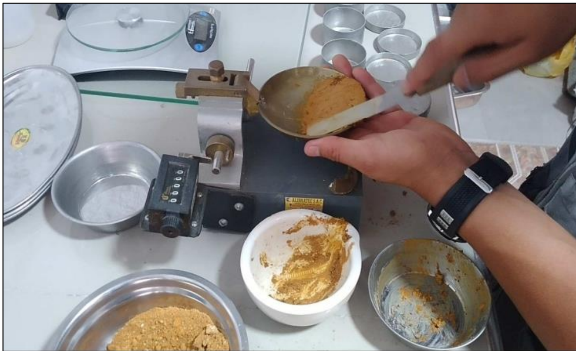
Foto 14. Ensayo de límites de Atterberg - Estudio de mecánica de suelos
