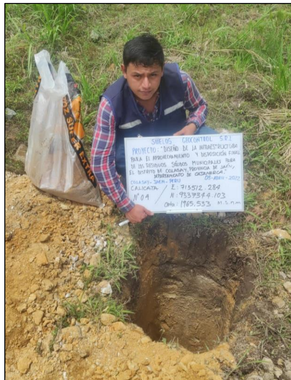
Foto 10. Calicata N°4 - Estudio de mecánica de suelos
