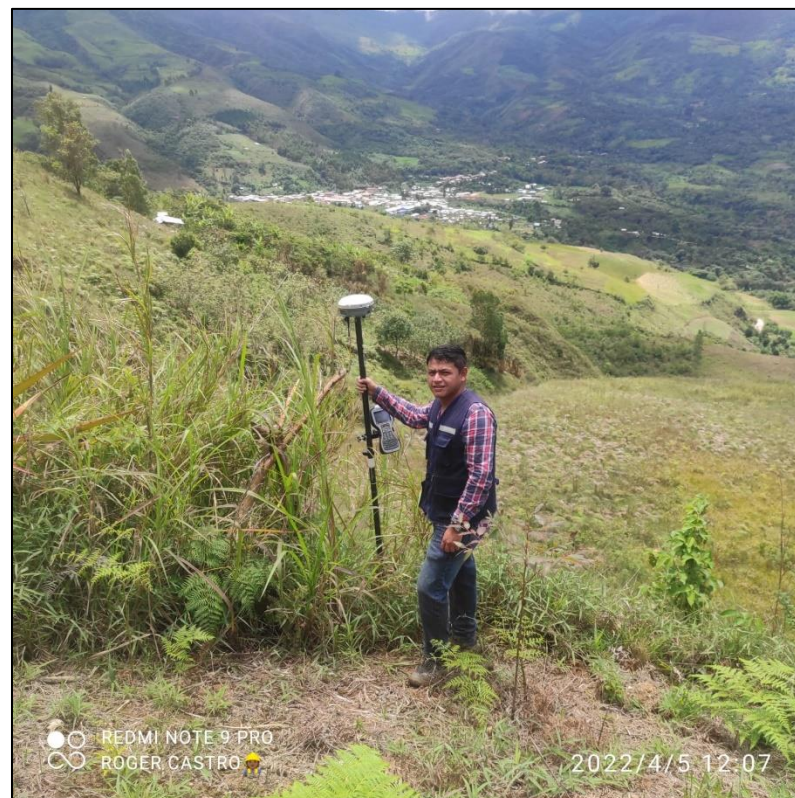
Foto 6. Lectura de punto perimetral - Estudio topográfico
