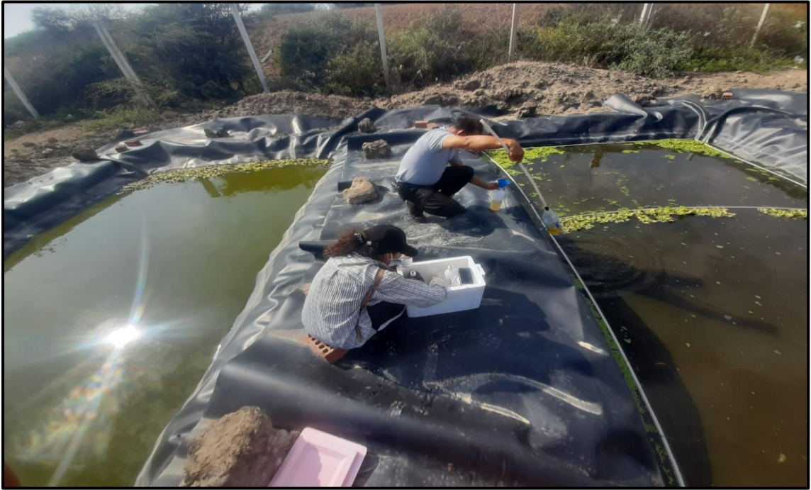
Fotografía 43: Coloración verde amarillento de las aguas residuales de los humedales artificiales a los 27 días de investigación.
