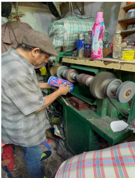
Fig. 15. Pulverización de EVA
