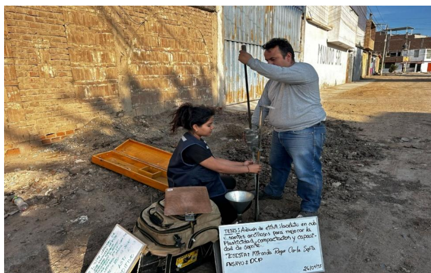
Fig. 61 Penetración del suelo
