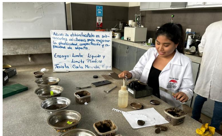
Fig. 28. Ejecución del ensayo haciendo uso de copa de casa grande
