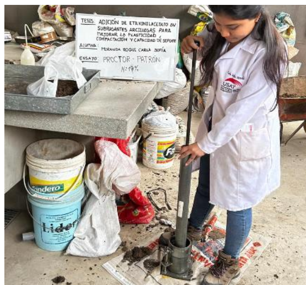
Fig. 48. Compactación muestra patrón
