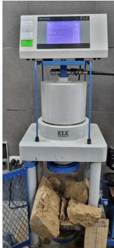
Figura N° 37. Muestra sometida al ensayo de Tracción
