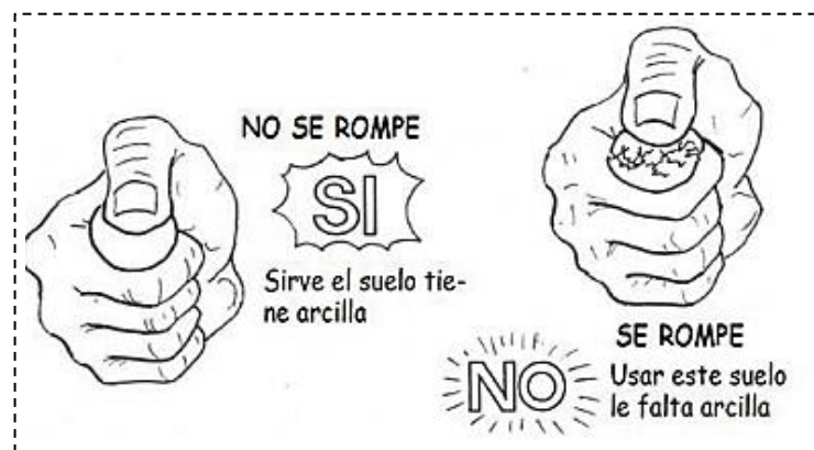
Figura N° 8. Prueba de Presencia de Arcilla
