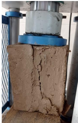
Figura 39. Muestra del Mortero sometida al ensayo de tracción
