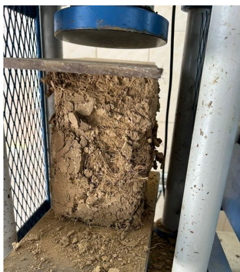
Figura N° 40, Muestra sometida al ensayo de compresión
