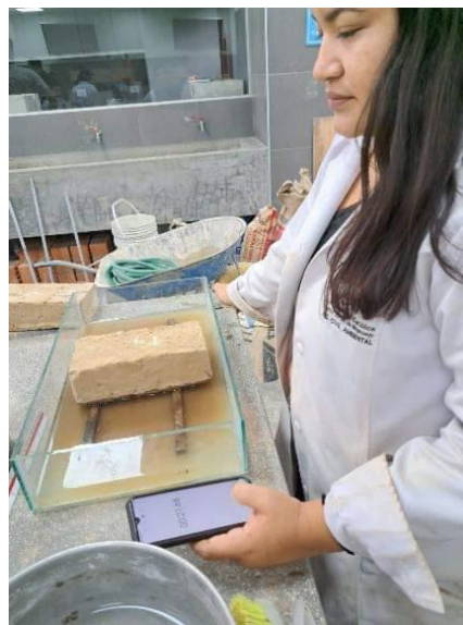
Figura N° 38. Muestra sometida al ensayo de Succión.
