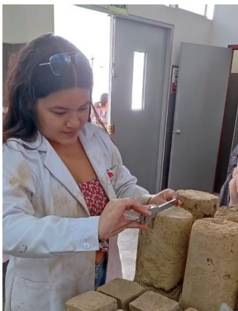
Figura N°36. Toma de datos para el ensayo de tracción
