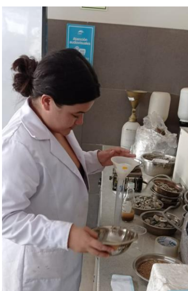
Figura N° 22. Ensayo de Contenido de Sales en el suelo
