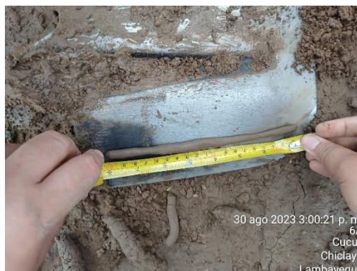
Figura N° 15. Prueba de Rollo
