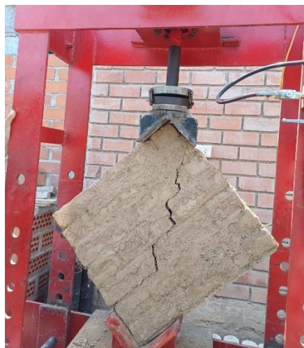
Figura N°41, Muestra de Murete sometidos al ensayo de tracción
