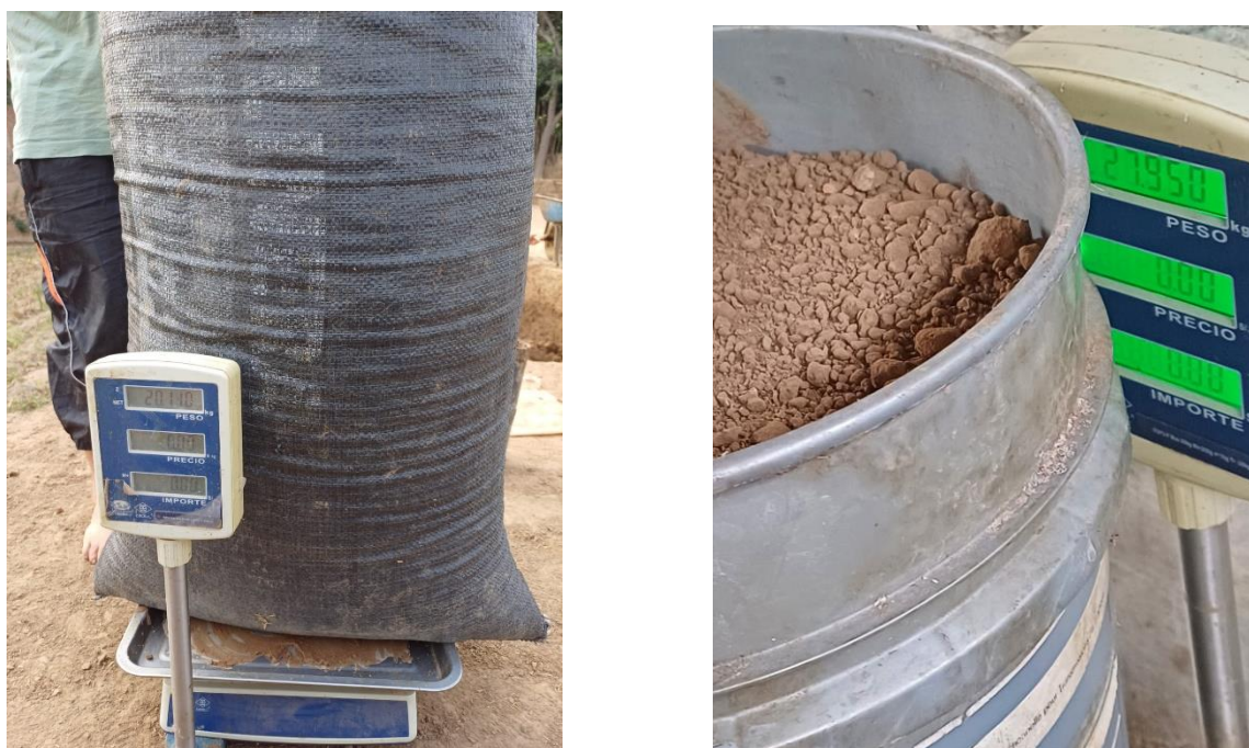
Figura N° 30. Pesado del material para sacar la correcta dosificación
