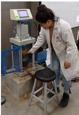
Figura N° 35. Muestra sometida al ensayo de compresión
