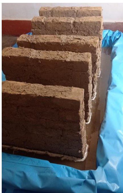
Figura 42. Muestras sometidas al ensayo de inundación
