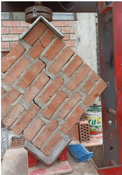
Ilustración 96: Falla escalonada en muretes en 08% de viruta
