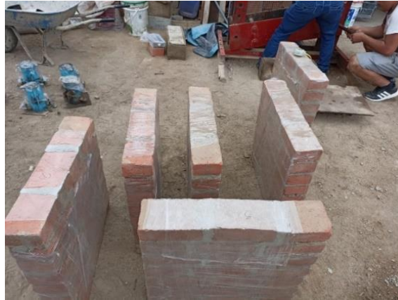
Ilustración 87: Murete embalados y llevados al laboratorio
