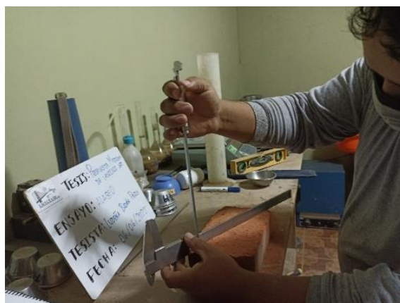
Ilustración 70: Medición de alabeo en los ladrillos
