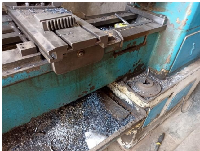
Ilustración 17: Residuos de Corte de Acero en tornos
