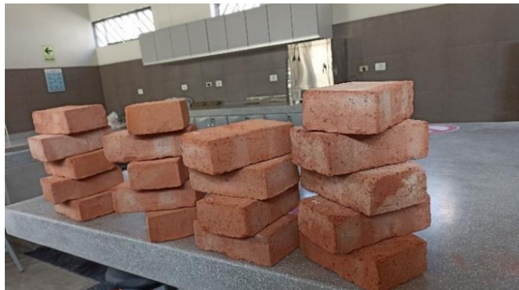
Ilustración 72: Ladrillos codificados para ser usados en ensayo de compresión
