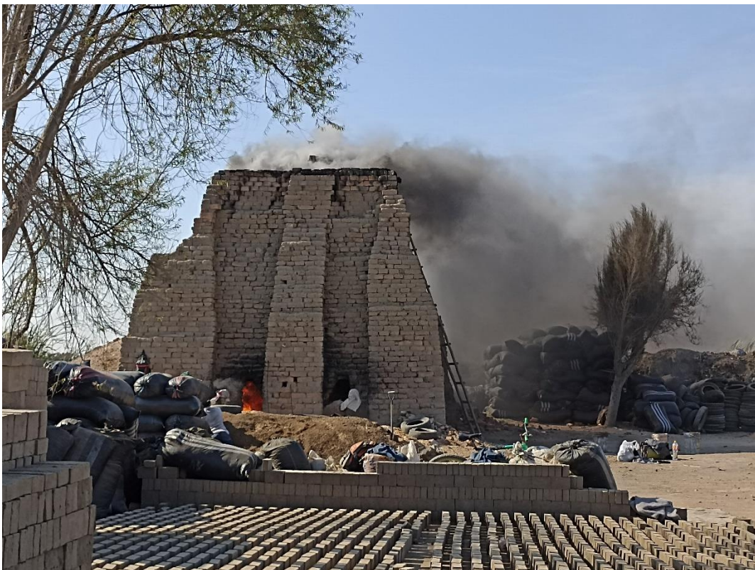
Ilustración 91: Quemado en Ladrillera Artesanal zona PP.JJ Las Vegas
