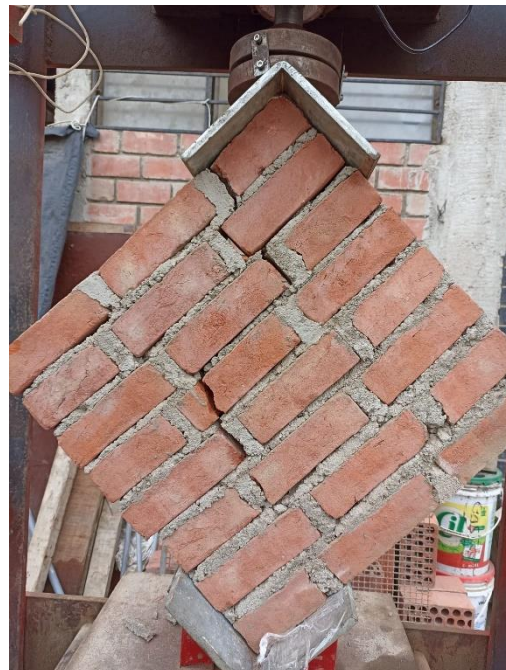
Ilustración 96: Falla escalonada en muretes en 08% de viruta
