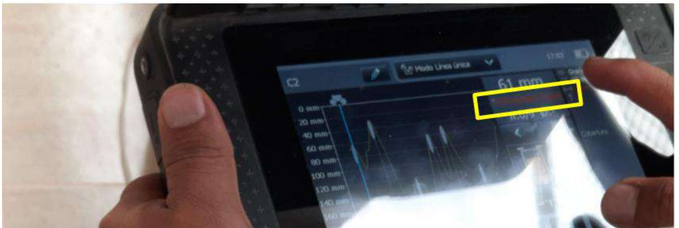
Imagen 28: El equipo verifica que una de las varillas esta lejana lo cual no identifica el diámetro del acero columna EJE F 1-
