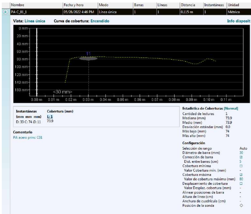
Imagen 58: Resultados de la columna Eje A-1 diámetro de acero longitudinal - Pabellón A-A
