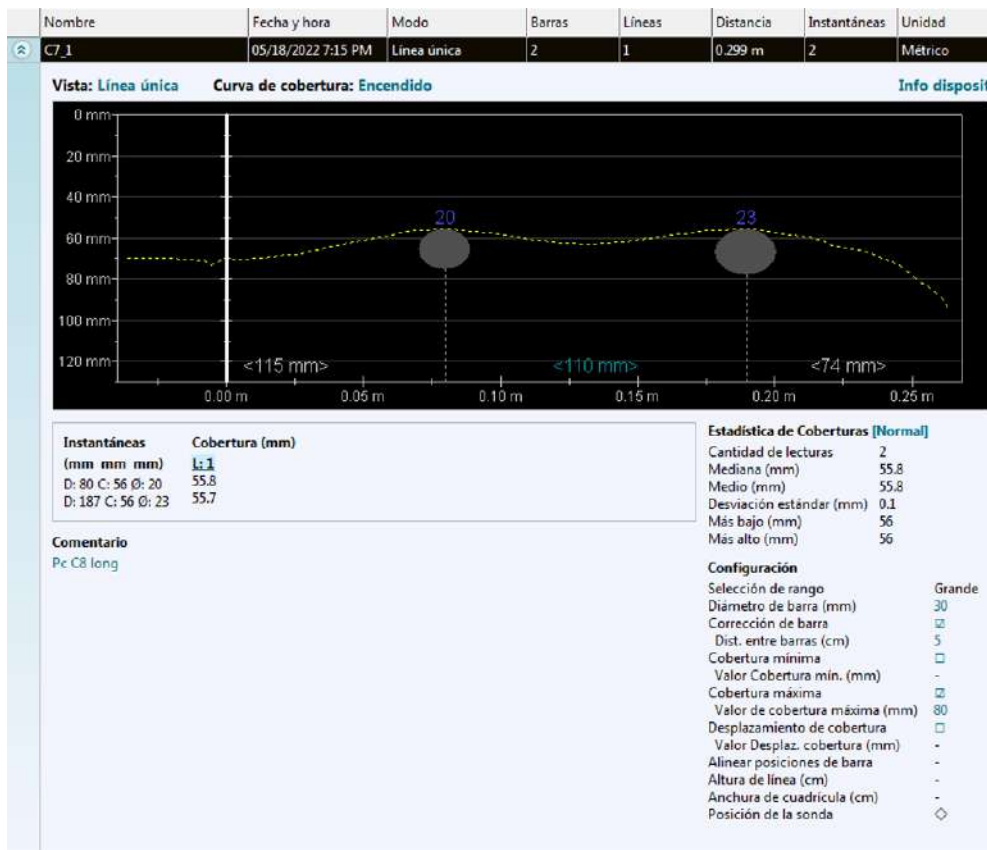
Imagen 68: Resultado de la columna Eje K-8 diámetro de acero longitudinal - Pabellón C-C
