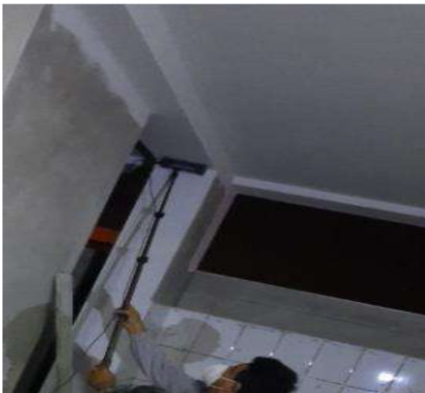
Imagen 50: Escaneo del diámetro del estribo de la viga EJE L
