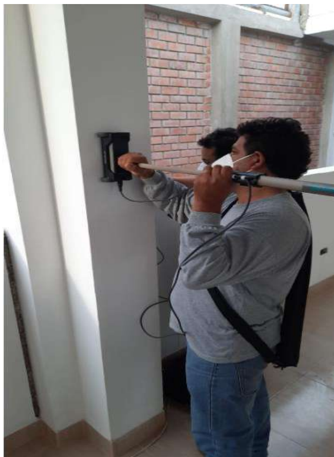
Imagen 30: Escaneo del diámetro del acero longitudinal de la columna EJE F 1-
