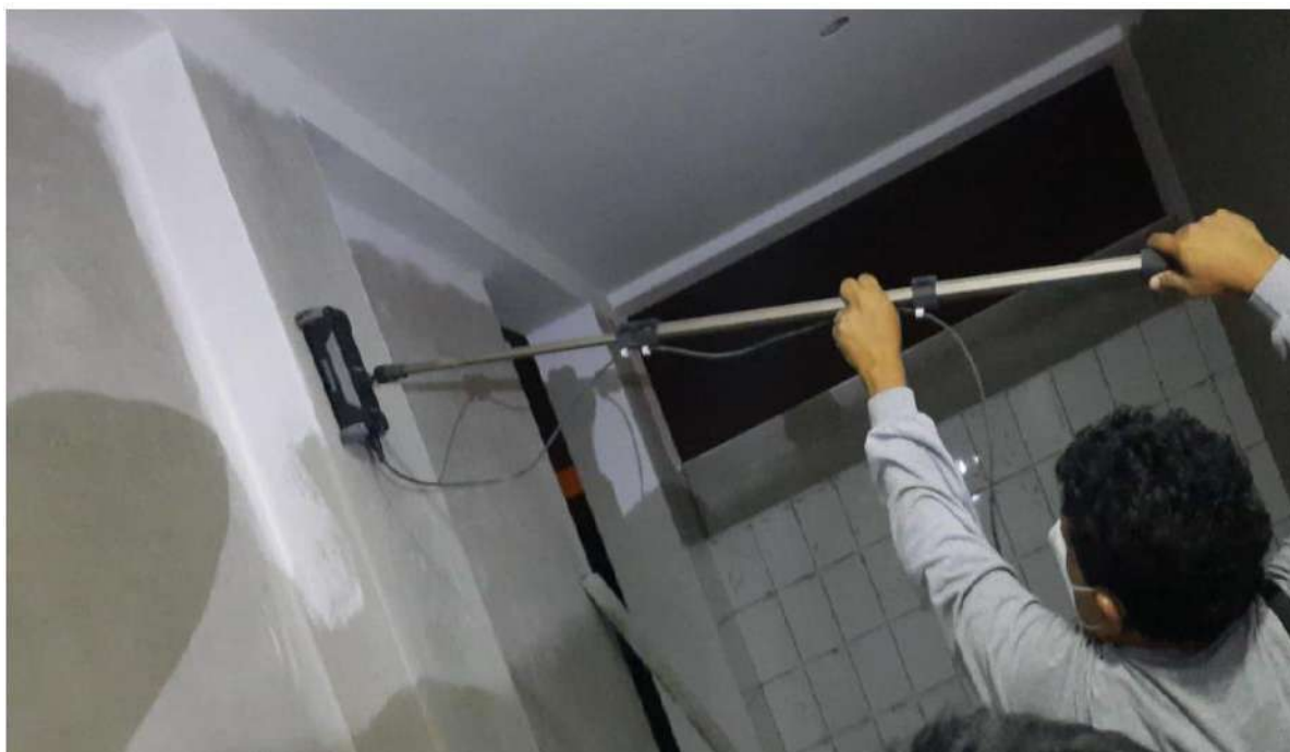
Imagen 47: Escaneo del diámetro del acero longitudinal de la columna EJE L 9
