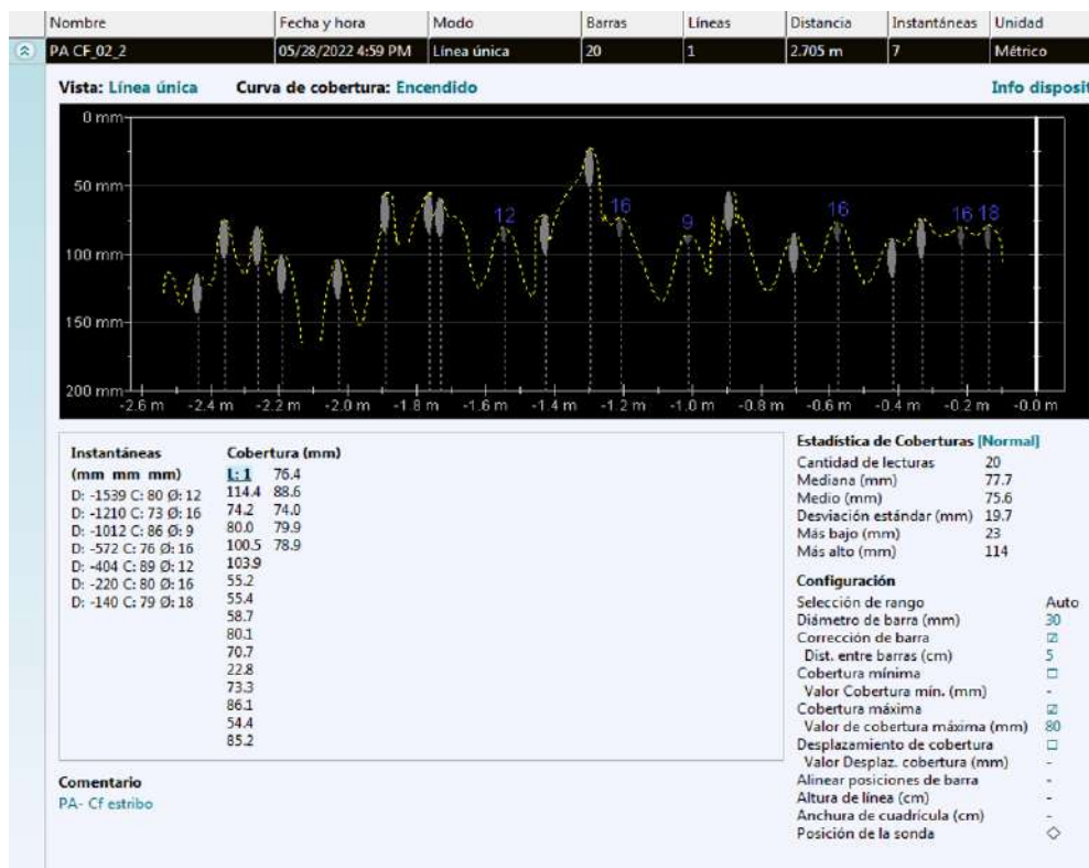
Imagen 55: Resultados de la columna Eje F-1 diámetro de estribo - Pabellón A-A
