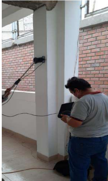
Imagen 27: Escaneo del diámetro del estribo de la columna EJE F 1-
