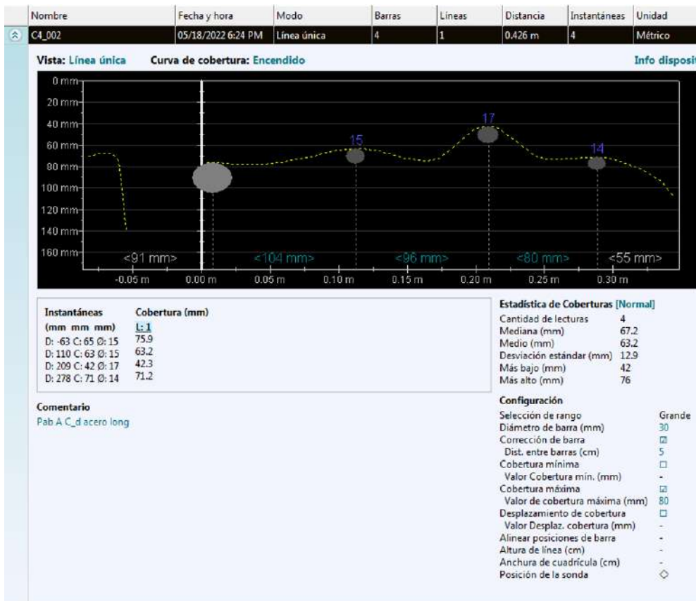
Imagen 56: Resultados de la columna Eje D-2 diámetro de acero longitudinal - Pabellón A-A
