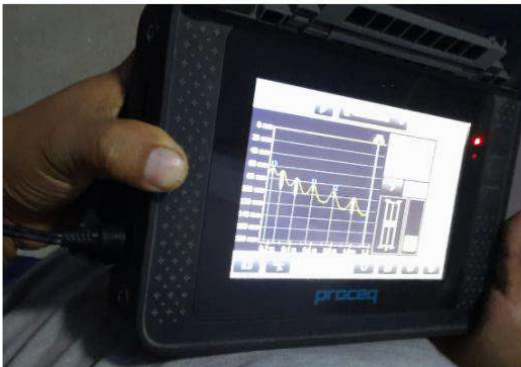
Imagen 48: Realizando escaneos para el estribo de la columna EJE L 9
