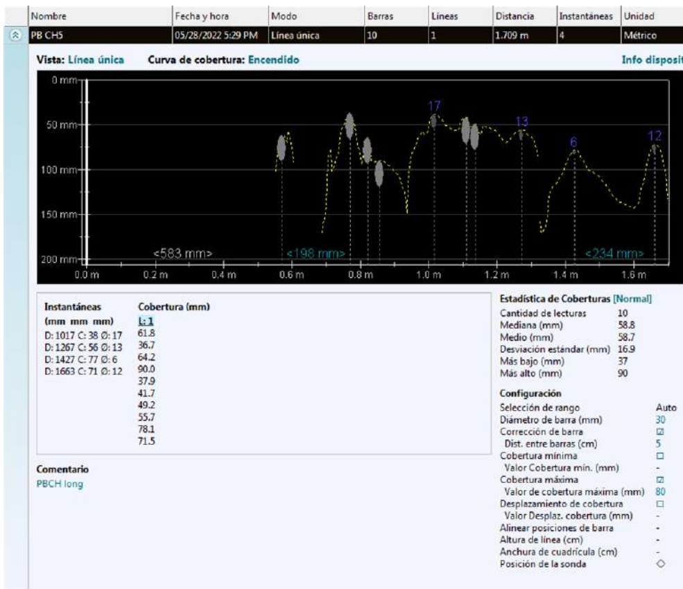
Imagen 64: Resultado de la columna Eje 1-J diámetro de acero longitudinal - Pabellón B-B
