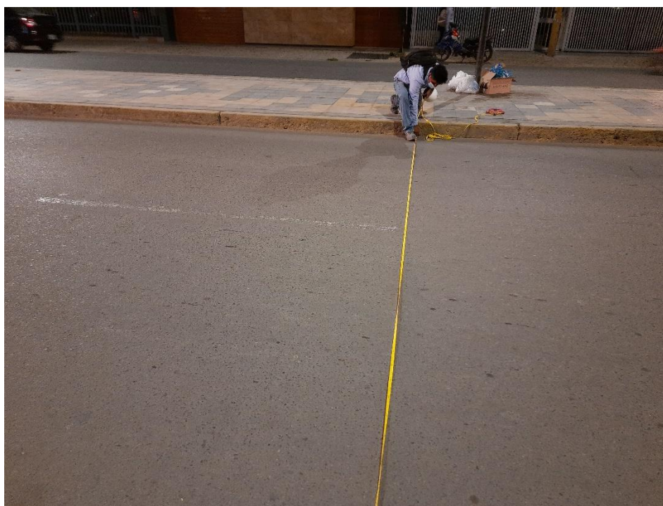
Fig. 20. Medición de anchos de vías haciendo uso de wincha métrica
