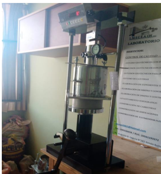
Foto 32: Penetración de CBR al 95%
