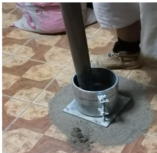
Foto 39: compactando los golpes
