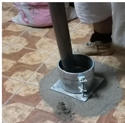
Foto 39: compactando los golpes
