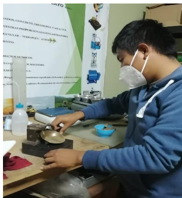
Figura 12: Girando la copa para el Limite Liquido.
