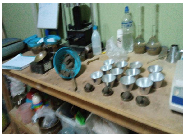
Foto 60: Dosificaciones del cloruro de sodio
