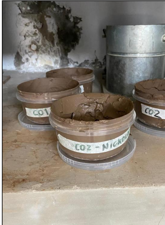
Preparación de Límites de Consistencia C-01
