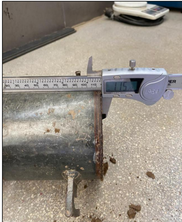
Medida del molde de Proctor Modificado
