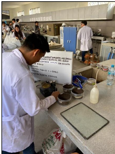
Fig. 24. Evaluación de los límites de consistencia líquida.
