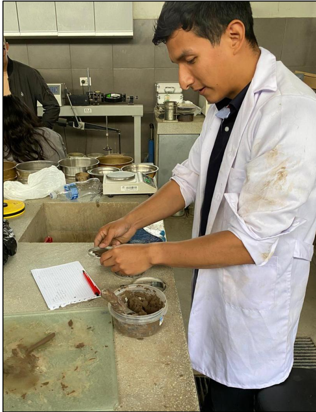
Preparación de Límites de Consistencia C-02
