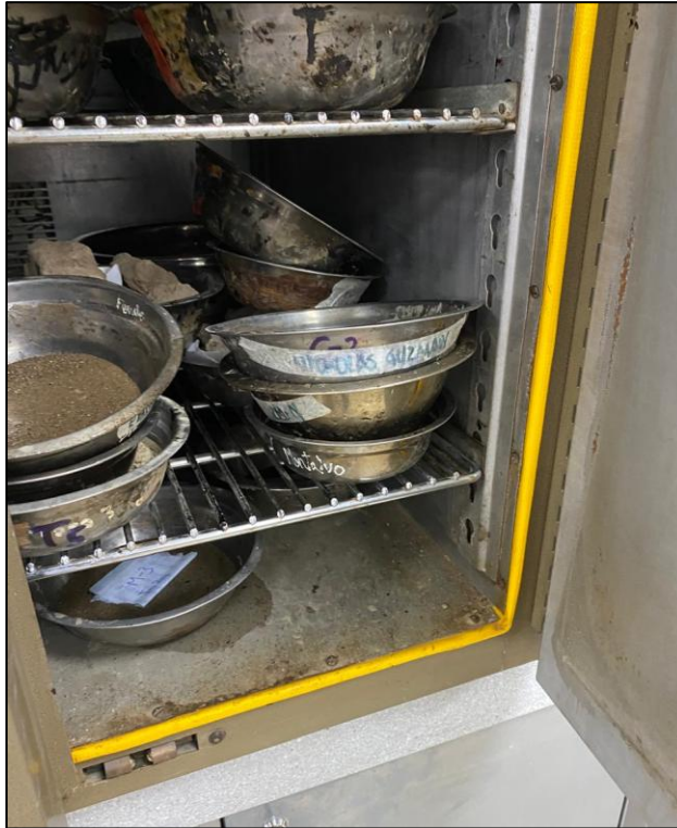
Secado en horno de las muestras naturales
