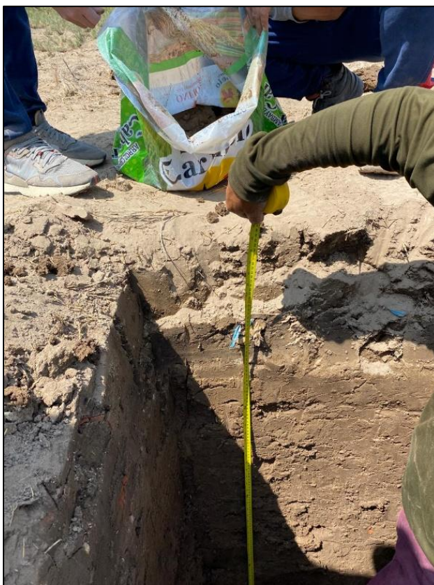
Obtención de Muestras en estado Natural C-02
