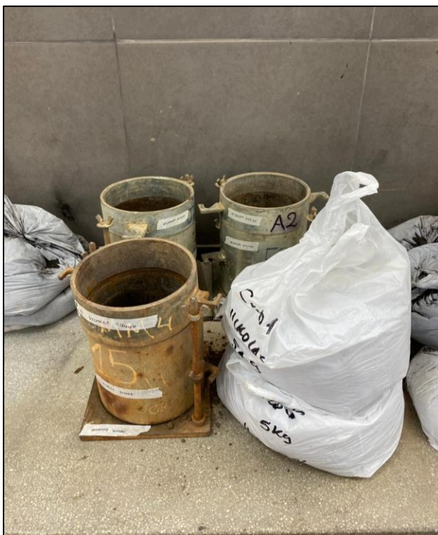
Molde y Muestras naturales para el ensayo de CBR
