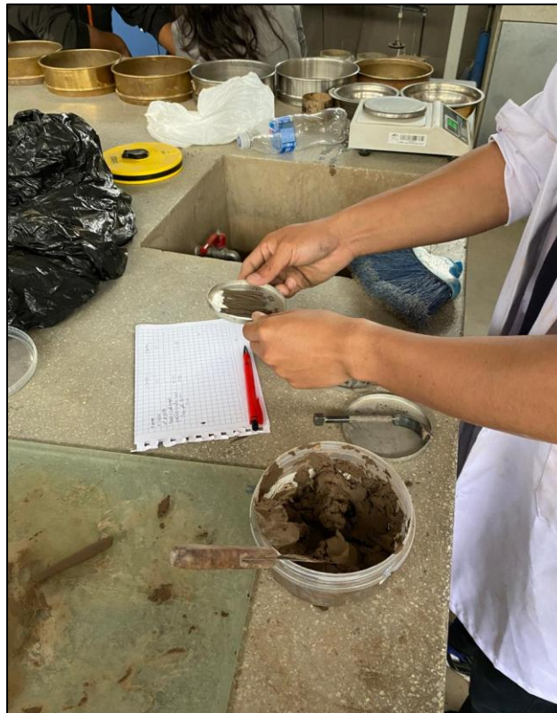
Preparación de Límites de Consistencia C-01
