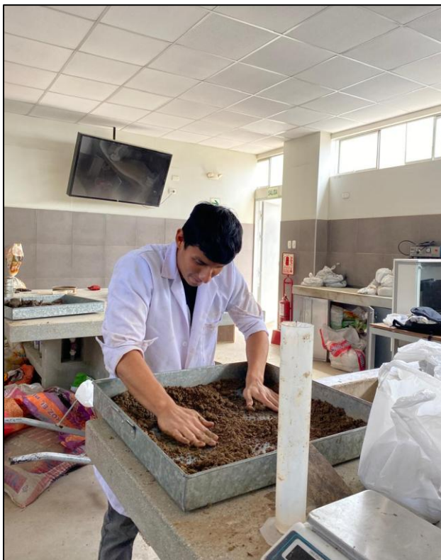
Saturación de la muestra para el ensayo CBR
