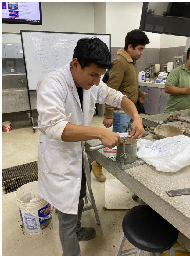
Preparación de molde para el ensayo de Proctor Modificado
