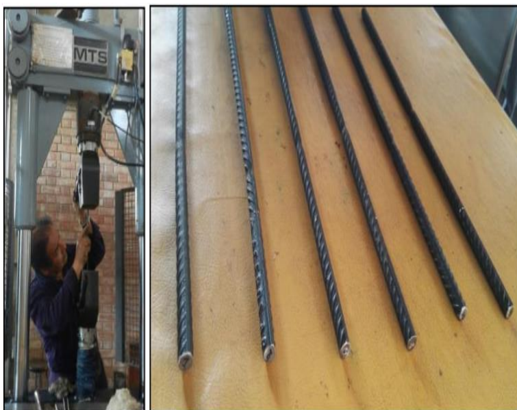
Figura 5: Colocación de espécimen en las mordazas de la Máquina Universal. Especímenes ensayados de muestras 3/8"
