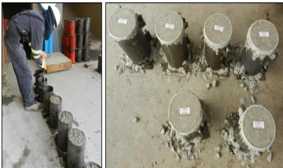
Figura 8: Elaboración de probetas de concreto
