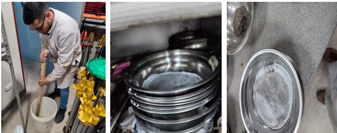
Ilustración 40: Ensayo de la durabilidad al sulfato de magnesio del agregado fino
