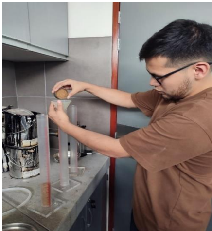
Ilustración 35: Ensayo de equivalente de arena
