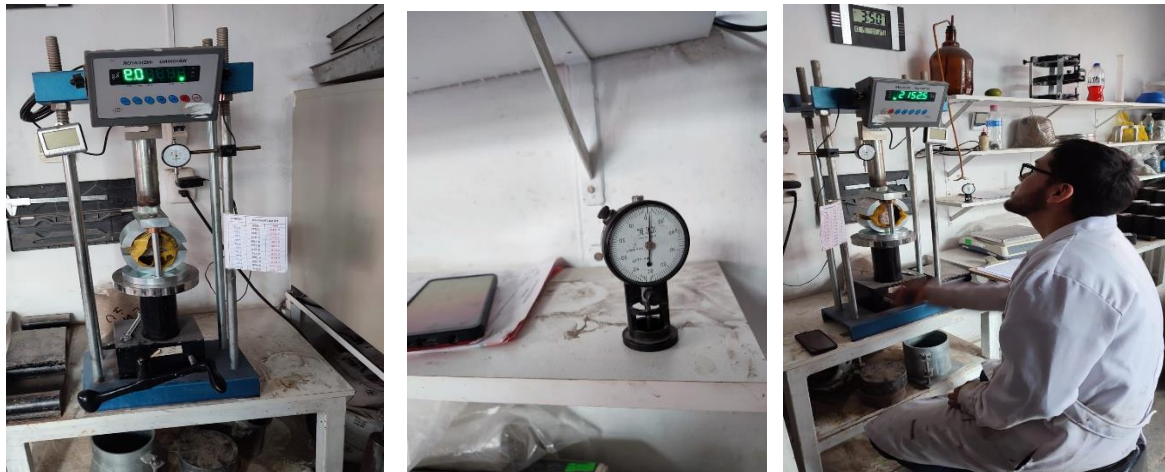
Ilustración 63: Ensayo de Estabilidad y Flujo de las briquetas.
