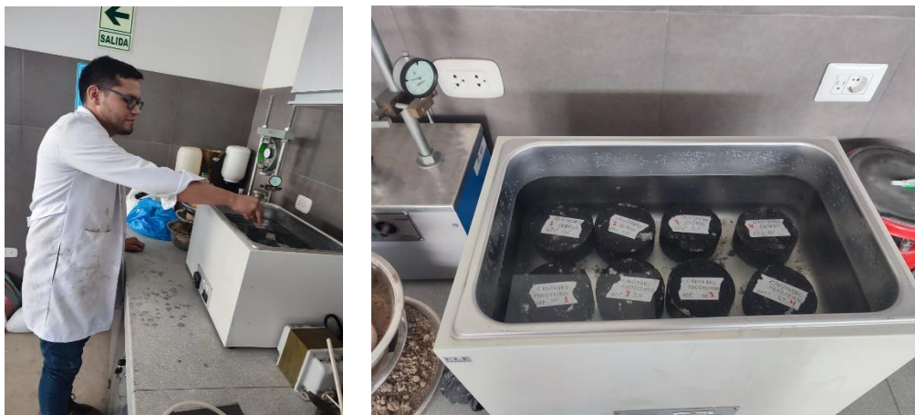
Ilustración 67: Briqueetas a 60 °C para el ensayo de Cántabro
