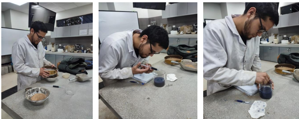
Ilustración 39: Ensayo del azul de metileno del agregado fino
