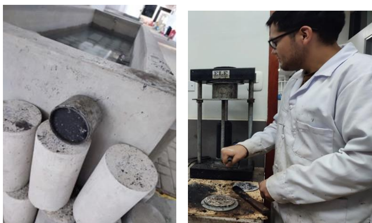
Ilustración 58: Enfriar y desmoldar la briqueta
