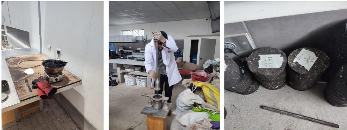
Ilustración 70: Proceso de mezclado y compactado de las briquetas
