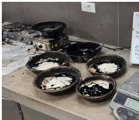
Ilustración 56: Proceso de calentado de la mezcla al 2% de filler.
