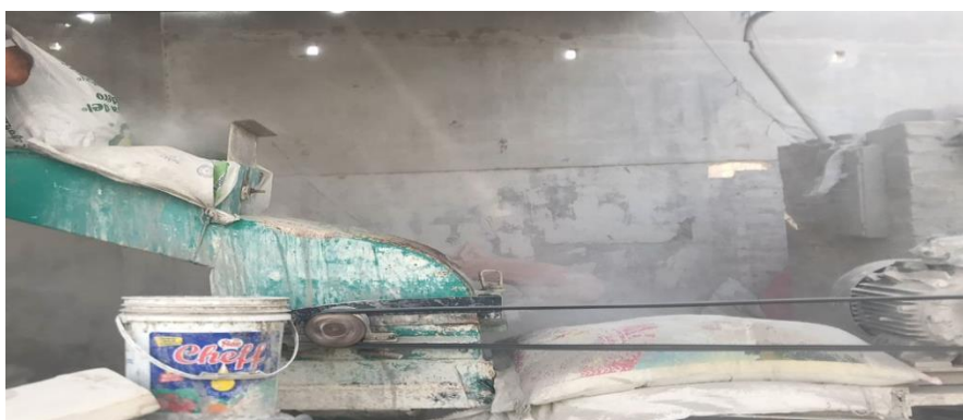
Ilustración 26: Trituración de las conchas de abanico
