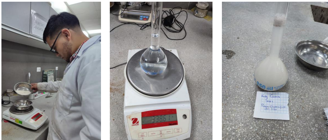
Ilustración 42: Ensayo del peso específico del relleno mineral
