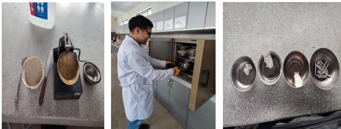
Ilustración 41: Ensayo del índice de plasticidad (malla n°200) del filler
