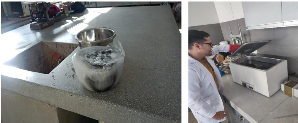
Ilustración 72: Briquetas a -18 °C y a 60 °C
