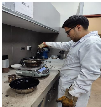
Ilustración 55: Peso del filler (conchas de abanico) al 2%.
