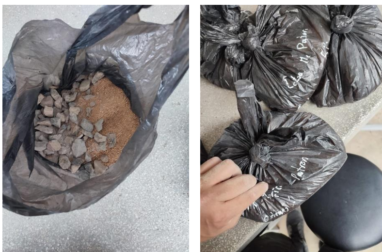
Ilustración 69: Pesado del agregado para el ensayo Lottman Modificado
