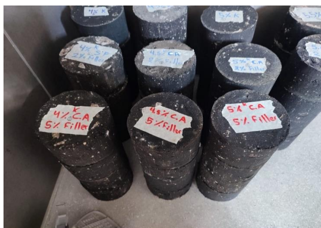
Ilustración 60: Briquetas de conchas de abanico como filler al 5%
