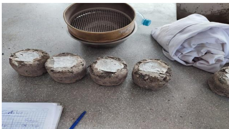
Ilustración 66: Briquetas después del ensayo de Cántabro a 25 °C
