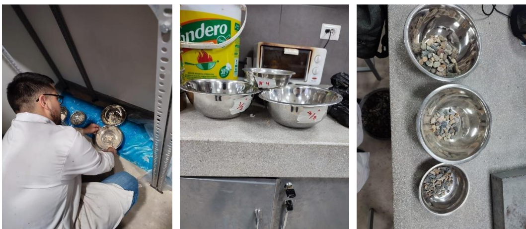
Ilustración 31: Ensayo de la durabilidad al sulfato de magnesio del agregado grueso
