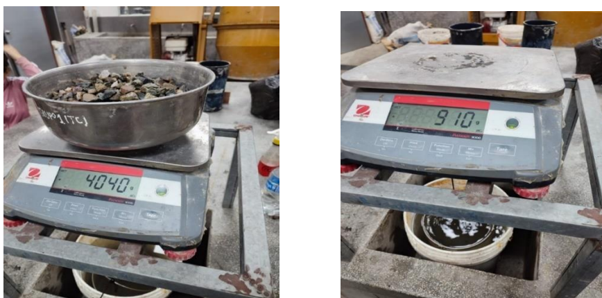
Ilustración 30: Ensayo de la gravedad específica y absorción del agregado grueso
