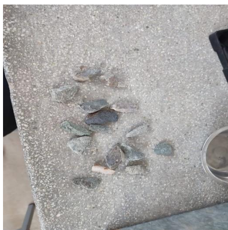
Ilustración 33: Ensayo de porcentaje de caras fracturadas del agregado grueso
