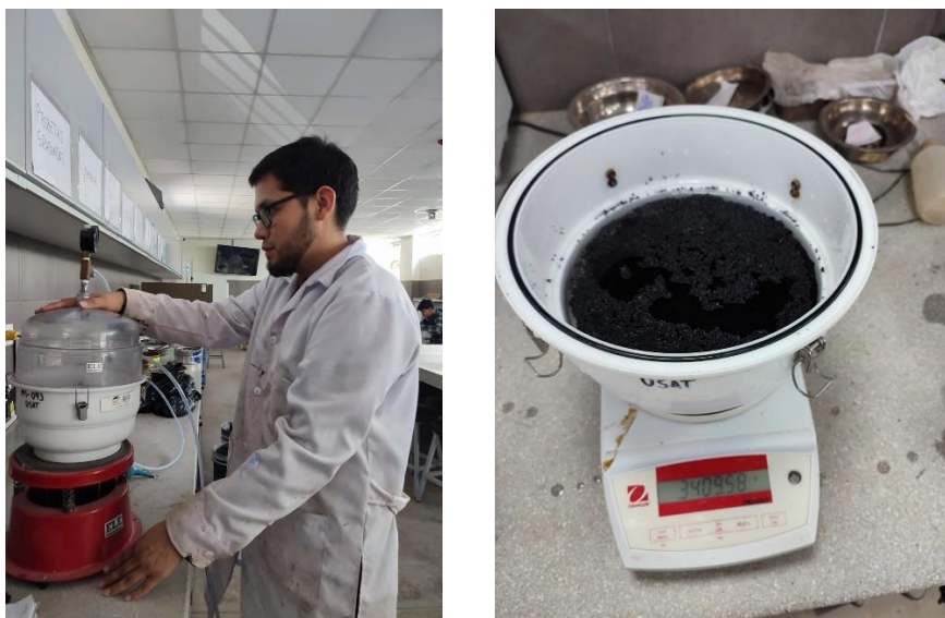
Ilustración 64: Ensayo de la densidad máxima teórica de mezcla sin compactar.
