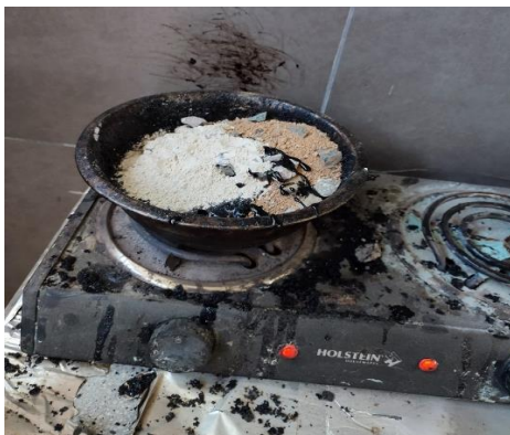
Ilustración 56: Proceso de calentado de la mezcla al 2% de filler.
