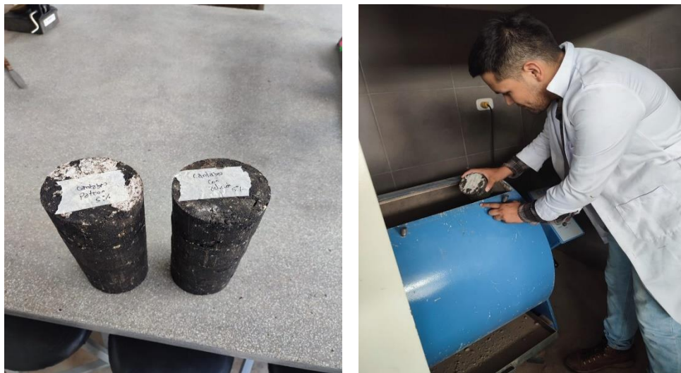
Ilustración 65: Briquetas para el Ensayo de Cántabro
