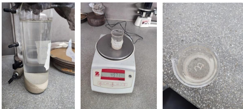
Ilustración 43: Ensayo del contenido de sales solubles del filler
