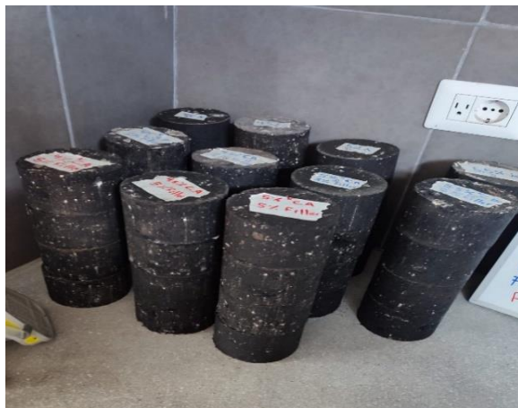
Ilustración 61: Briquetas de conchas de abanico como filler al 8%
