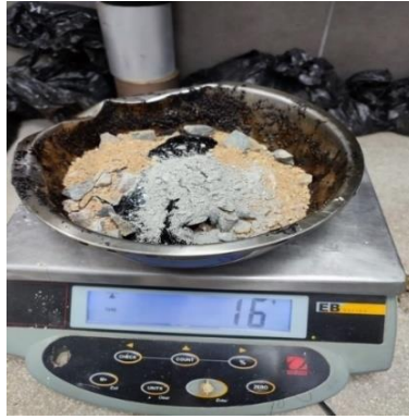
Ilustración 46: Peso del filler (cemento) al 1%
