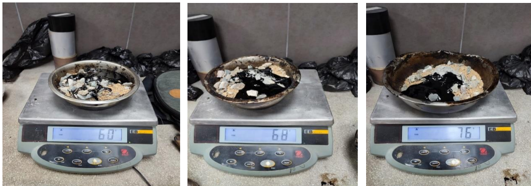
Ilustración 47: Peso del cemento asfáltico
