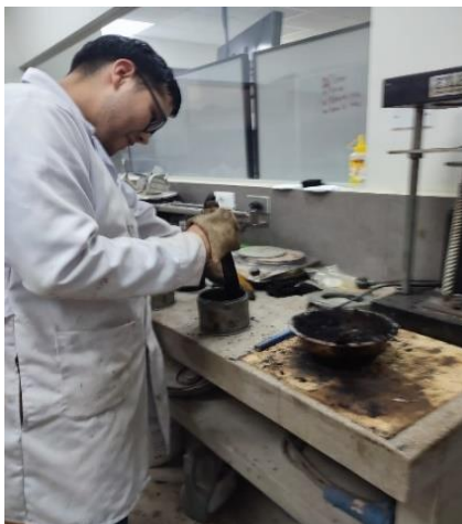
Ilustración 50: Mezclado dentro del molde
