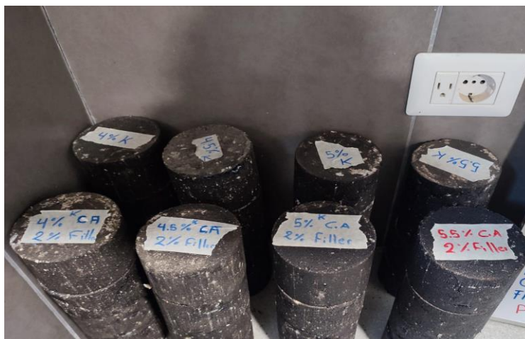
Ilustración 59: Briquetas de conchas de abanico como filler al 2%
