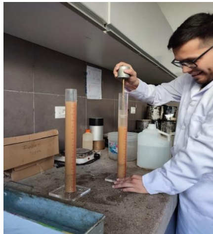
Ilustración 35: Ensayo de equivalente de arena
