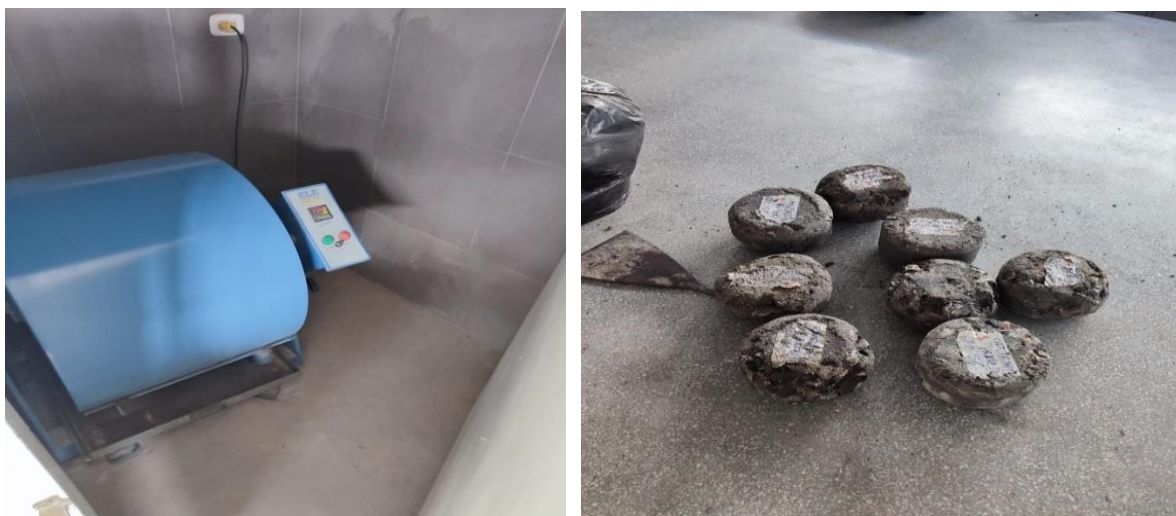
Ilustración 68: Briqueetas después del ensayo de Cántabro a 60 °C
