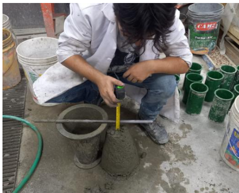
Ilustración 11 Ensayo asentamiento del concreto fresco
