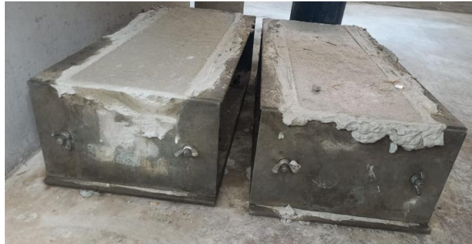
Ilustración 13 Elaboración de vigas para el ensayo de r. flexión
