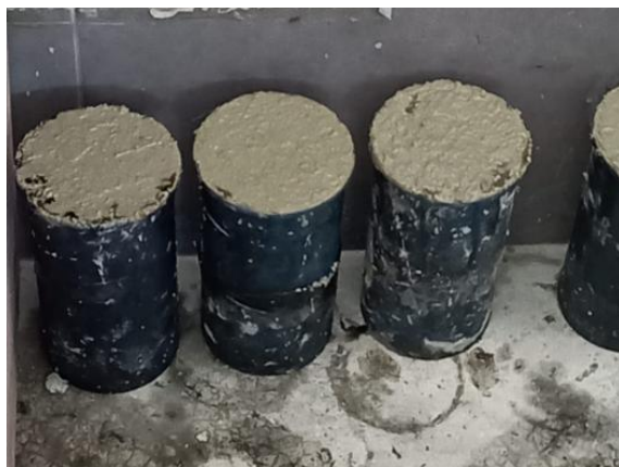
Ilustración 12 Elaboración de testigos para ensayo de r. compresión y r. abrasión
