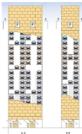
Figura 5: Estacionamiento Paletizado doble y simple
