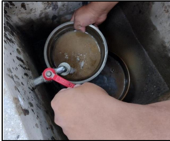
Foto 1: lavado de agregado fino
