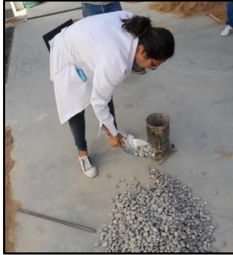
Foto 7: Peso unitario suelto agregado grueso
