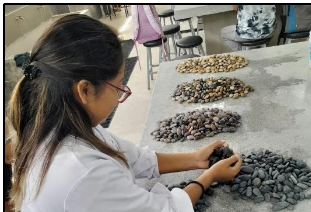
Foto 6: secado de forma natural del canto rodado
