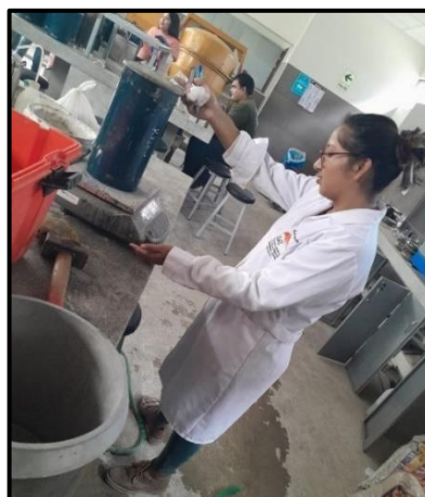
Imagen 21: peso unitario del concreto fresco Fuente: Propia
