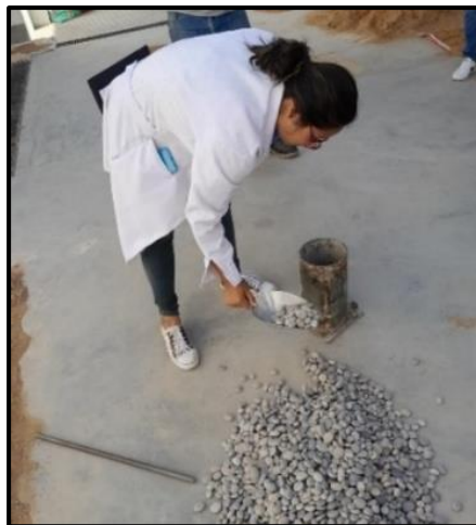
Imagen 17: llenado de molde para el peso volumétrico suelto
