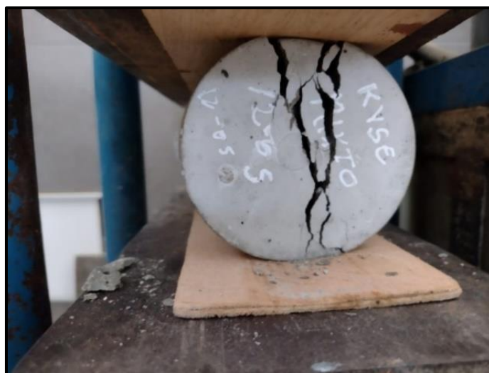
Foto 15: compresión de testigos
