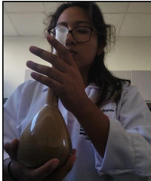
Foto 5: eliminar burbujas de aire en el agregado
