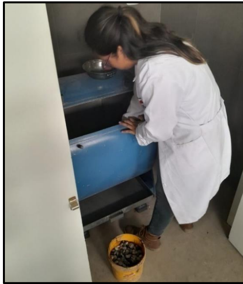
Foto 8: Maquina de los ángeles para el ensayo de abrasión de canto rodado
