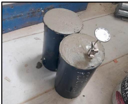
Imagen 23: temperatura del concreto Fuente: Propia
