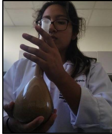
Imagen 15: agitado de fiola para el peso específico y grado de absorción del agregado fino Fuente: Propia
