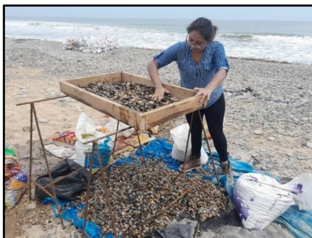
Imagen 7: Tamizado por la mala 1" agregado seleccionado Fuente: Propia
