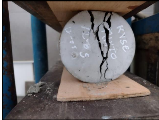
Imagen 26: Resistencia a la tracción de testigos Fuente: Propia
