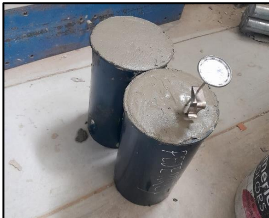
Foto 12: Control de temperatura
