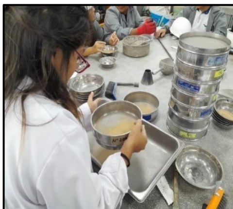
Imagen 12: Agregado fino, tamizado Fuente: Propia
