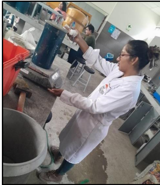
Foto 10: Peso del molde+ concreto
