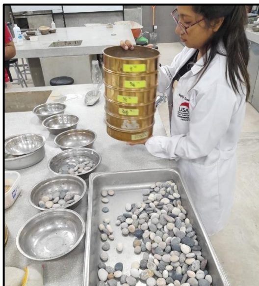
Imagen 13: Agregado Grueso, Tamizado Fuente: Propia
