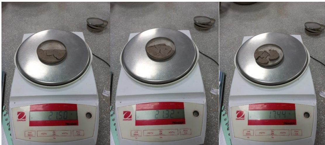
Figura 31. Registro de pesos para límite líquido - muestra seca + tara (w)
