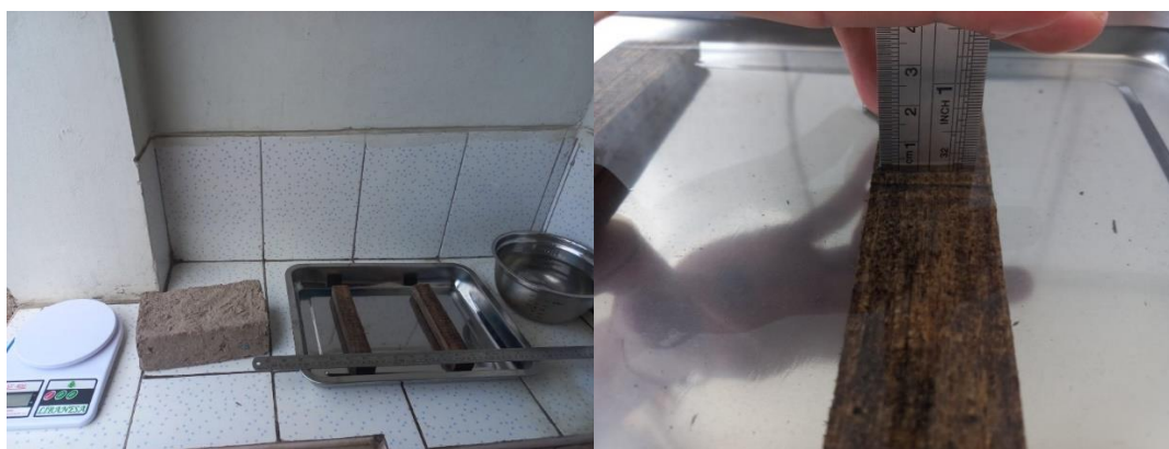
Figura 65. Materiales para el ensayo de succión + 3mm de alto de agua
