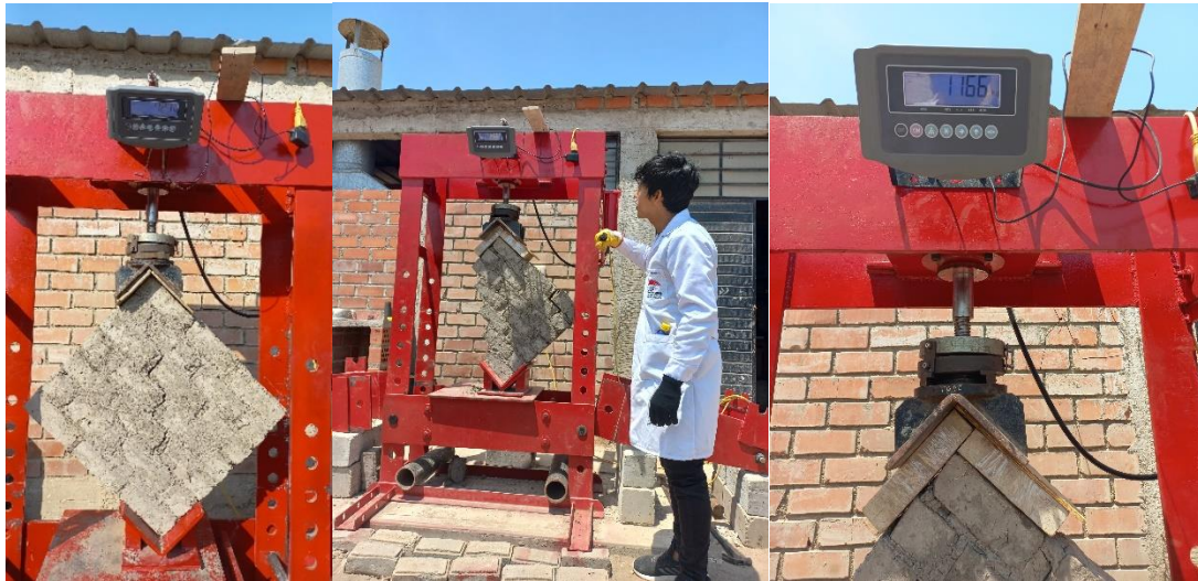
Figura 75. Registro de las cargas en la ruptura de los muretes
