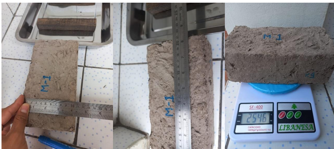
Figura 66. Toma de medidas y pesos de los adobes
