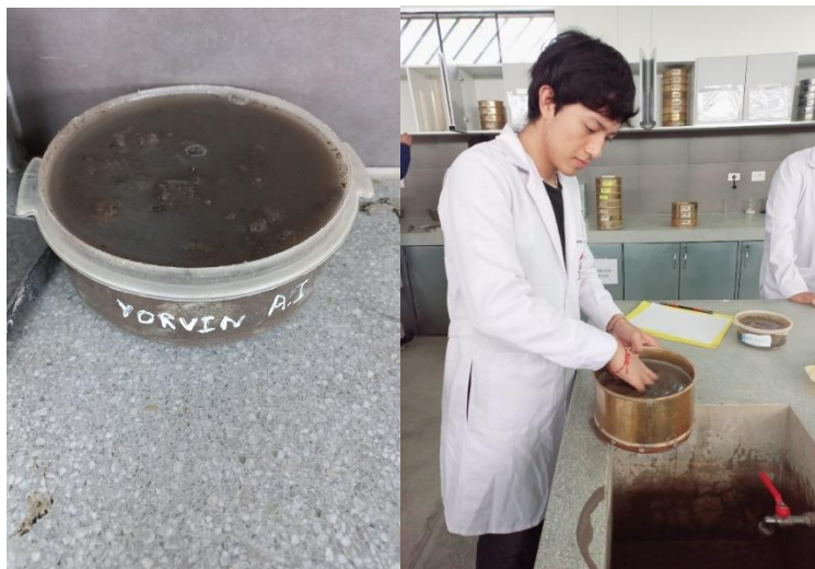
Figura 19. Saturación y lavado del suelo
