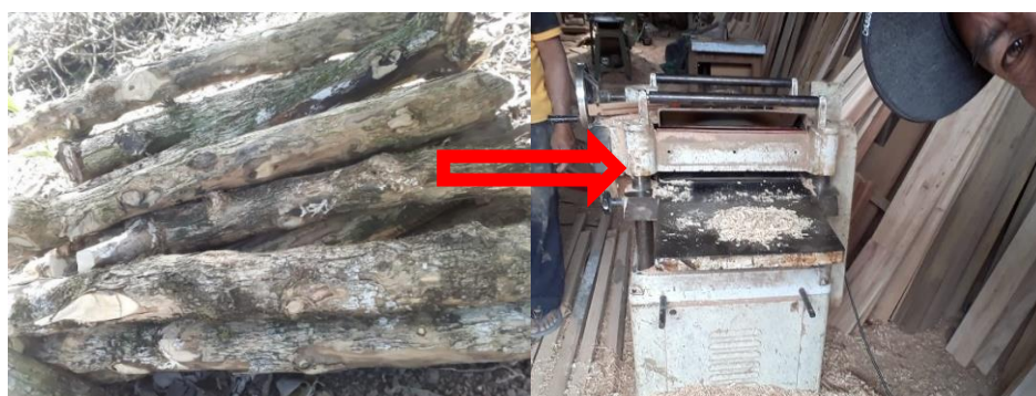
Figura 35. Proceso de tallo a viruta
