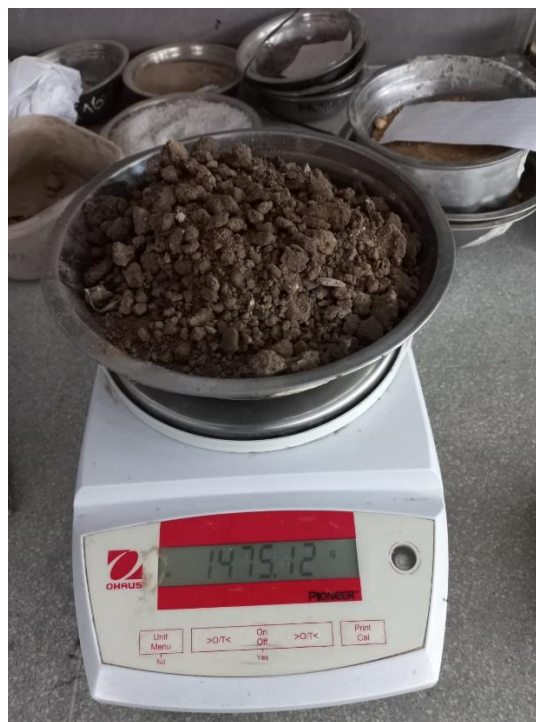
Figura 9. Muestra inicial de tierra húmeda– contenido de humedad
