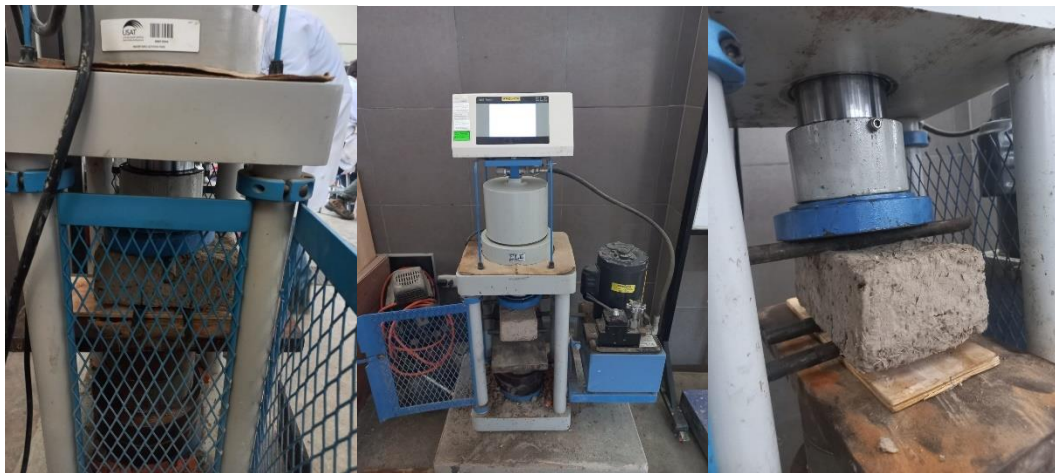
Figura 63. Colocación del adobe y apoyos
