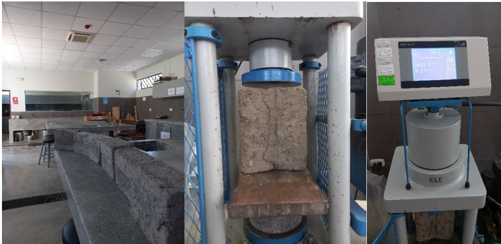
Figura 69. Ensayo de tracción del mortero
