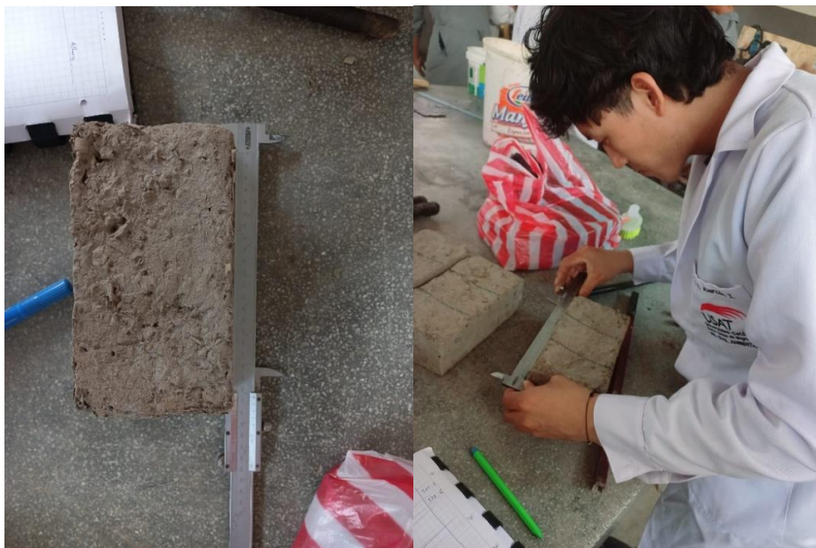
Figura 61. Toma de medidas de los adobes
