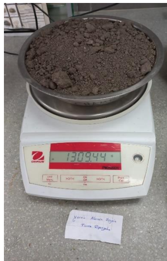
Figura 11. Ensayo de contenido de humedad – peso de muestra de tierra
