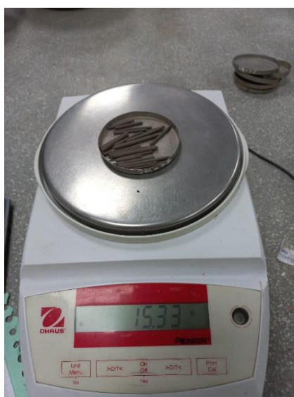
Figura 32. Registros de pesos para Límite plástico - muestra + tara (w)
