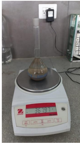
Figura 18. Registro de: peso de la muestra de suelo + agua + fiola
