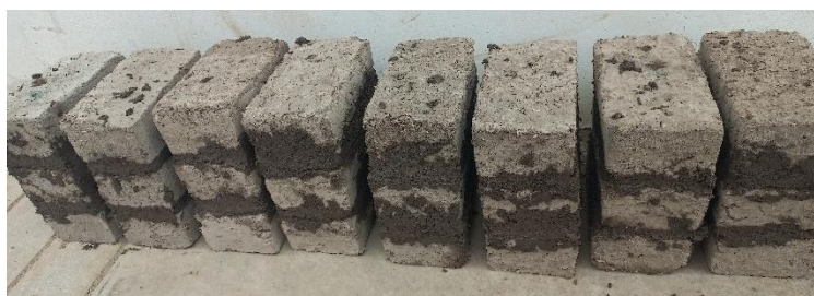
Figura 70. Pegado de los adobes en pilas
