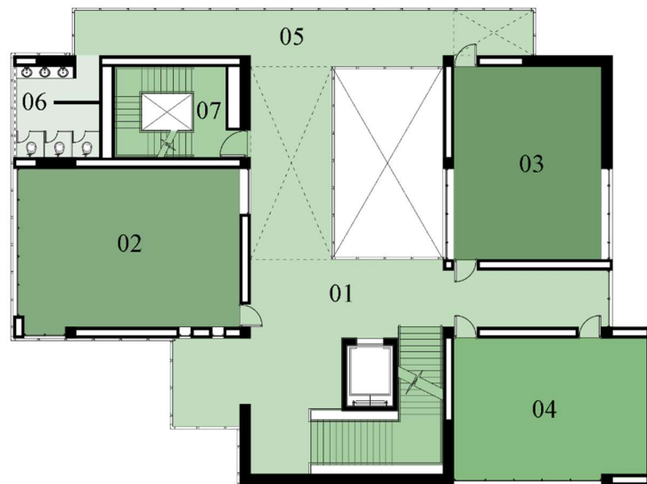
Figura 67: propuesta de distribución del segundo nivel: 01 hall de distribución; 02 sala de actuación; 03 aula teórica 01; 04 aula teórica 02; 05 balcon; 06 baño damas; 07 salida de emergencia.
