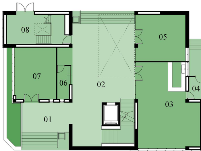
Figura 66: propuesta de distribución del primer nivel: 01 hall de ingreso; 02 hall de distribución; 03 cafetería; 04 depósito; 05 librería; 06 boletería; 07 tienda; 08 salida de emergencia.
