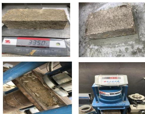
IMAGEN N°32: Realización del ensayo a compresión de los bloques convencionales y estabilizados.
