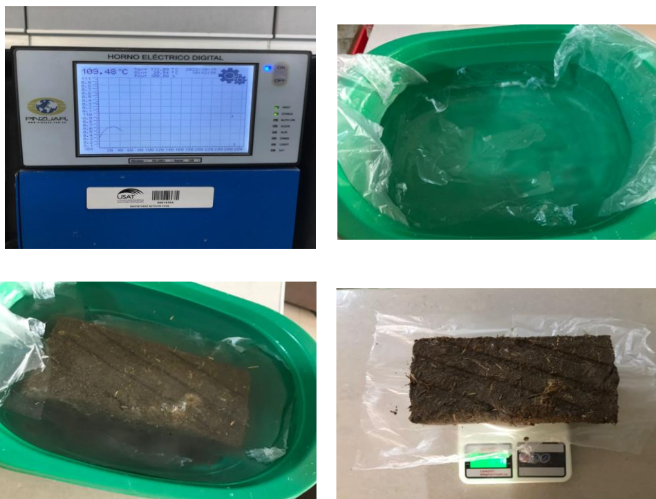
IMAGEN N°34: Realización del ensayo de absorción de los bloques convencionales y estabilizados.
