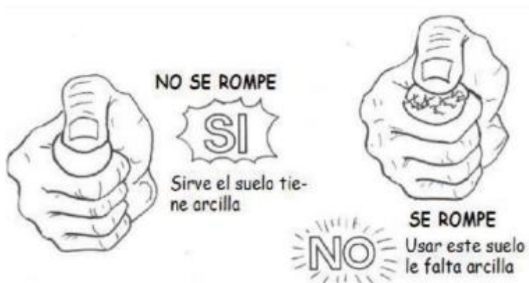
IMAGEN N°02: Manera correcta de realizar el ensayo de resistencia seca.
