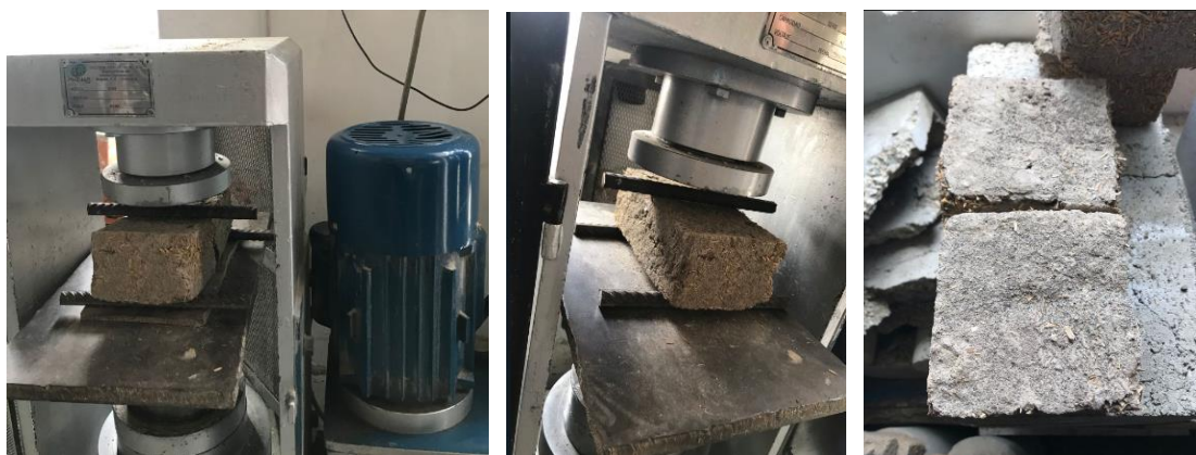
IMAGEN N°37: Realización del ensayo de módulo de rotura de los bloques.
