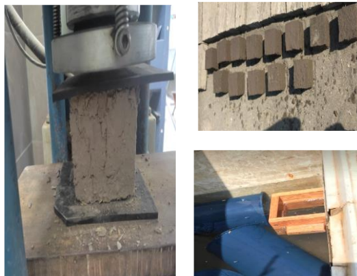
IMAGEN N°22: Realización del ensayo de compresión en cubos de barro.
