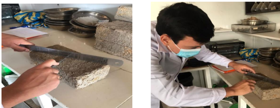
IMAGEN N°35: Realización del ensayo de alabeo de los bloques convencionales.
