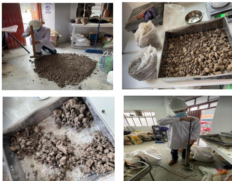
IMAGEN N°17: Realización del ensayo de Proctor modificado.
