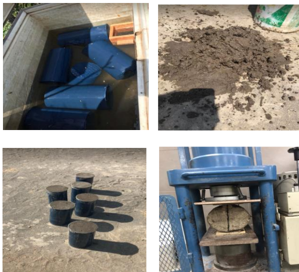
IMAGEN N°23: Realización del ensayo de tracción indirecta para probetas de barro.
