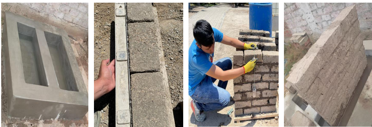
IMAGEN N°40: Realización del ensayo de inundación simulada en muretes de los bloques.
