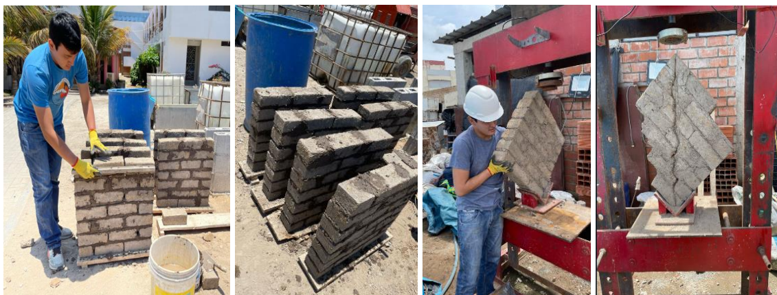
IMAGEN N°39: Realización del ensayo de resistencia a la compresión en muretes de los bloques.
