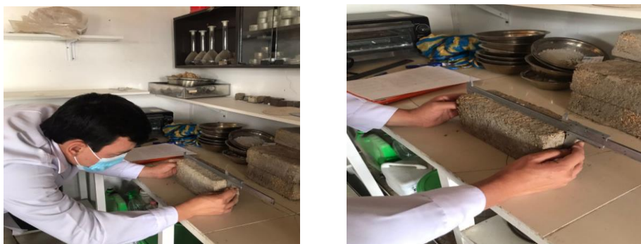
IMAGEN N°36: Realización del ensayo de variación dimensional de los bloques convencionales.
