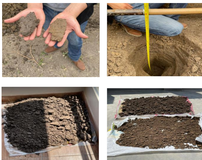
IMAGEN N°16: Separación y secado de las muestras extraídas.
