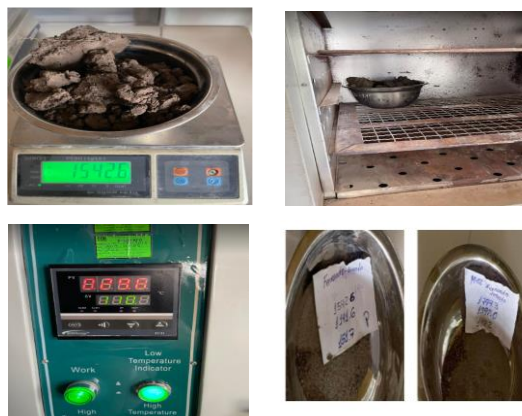
IMAGEN N°18: Realización del ensayo de contenido de humedad.
