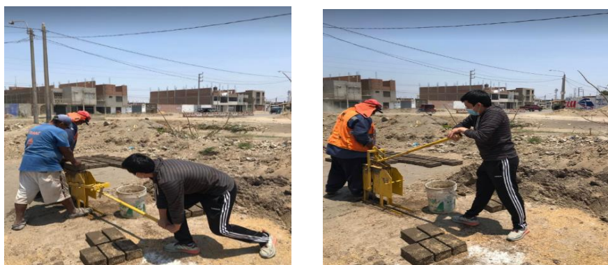
IMAGEN N°30: Moldeado de los bloques en la máquina prensadora.
