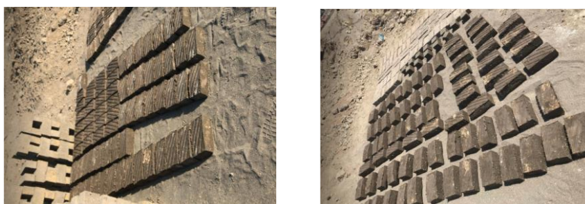
IMAGEN N°31: secado y almacenamiento de los bloques estabilizados.
