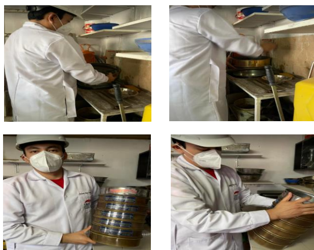
IMAGEN N°21: Realización del ensayo de granulometría.
