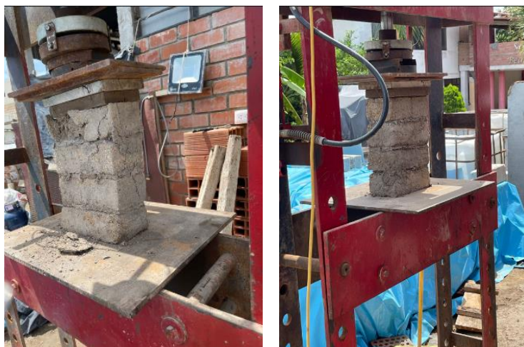
IMAGEN N°38: Realización del ensayo de resistencia a la compresión en pilas de los bloques.
