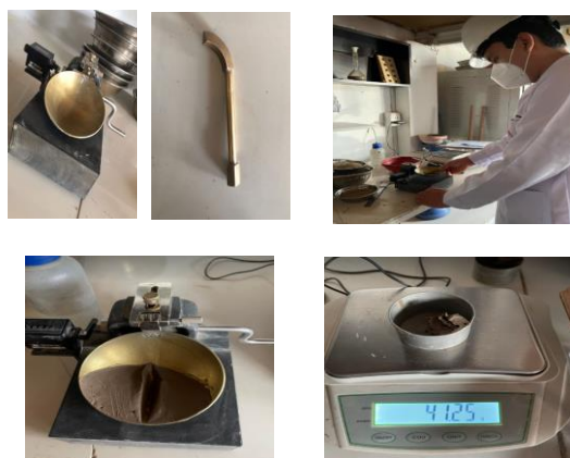
IMAGEN N°19: Realización del ensayo de límite líquido.
