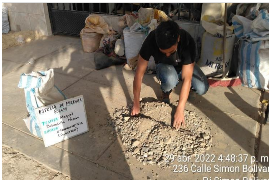
Fotografía 48. Cuarteo del agregado
