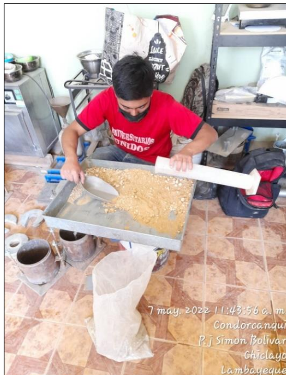
Fotografía 41. Humedecimiento de muestra para ensayo de proctor
