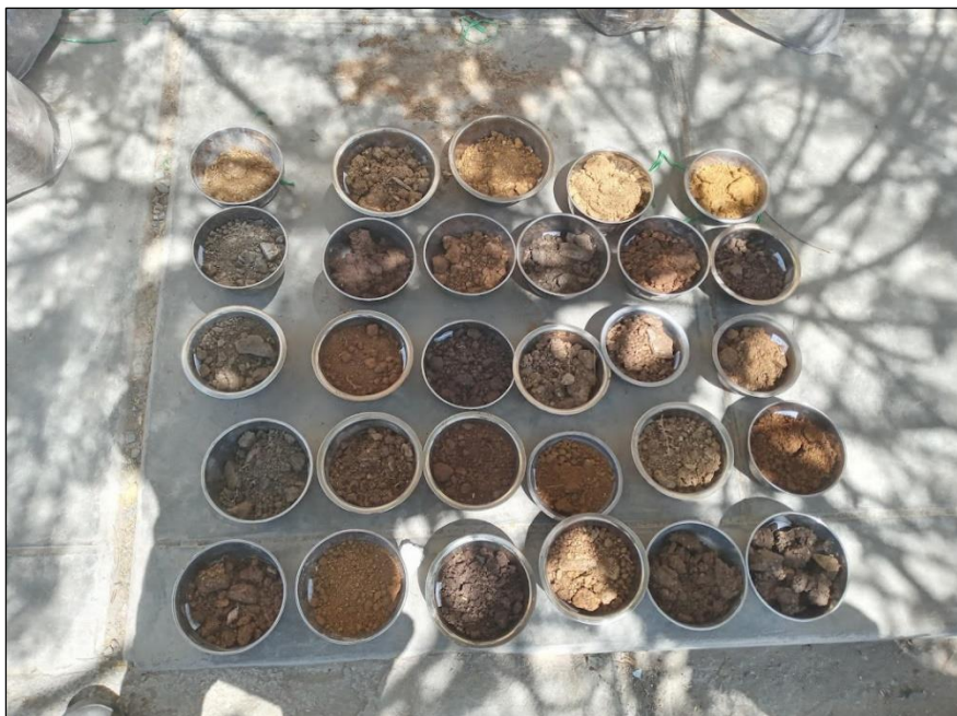
Fotografía 35. Muestras en taras para ser ensayadas
