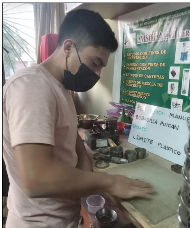
Fotografía 39. Ensayo de límite plástico
