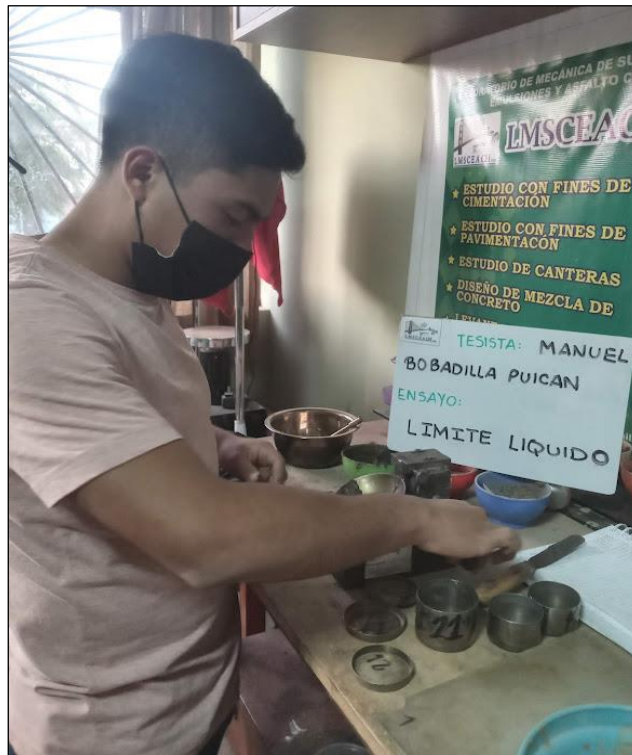
Fotografía 38. Ensayo de límite líquido
