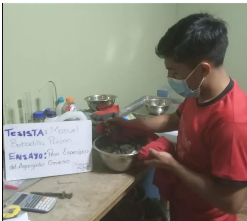
Fotografía 52. Secado superficial del agregado grueso
