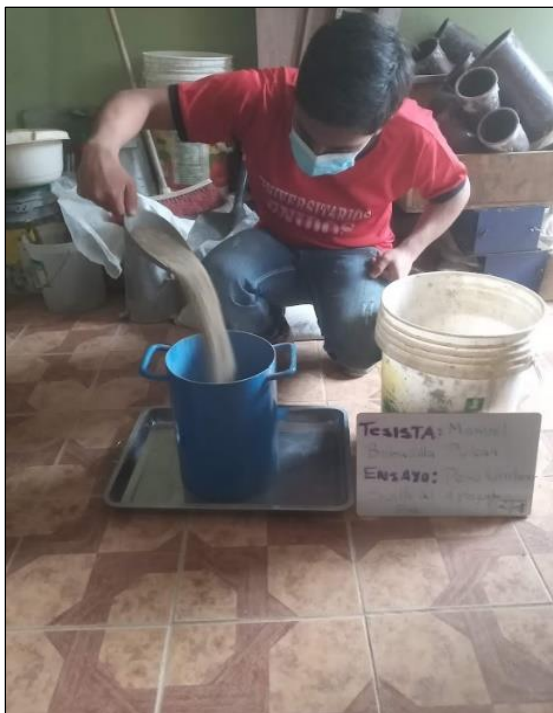
Fotografía 49. Ensayo de peso unitario suelto de agregados
