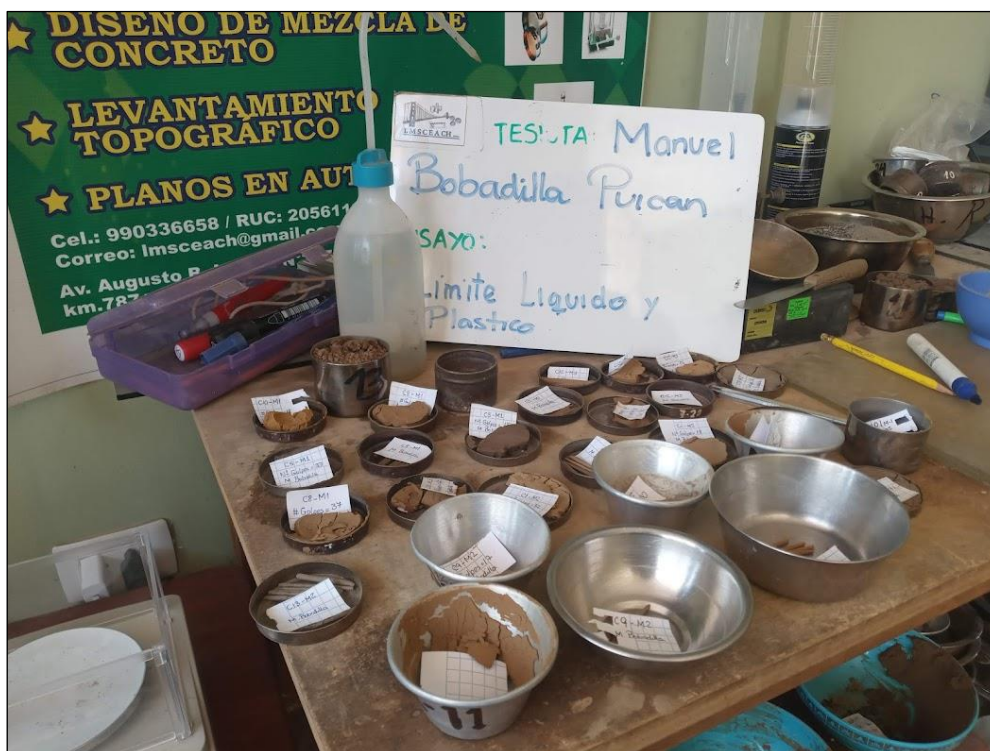
Fotografía 40. Muestras de ensayo de límite líquido y plástico
