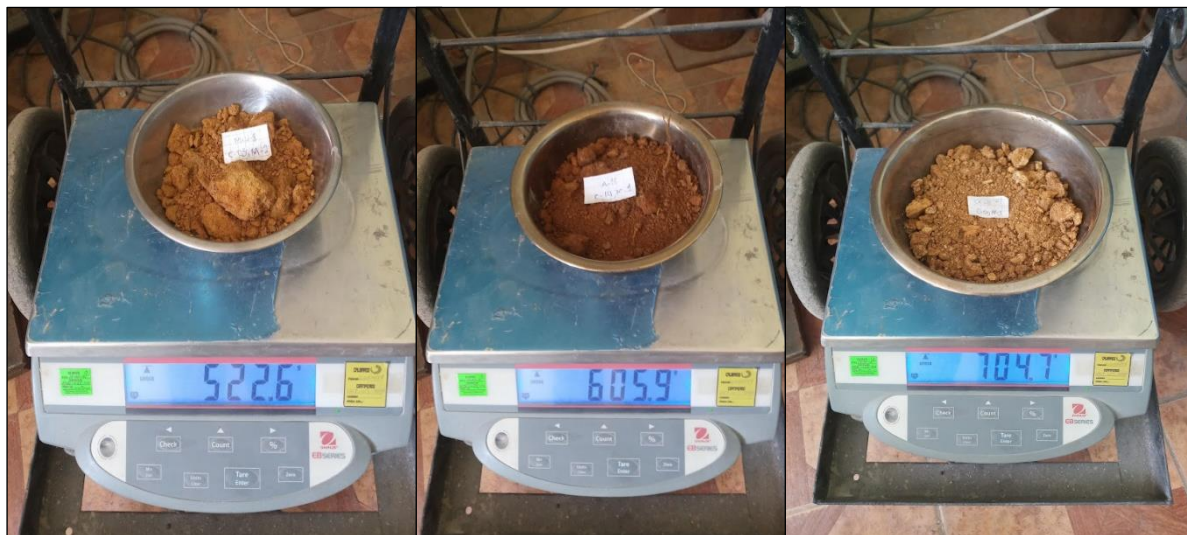
Fotografía 36. Pesado de muestras para ensayo de contenido de humedad
