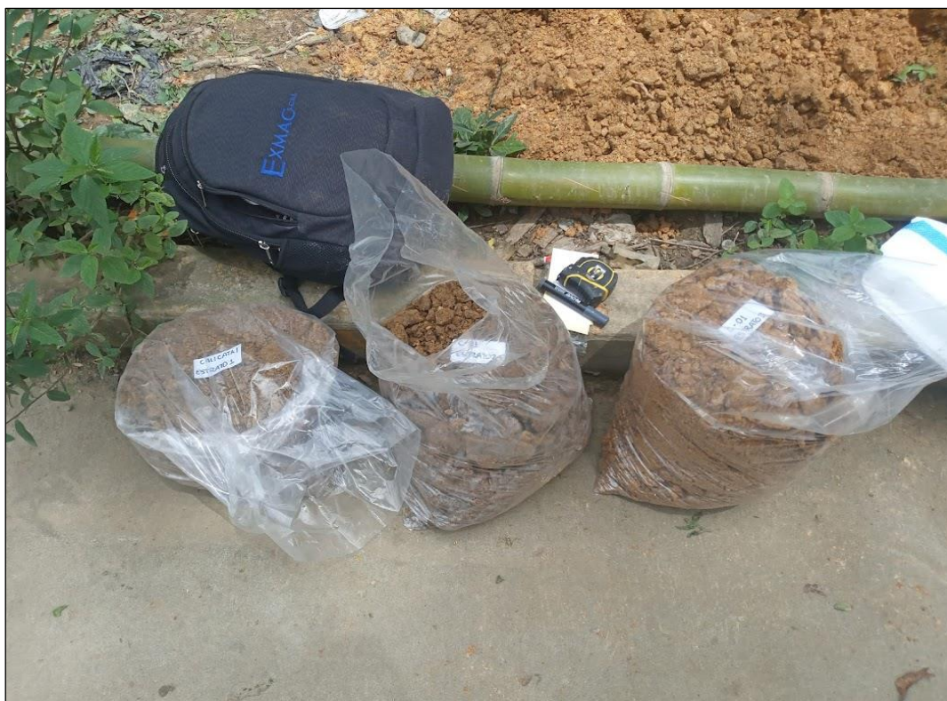
Fotografía 19. Muestra extraída de Calicata N°1
