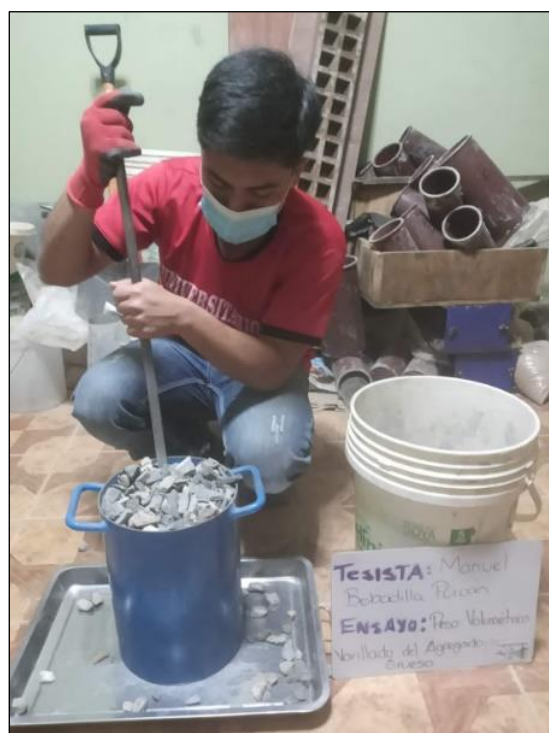
Fotografía 50. Ensayo de peso unitario compactado de agregados
