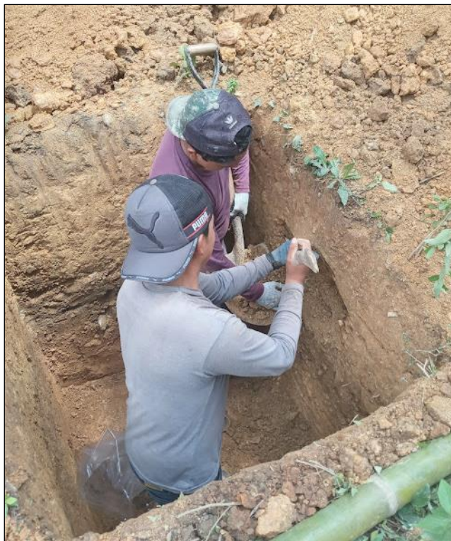
Fotografía 17. Excavación y extracción de muestra de Calicata N°1
