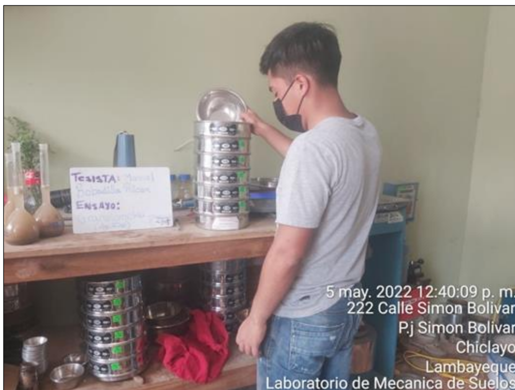
Fotografía 47. Ensayo de granulometría de agregados
