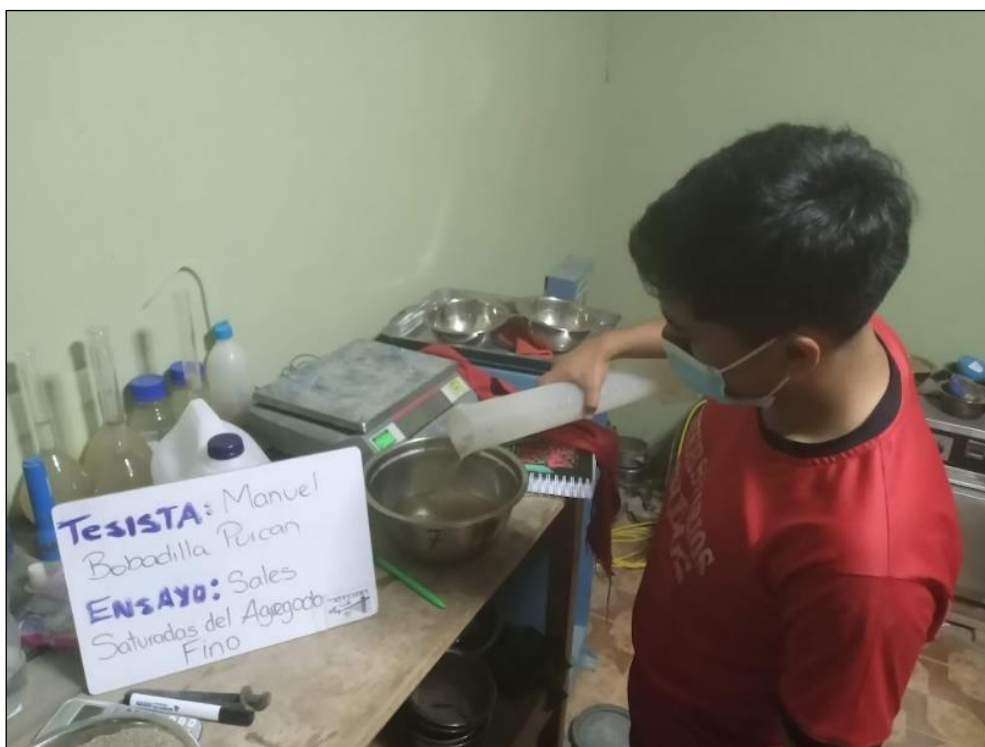
Fotografía 51. Saturación de agregado fino para ensayo de sales
