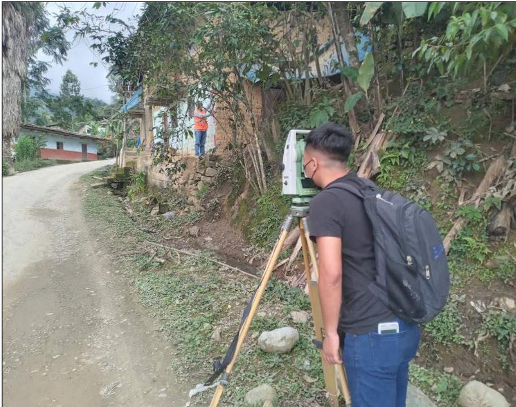
Fotografía 6. Levantamiento topográfico con estación total
