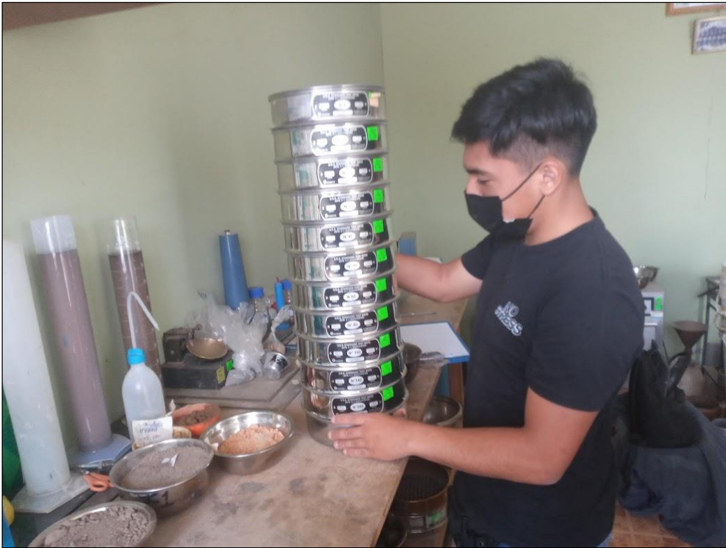
Fotografía 37. Ensayo de granulometría
