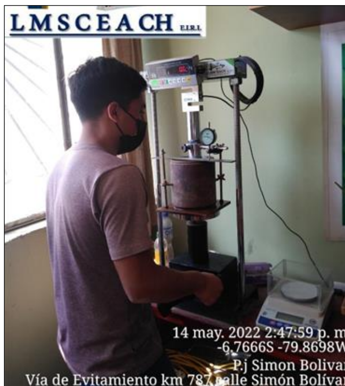
Fotografía 44. Ensayo de penetración
