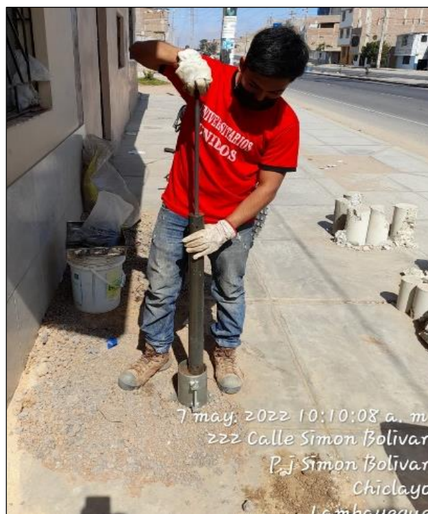
Fotografía 42. Ensayo de proctor modificado
