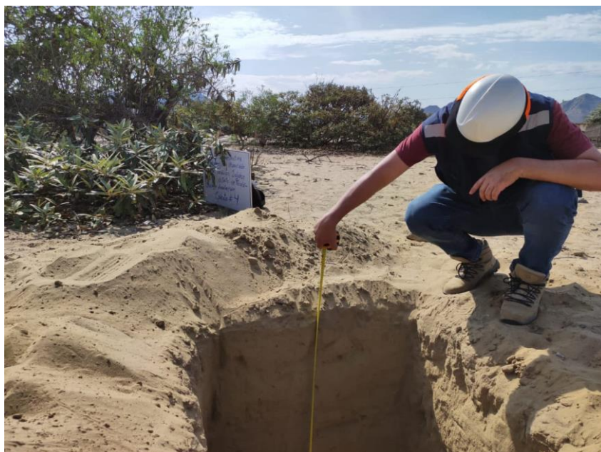
Fotografía N°10: Medida de la calicata C-4
