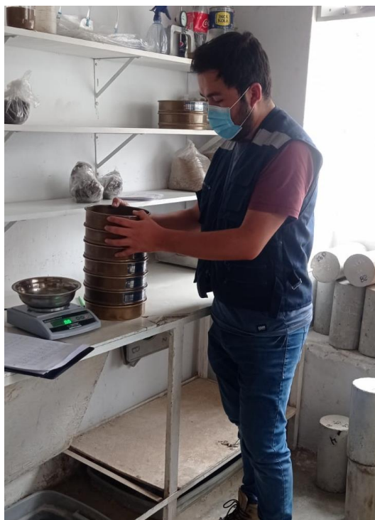
Fotografía N°12: Ensayo de granulometría
