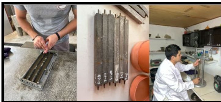
Figura 37. Procedimiento para la determinación de la durabilidad del concreto mediante solución sulfatada.
