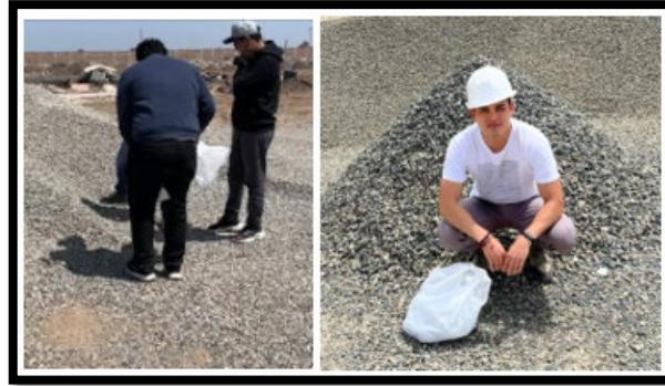
Figura 13. Obtención de muestra de agregados de proveedor de la cantera de Pachérres. Fuente: Propia.
