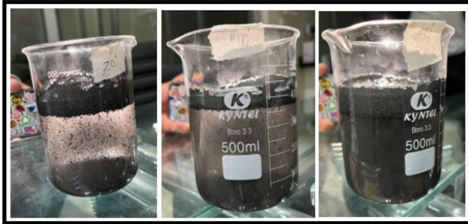
Figura 8. Muestra M-20', M-40' y M-60' una hora en reposo después de su dispersión. Fuente: Propia.
