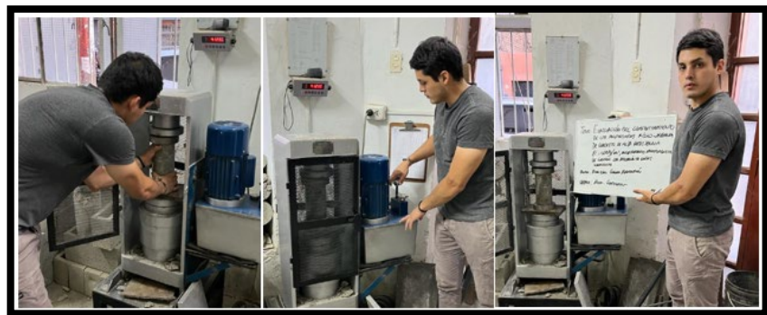
Figura 34. Procedimiento para la determinación de la resistencia a la compresión. Fuente: Propia.
