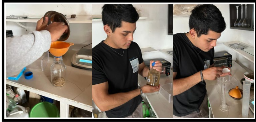
Figura 22. Procedimiento para determinar el contenido de sales en el agregado fino y grueso.
