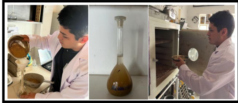
Figura 21. Procedimiento para hallar el peso específico y absorción del agregado fino.
