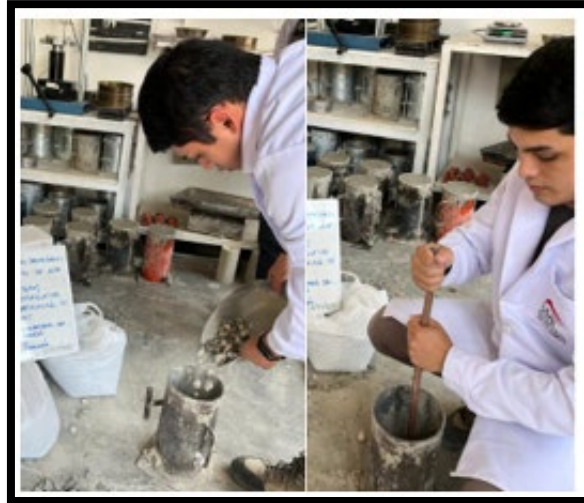
Figura 19. Procedimiento para hallar el peso unitario compactado del agregado grueso. Fuente: Propia.
