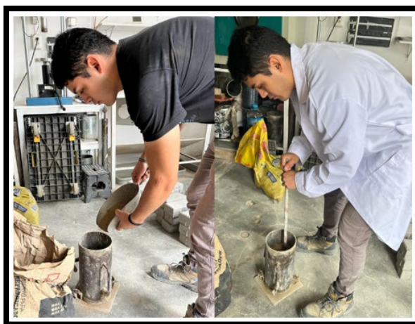
Figura 18. Procedimiento para hallar el peso unitario compactado del agregado fino. Fuente: Propia.
