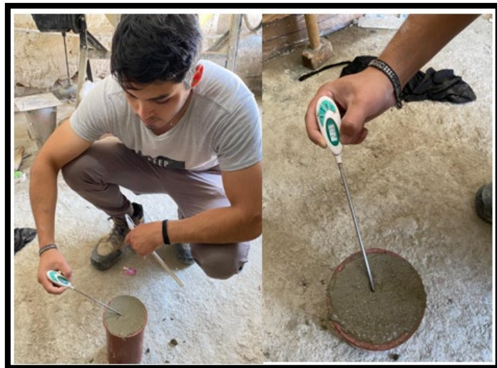
Figura 32. Procedimiento para determinar la temperatura del concreto. Fuente: Propia.
