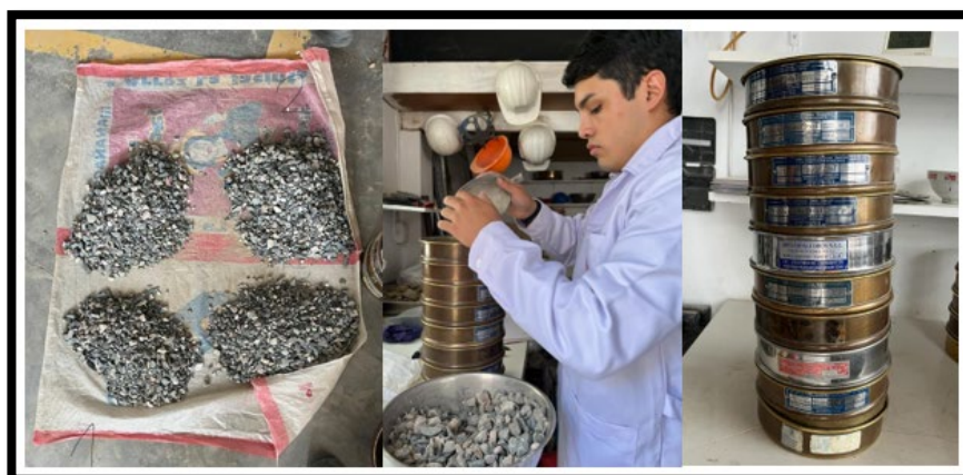
Figura 17. Procedimiento para el análisis granulométrico del agregado grueso.
