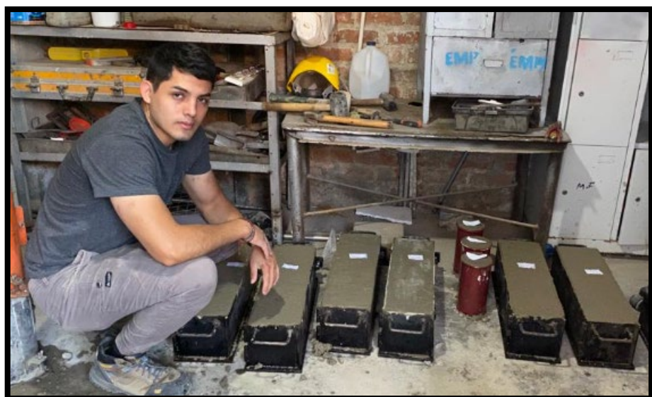
Figura 28. Protección de especímenes de concreto. Fuente: Propia.
