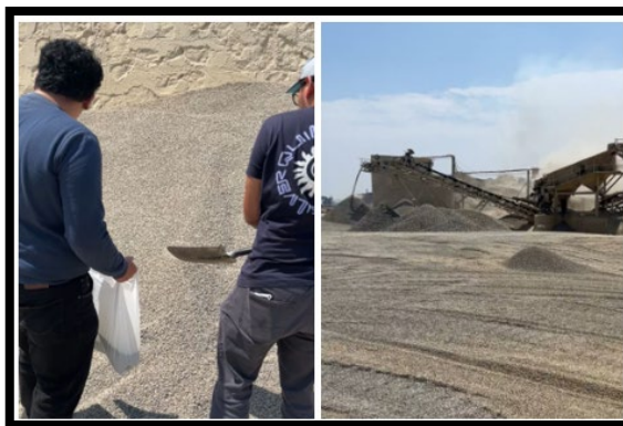
Figura 12. Obtención de muestra de agregado grueso de la cantera de Ferreñafe.
