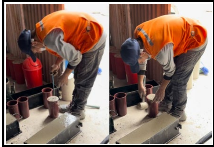
Figura 26. Elaboración de especímenes cilíndricos de concreto. Fuente: Propia.
