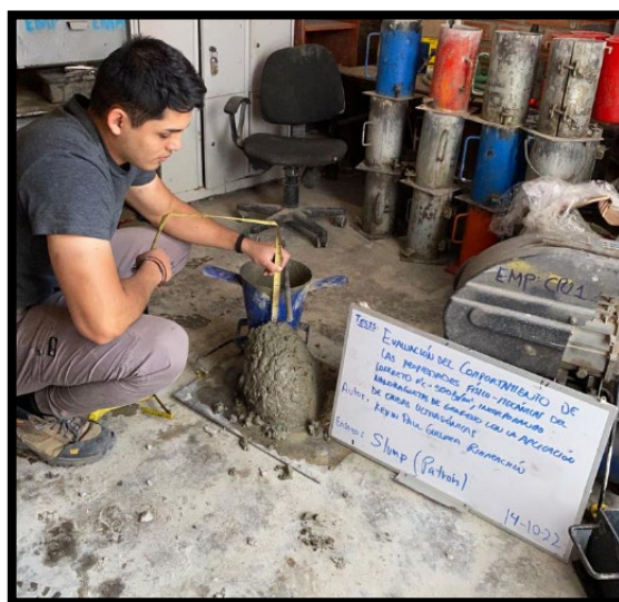
Figura 31. Ensayo de asentamiento del concreto en estado fresco.
