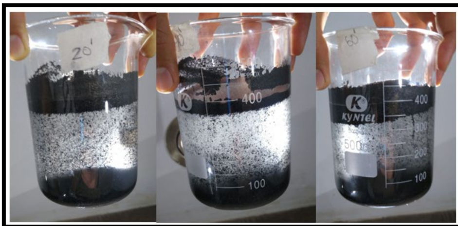
Figura 9. Muestra M-20', M-40' y M-60' dos horas en reposo después de su dispersión. Fuente: Propia.
