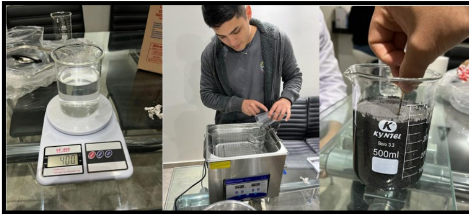
Figura 5. Peso de la solución dispersante, adición de los 5g de nanoplaquetas de grafeno y primer mezclado con palillo de madera.
