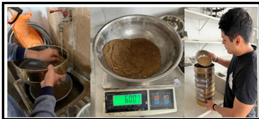
Figura 16. Procedimiento para el análisis granulométrico del agregado fino.
