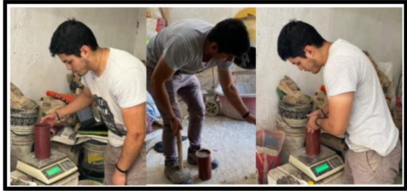
Figura 30. Procedimiento para determinar el peso unitario del concreto en estado fresco.
