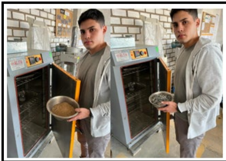
Figura 15. Colocación de agregados al horno para ensayo de contenido de humedad.
