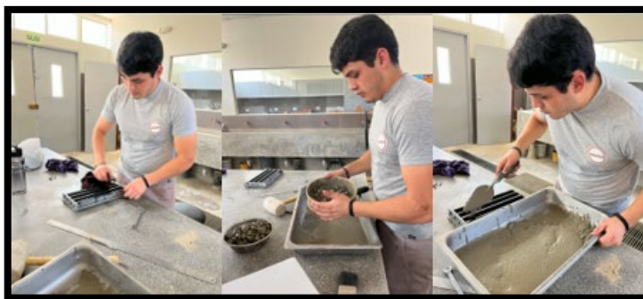
Figura 36. Procedimiento para la determinación de la durabilidad del concreto mediante solución sulfatada.
