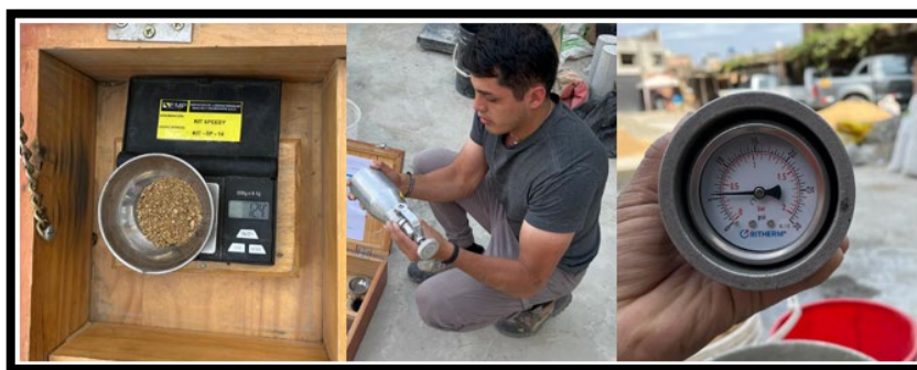
Figura 23. Ensayo para corrección de indicación vs humedad mediante Speedy. Fuente: Propia.
