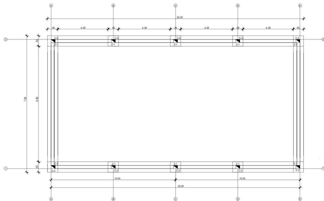
PLANTA DE CIMENTACION / LECHO DE SECADO ESC. 1/20
