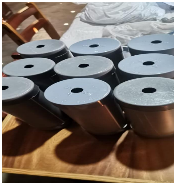
Figura 45: Perforación en los ejes de las tapas de PVC para la elaboración del filtro. Fuente: propia
