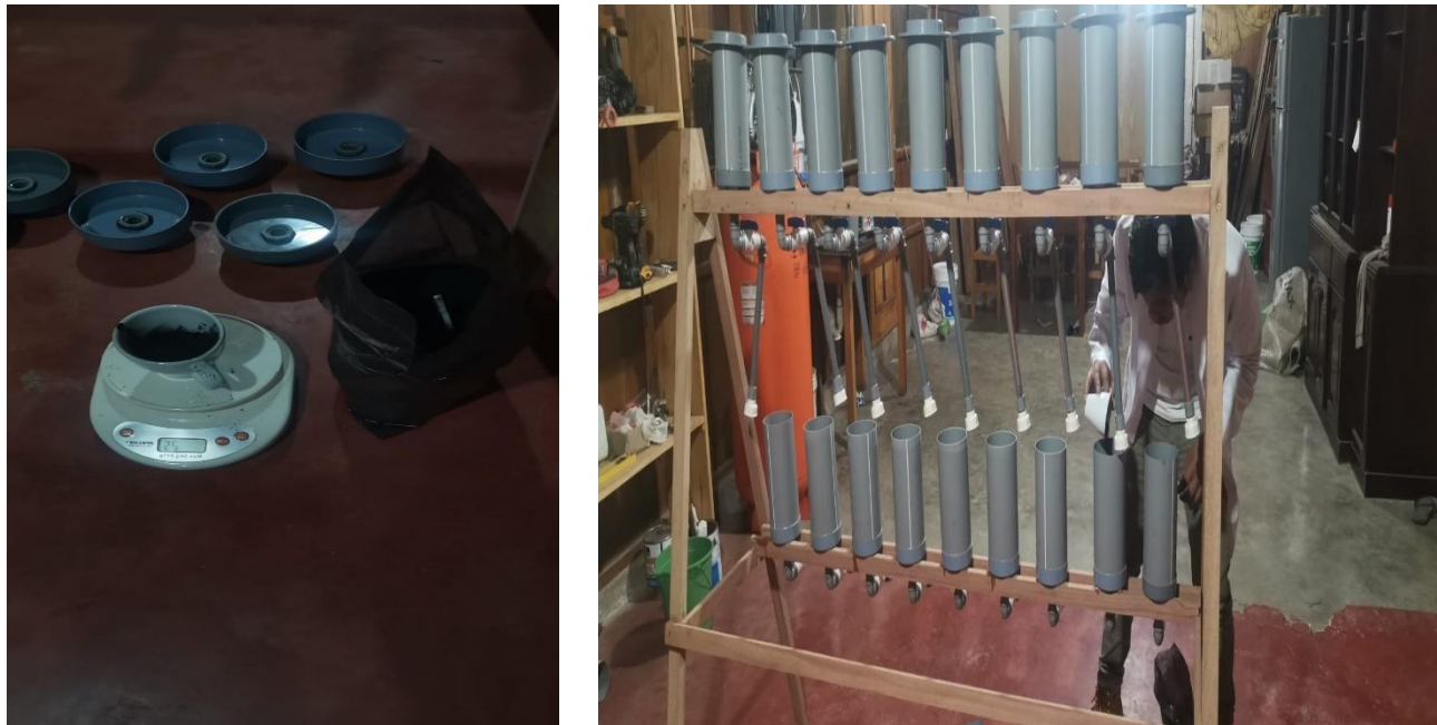
Figura 50: muestras con 25 gr de carbón activado. Fuente: propia
