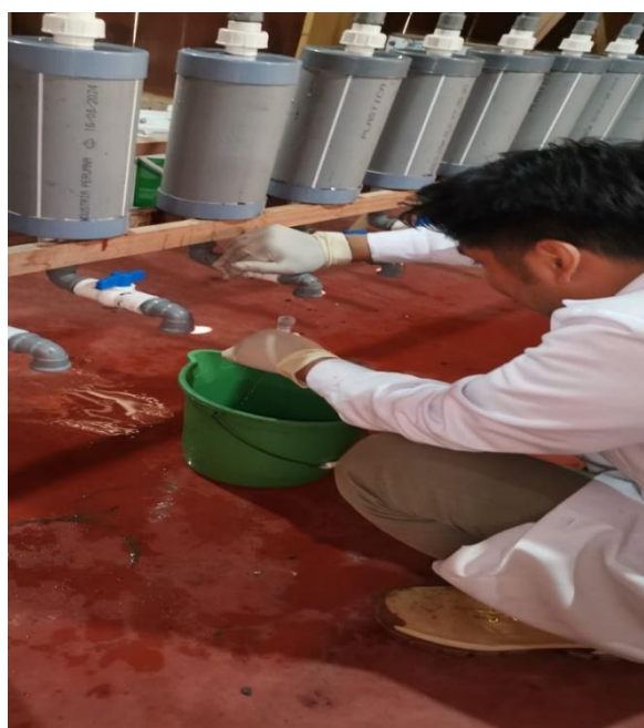
Figura 53: Tomas de muestras realizada de carbón activado con 25,50,75 gr. Fuente: propia
