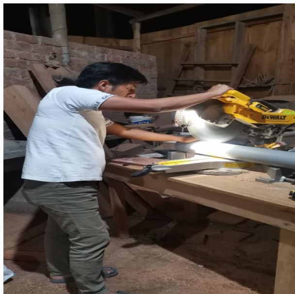
Figura 42: Corte de PVC para la elaboración del filtro. Fuente: propia
