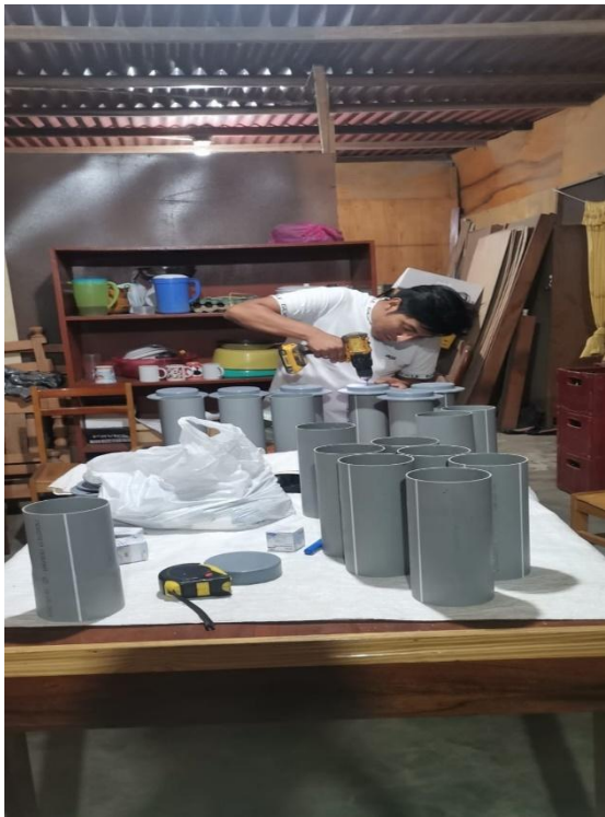
Figura 44: Perforación de tapas de PVC para la elaboración del filtro. Fuente: propia
