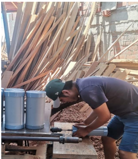
Figura 45: Perforación en los ejes de las tapas de PVC para la elaboración del filtro. Fuente: propia
