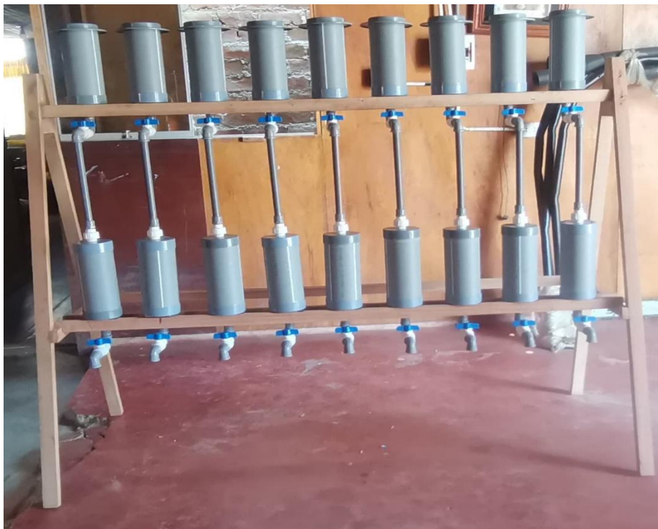
Figura 48: Armado final de los filtros. Fuente: propia
