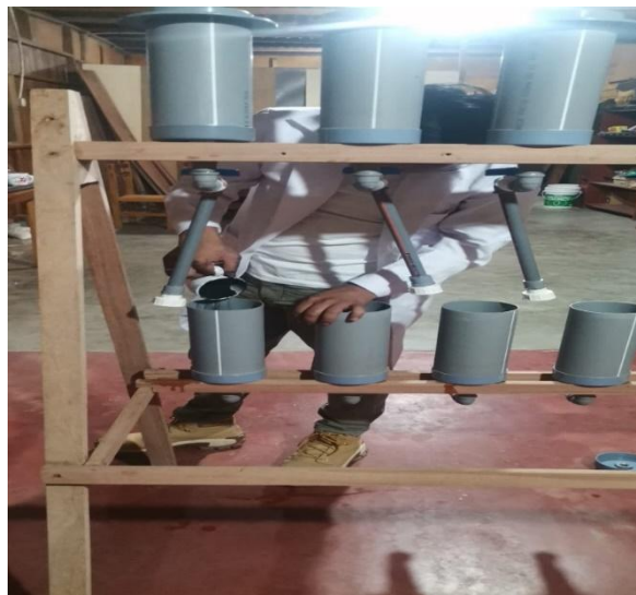
Figura 52: Muestras con 75 gr de carbón activado. Fuente: propia
