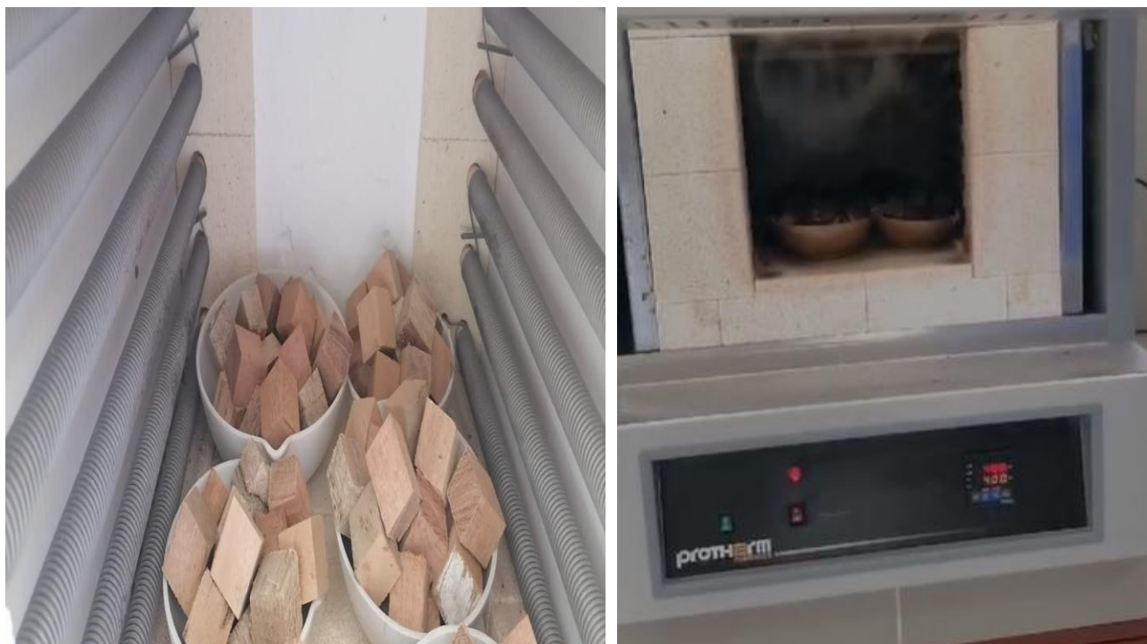
Figura 29: Incineración de la madera. Fuente: propia
