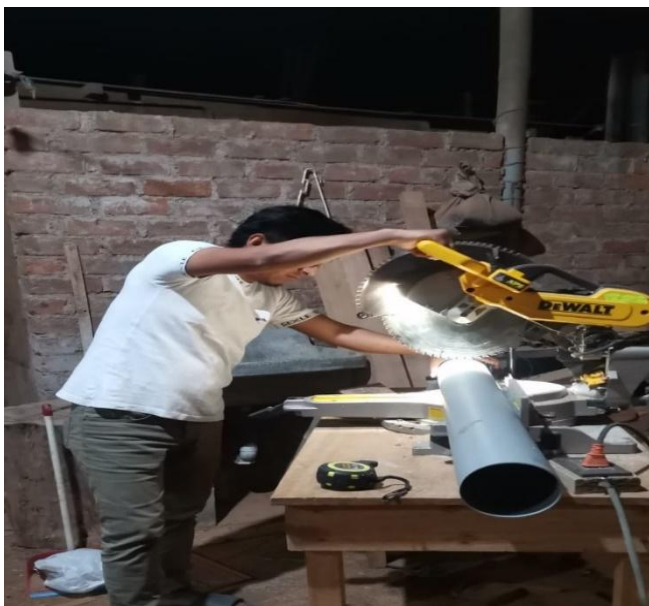
Figura 42: Corte de PVC para la elaboración del filtro. Fuente: propia
