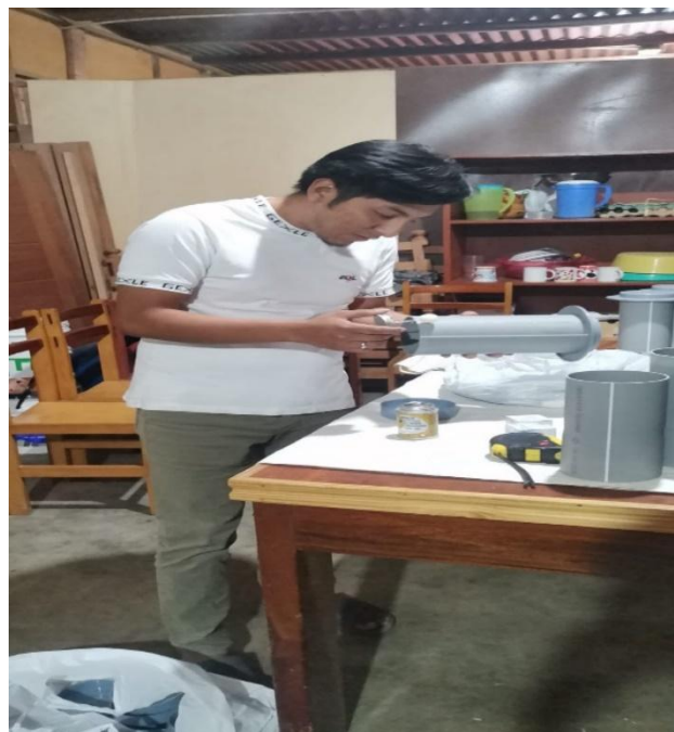
Figura 43: Lijado y pegado de PVC para la elaboración del filtro. Fuente: propia
