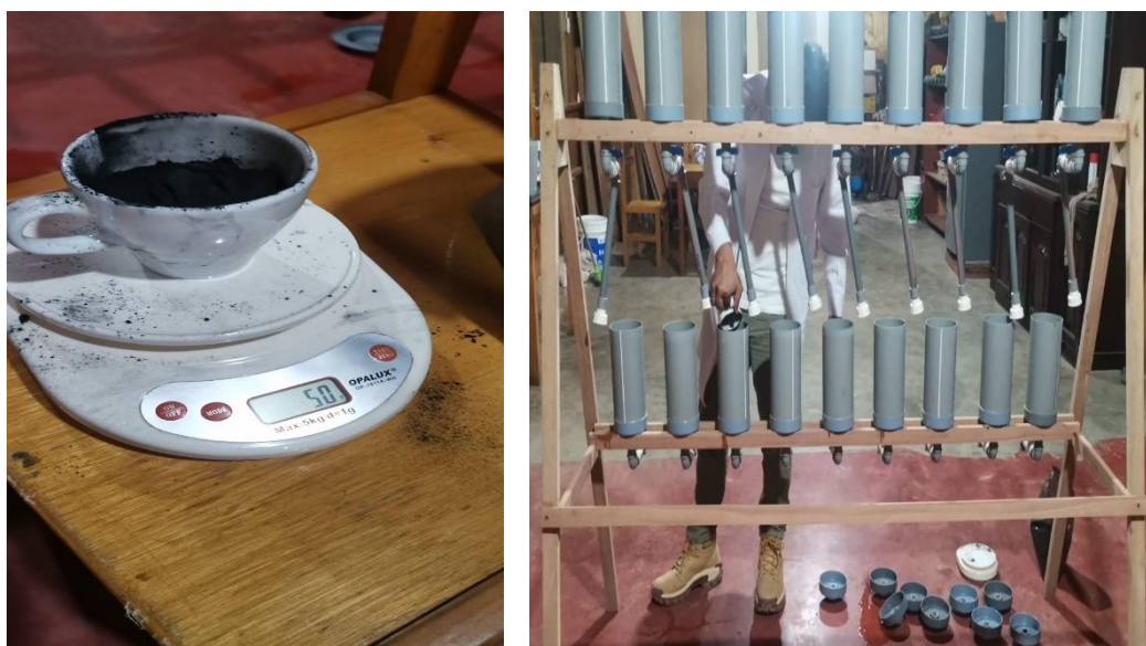
Figura 51: Muestras con 50 gr de carbón activado. Fuente: propia
