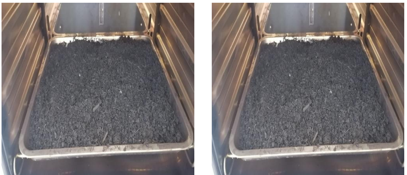
Figura 34: Secado del carbón activado. Fuente: propia
