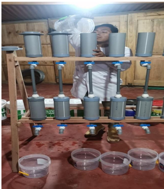
Figura 53: Tomas de muestras realizada de carbón activado con 25,50,75 gr. Fuente: propia
