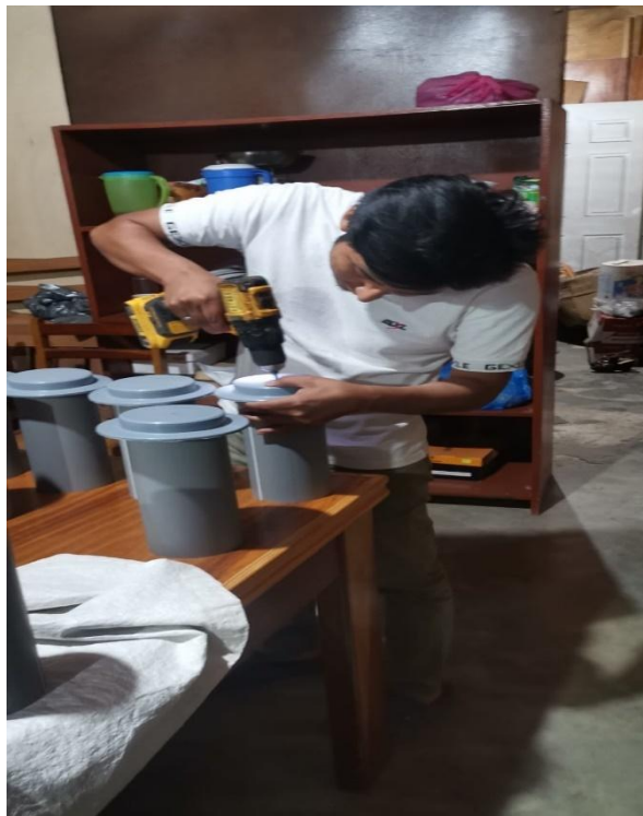
Figura 44: Perforación de tapas de PVC para la elaboración del filtro. Fuente: propia
