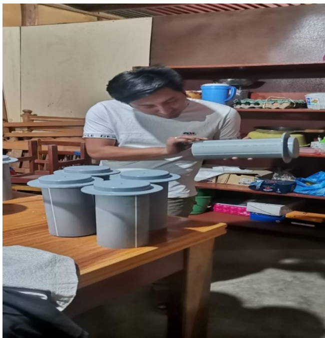
Figura 43: Lijado y pegado de PVC para la elaboración del filtro. Fuente: propia
