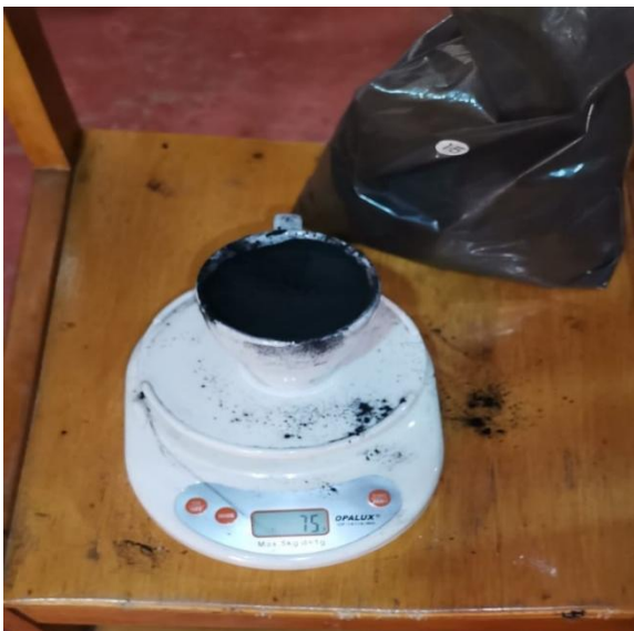
Figura 52: Muestras con 75 gr de carbón activado. Fuente: propia
