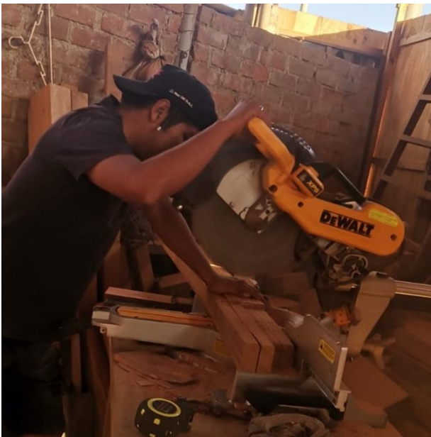
Figura 47: Elaboración de soporte para el apoyo de los filtros. Fuente: propia
