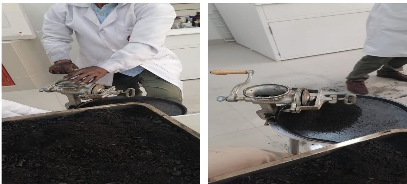
Figura 30: Molienda de la madera incinerada. Fuente: propia
