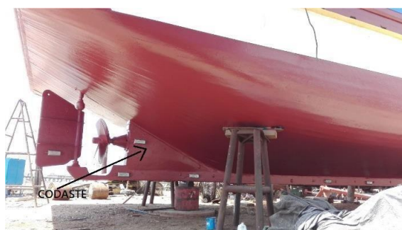
Figura 3: Codaste vista exteriormente
