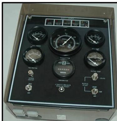
Figura 12: Instrumentación y control de la embarcación
