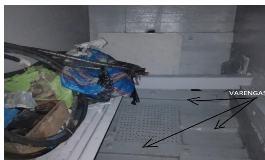
Figura 6: Varengas longitudinales vista
