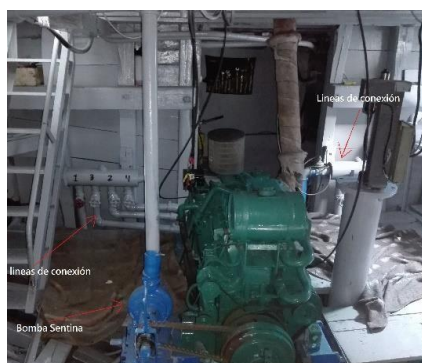
Figura 14: Sistema de achique vito transversalmente
