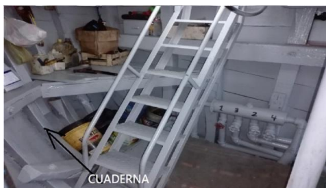
Figura 4: Cuadernas vistas interiormente
