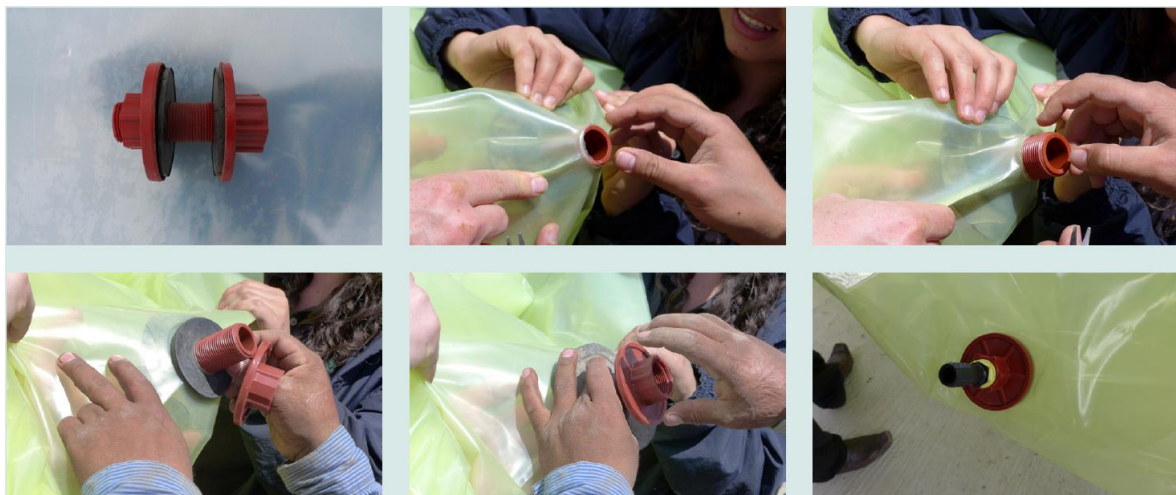
Figura 12. Instalación de accesorio de la salida del biogás
