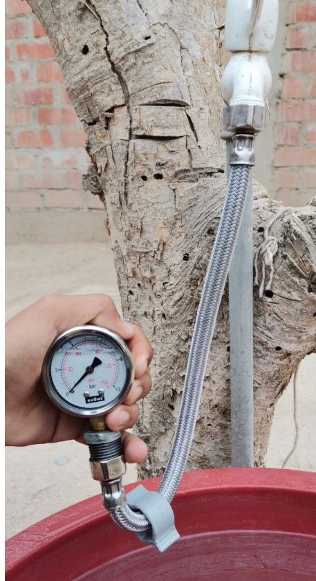
Imagen N° 15: Medición de presiones
