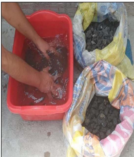
Ilustración N°4.12: Lavado de agregados reciclados. Fuente: Propia
