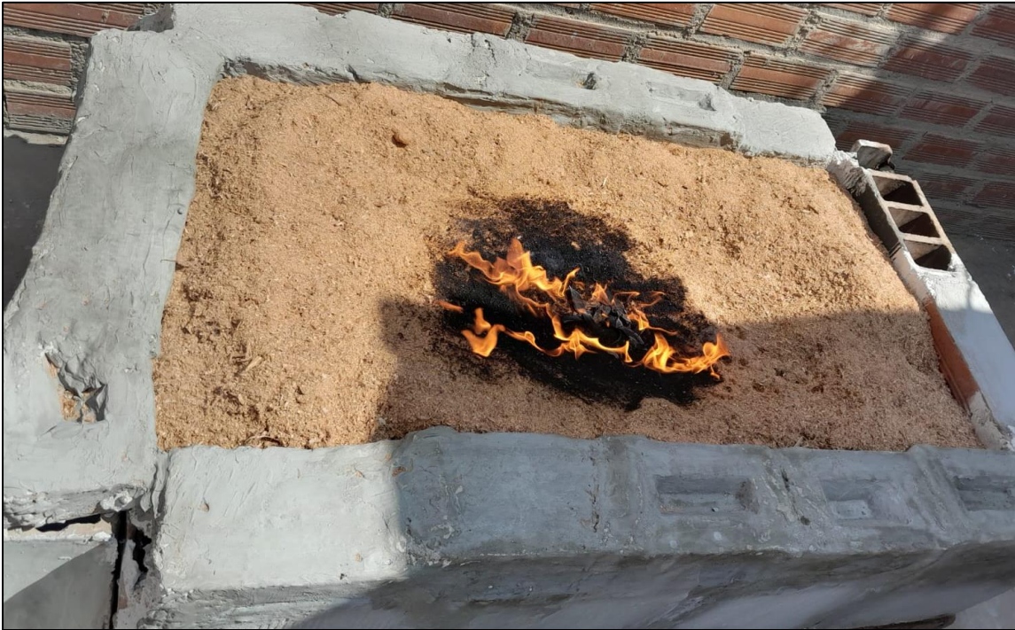
Ilustración N°4.20: Calcinación del aserrín. Fuente: Propia
