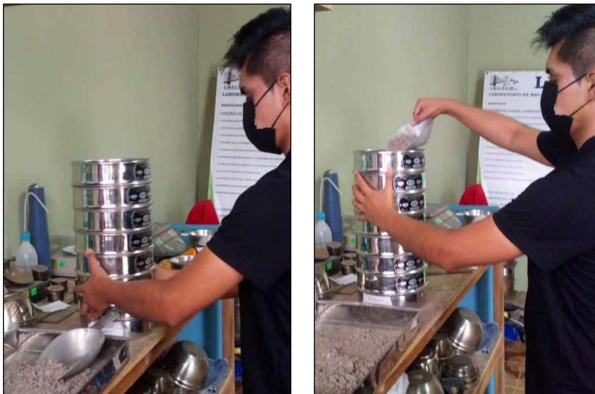
Ilustración N°4.28: Cribado de muestra natural C- 01 – ensayo granulometría por tamizado. Fuente: Propia
