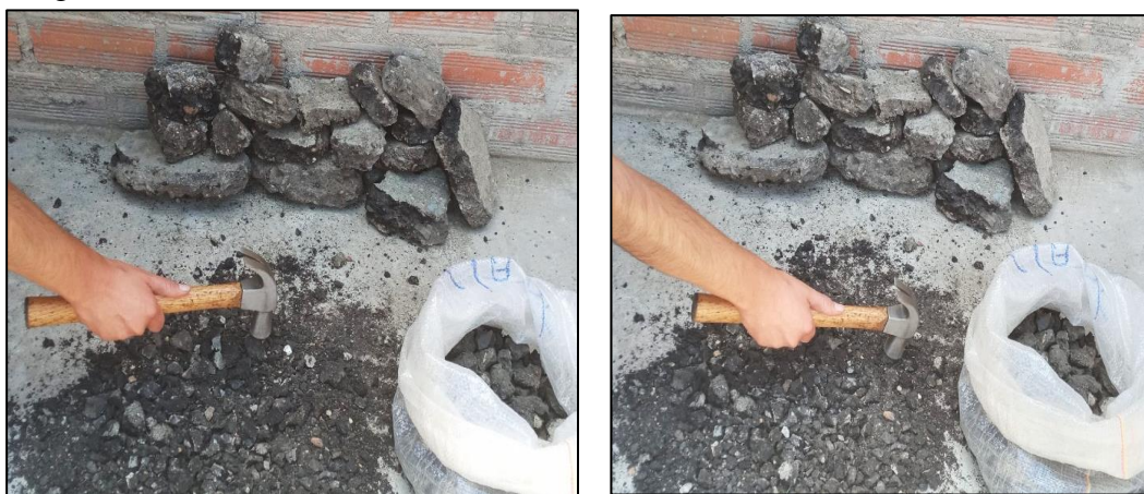
Figura 30: Disgregado de carpeta asfáltica. Fuente: Propia
