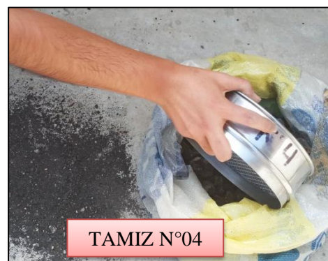
Figura 32: Tamizado de agregados reciclados por la malla N°04. Fuente: Propia
