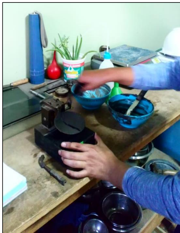
Ilustración N°4.40: Colocación de muestra experimental C-01 (1) en cuchara de Casagrande – ensayo límite líquido. Fuente: Propia
