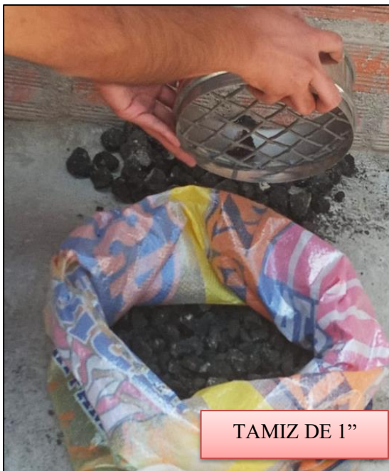
Ilustración N°4.10: Tamizado de agregados reciclados por el tamiz de 1". Fuente: Propia
