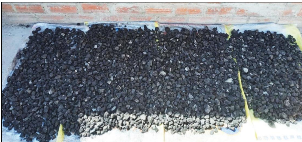
Ilustración N°4.13: Secado de muestra 01 de agregados de carpetas asfálticas tratados. Fuente: Propia
