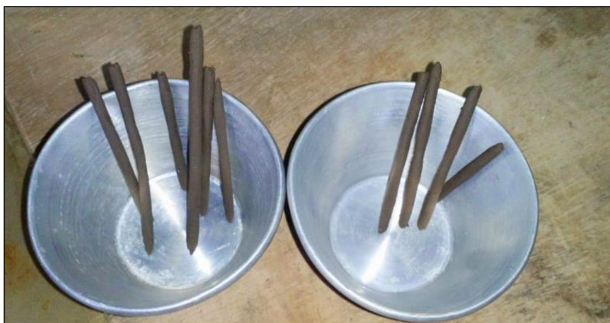
Ilustración N°4.37: Cilindros de 3.00mm obtenidos de muestra natural C-01 – ensayo limite plástico. Fuente: Propia
