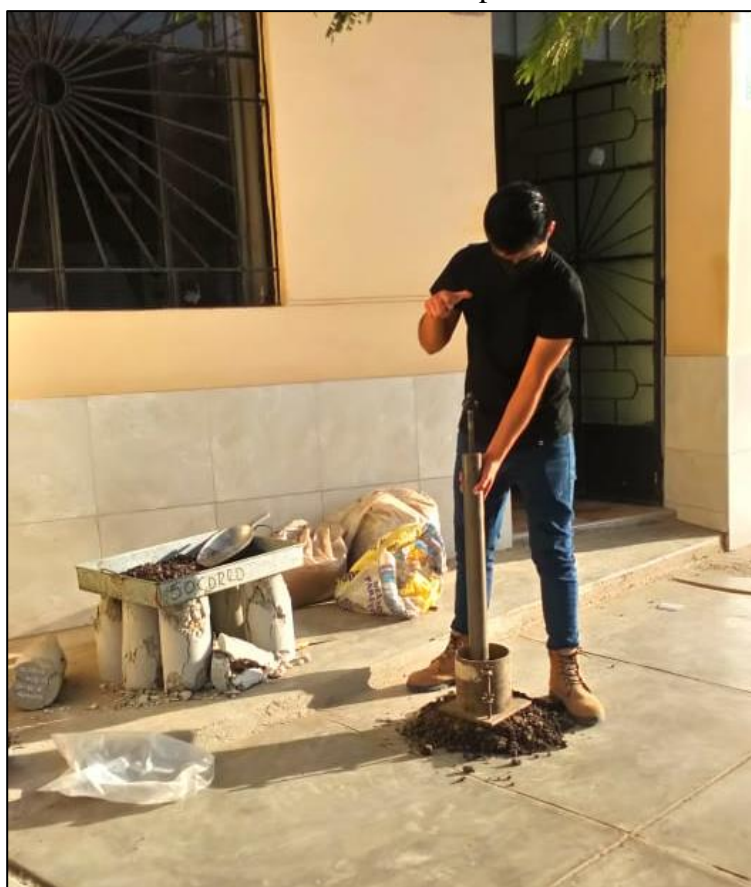
Ilustración N°4.42: Llenado de molde de compactación con muestra C-01 (1) – ensayo Proctor. Fuente: Propia
