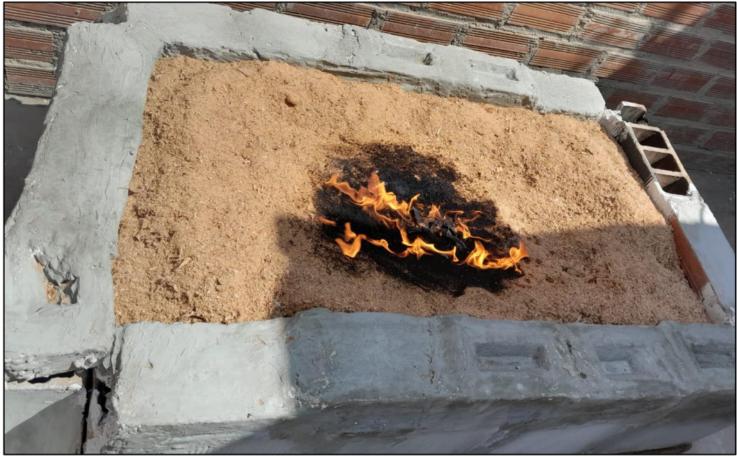
Figura 42: Fuego estable durante el calcinado del aserrín. Fuente: Propia
