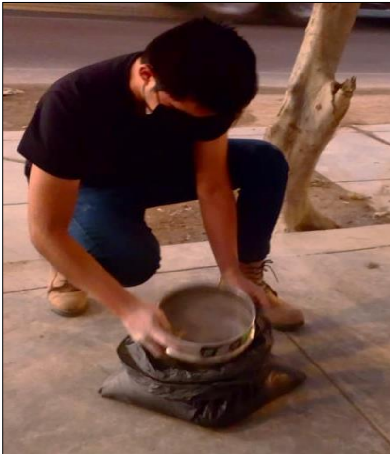
Ilustración N°4.21: Tamizado de cenizas. Fuente: Propia
