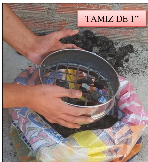
Figura 31: Tamizado de agregados reciclados por la malla de 1". Fuente: Propia
