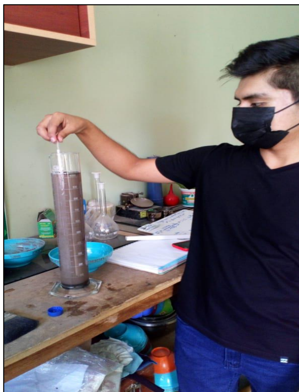
Ilustración N°4.31: Registro de temperatura en muestra C-01 - ensayo granulometría por sedimentación. Fuente: Propia
