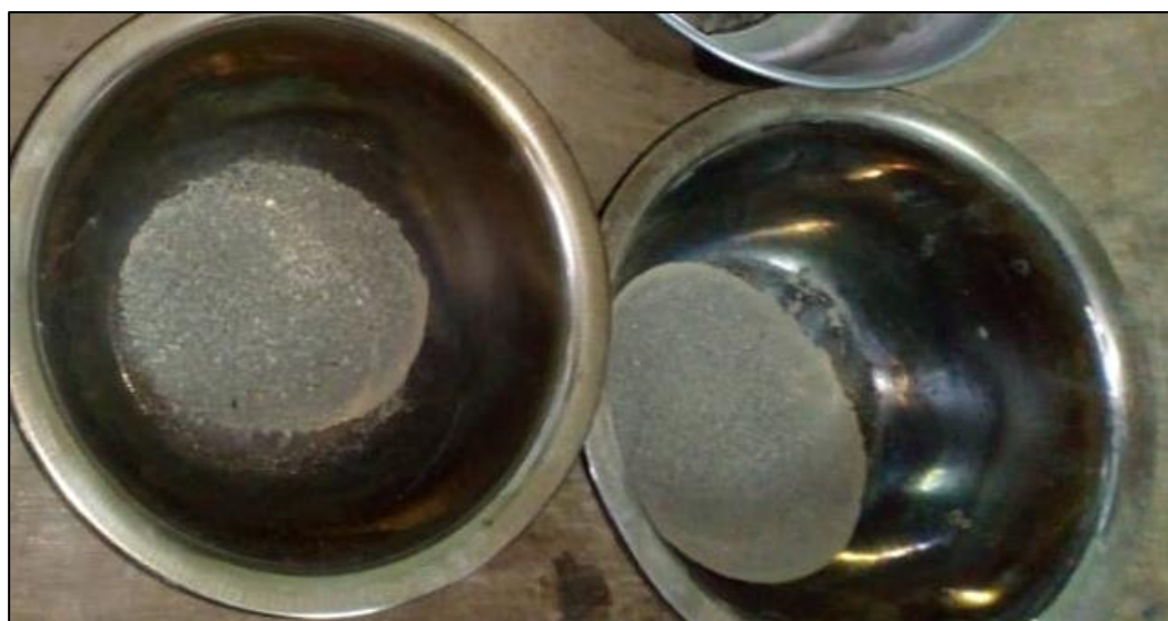
Ilustración N°4.29: Registro de finos en muestra C-01 - ensayo granulometría por tamizado. Fuente: Propia
