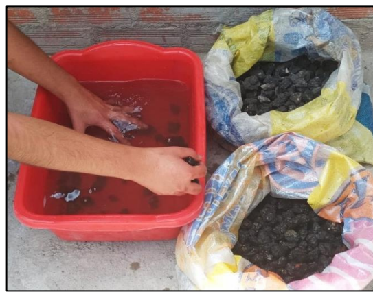
Figura 33: Lavado del material disgregado. Fuente: Propia
