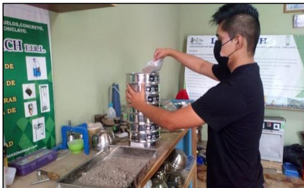
Figura 20: Ensayo granulometría por tamizado. Fuente: Propia
