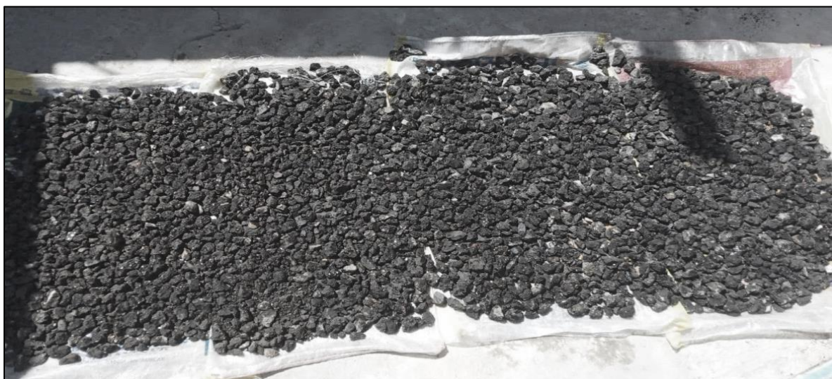
Ilustración N°4.14: Secado de muestra 02 de agregados de carpetas asfálticas tratados. Fuente: Propia
