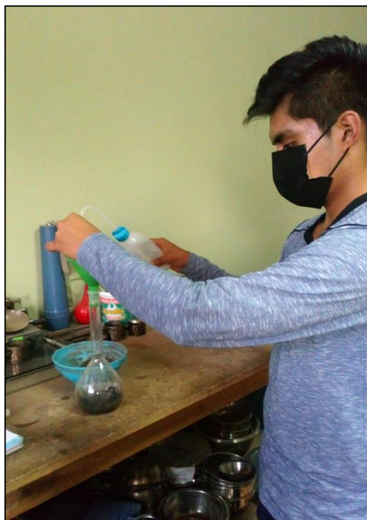
Ilustración N°4.32: Preparación de muestras natural C-01 – ensayo densidad específica. Fuente: Propia
