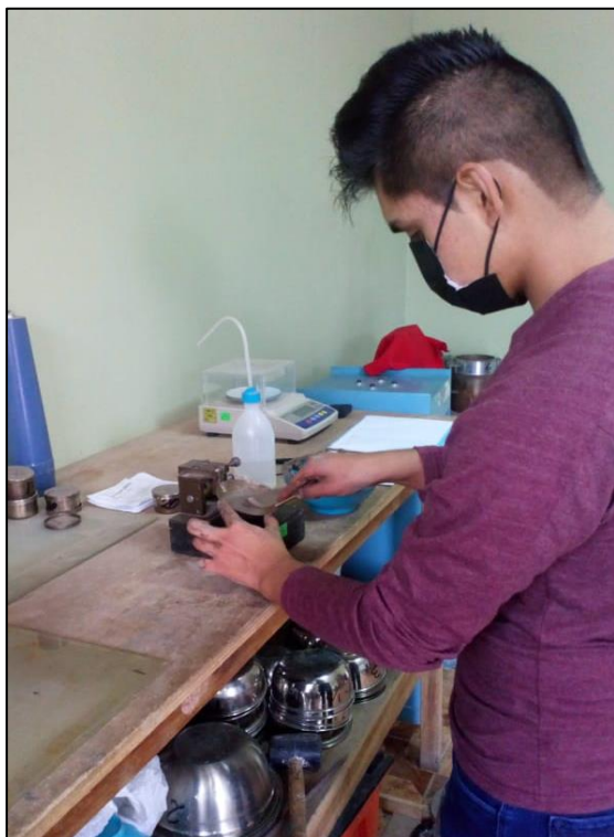
Ilustración N°4.34: Colocación de muestra natural C-01 en cuchara de Casagrande – ensayo limite líquido. Fuente: Propia
