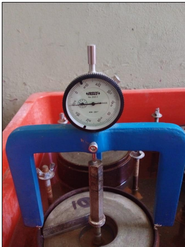
Ilustración N°4.46: Registro de expansión en muestra experimental C-01 (1) – ensayo de CBR. Fuente: Propia
