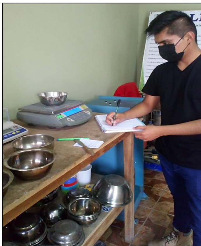
Ilustración N°4.27: Registro de peso final muestra C-01 - ensayo de humedad natural. Fuente: Propia
