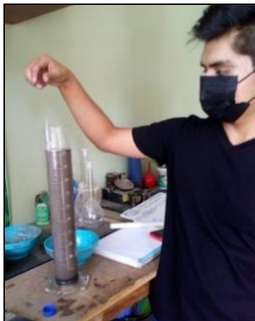
Figura 21: Ensayo granulometría por Hidrómetro. Fuente: Propia
