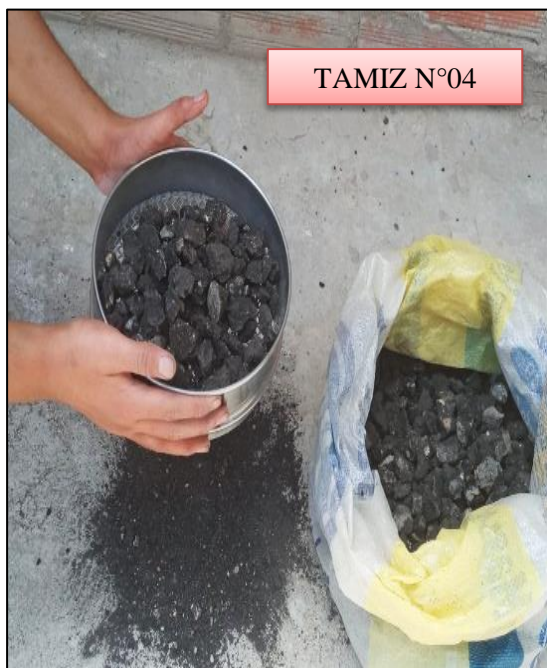
Ilustración N°4.11: Tamizado de agregados reciclados por el tamiz No 04. Fuente: Propia
