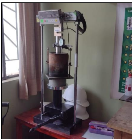
Figura 25: Ensayo de CBR. Fuente: Propia
