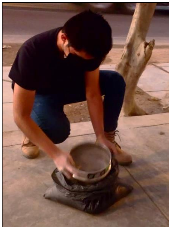
Figura 44: Tamizado de cenizas obtenidas. Fuente: Propia
