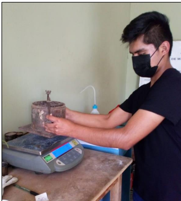
Ilustración N°4.44: Registro del peso de muestra compactada C-01 (1) – ensayo Proctor. Fuente: Propia
