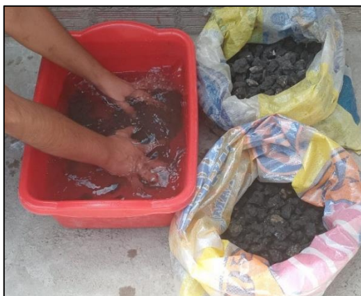
Figura 33: Lavado del material disgregado. Fuente: Propia
