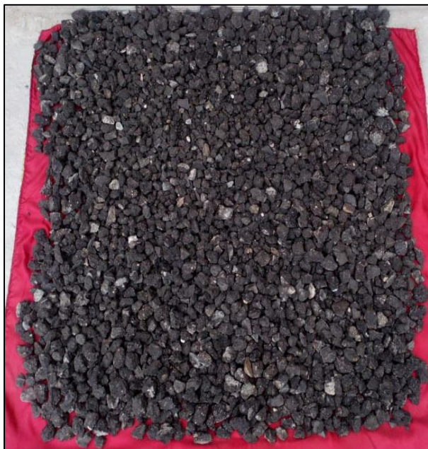
Ilustración N°4.16: Secado de muestra 04 y 05 de agregados de carpetas asfálticas tratados. Fuente: Propia
