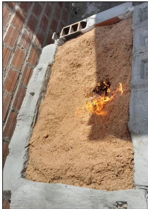
Figura 41: Encendido del aserrín con apoyo de viruta y fósforos de cocina. Fuente: Propia
