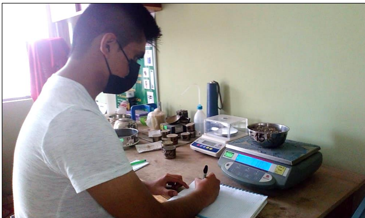
Ilustración N°4.25: Registro de peso inicial muestra natural C-01 - ensayo de humedad natural. Fuente: Propia
