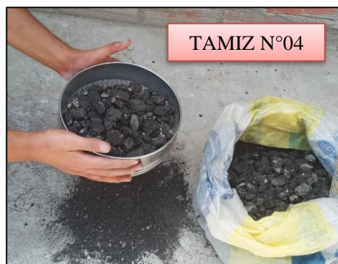
Figura 32: Tamizado de agregados reciclados por la malla N°04. Fuente: Propia
