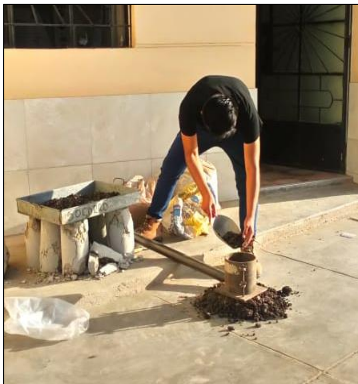
Ilustración N°4.42: Llenado de molde de compactación con muestra C-01 (1) – ensayo Proctor. Fuente: Propia
