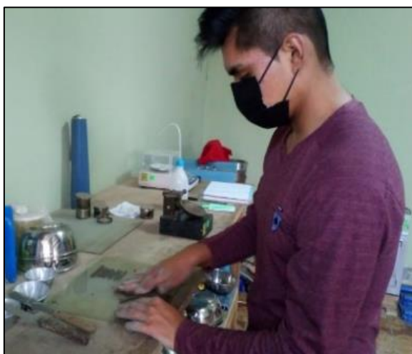
Figura 23: Ensayo límite plástico. Fuente: Propia
