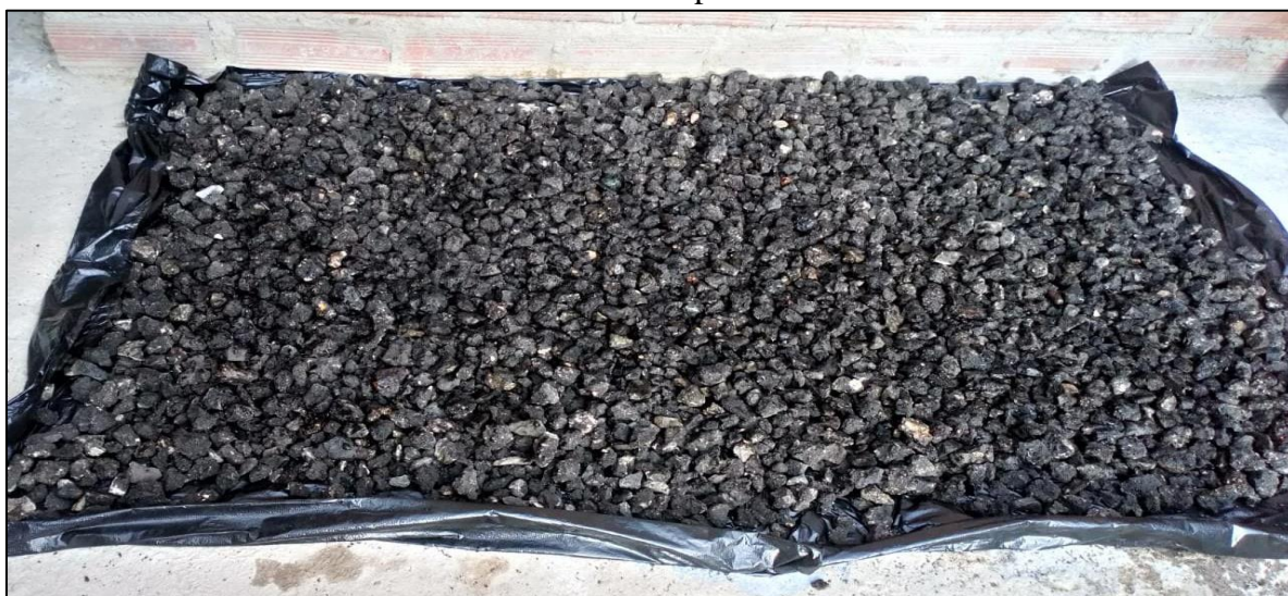
Ilustración N°4.14: Secado de muestra 02 de agregados de carpetas asfálticas tratados. Fuente: Propia
