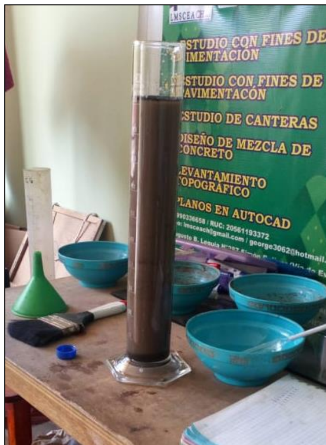
Ilustración N°4.30: Preparación de muestra natural C-01 – ensayo granulometría por sedimentación. Fuente: Propia
