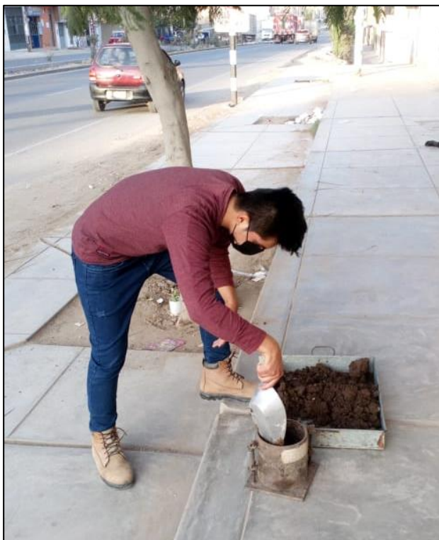
Ilustración N°4.38: Llenado de molde de compactación con muestra natural C-01 – ensayo Proctor Fuente: Propia
