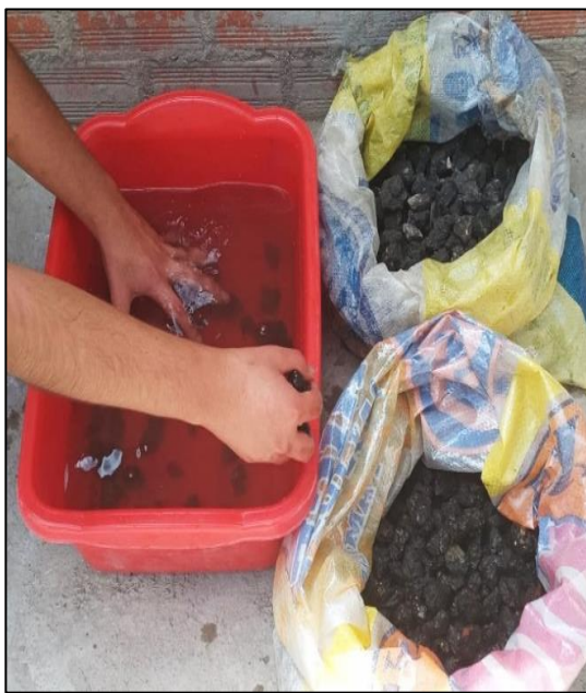
Ilustración N°4.12: Lavado de agregados reciclados. Fuente: Propia
