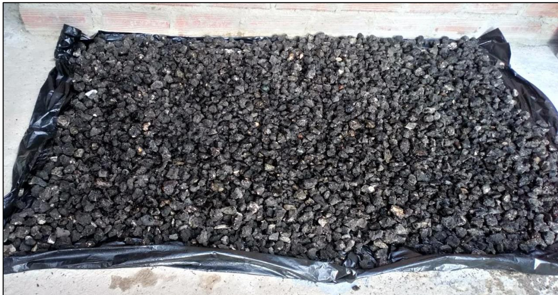
Figura 34: Secado de agregados reciclados al aire libre (mayor detalle en anexo 04). Fuente: Propia
