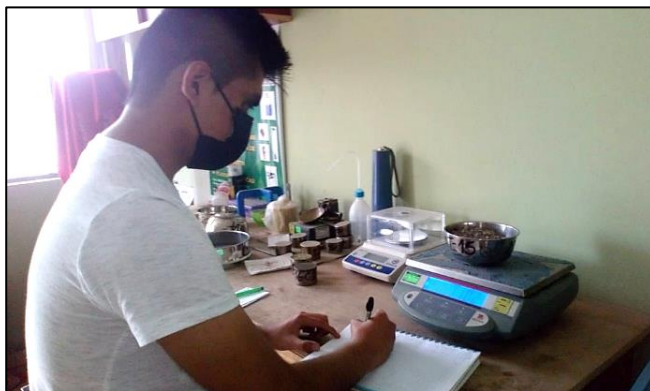
Figura 19: Ensayo de humedad. Fuente: Propia
