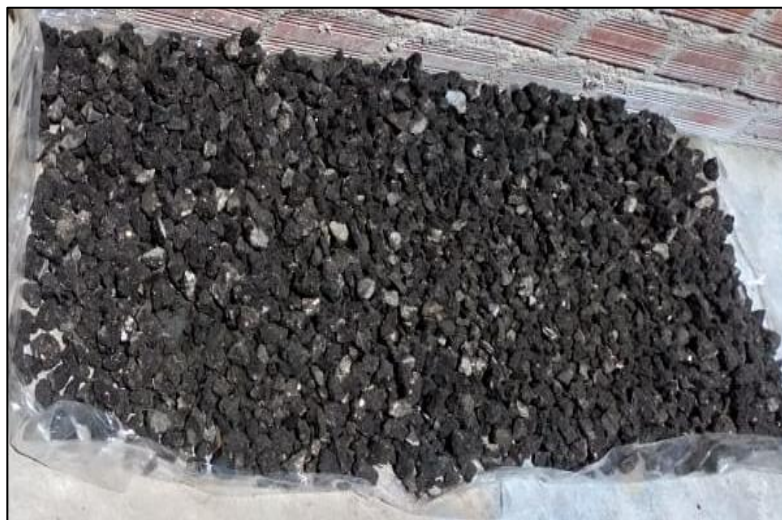
Ilustración N°4.16: Secado de muestra 04 y 05 de agregados de carpetas asfálticas tratados. Fuente: Propia
