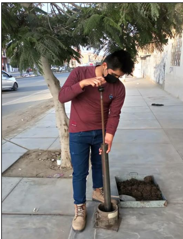
Ilustración N°4.39: Compactación de muestra natural C-01 – ensayo Proctor Fuente: Propia
