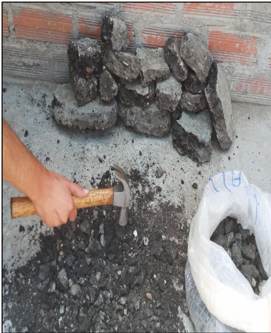
Ilustración N°4.9: Disgregado de carpetas asfálticas. Fuente: Propia
