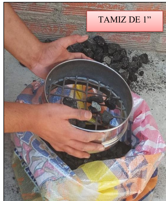
Ilustración N°4.10: Tamizado de agregados reciclados por el tamiz de 1". Fuente: Propia
