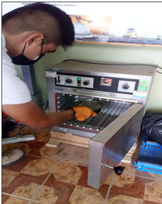
Ilustración N°4.26: Colocación de muestra C-01 al horno - ensayo de humedad natural. Fuente: Propia
