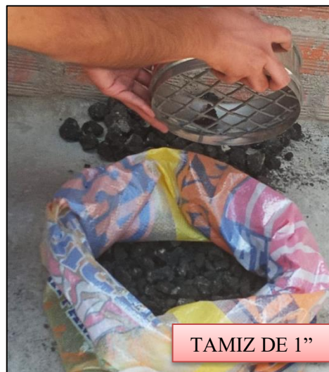
Figura 31: Tamizado de agregados reciclados por la malla de 1". Fuente: Propia
