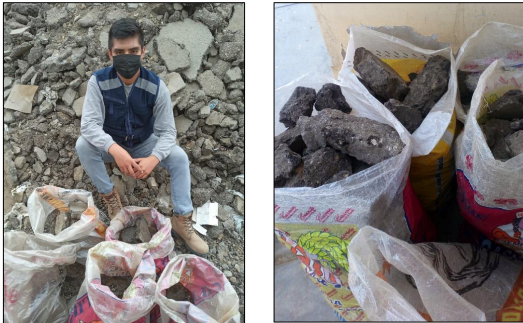
Figura 29: Recolección de carpetas asfálticas. Fuente: Propia
