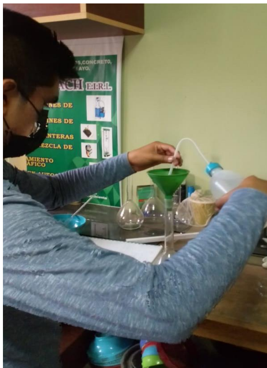
Ilustración N°4.32: Preparación de muestras natural C-01 – ensayo densidad específica. Fuente: Propia
