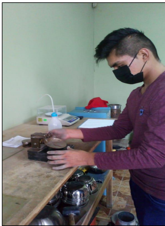
Ilustración N°4.34: Colocación de muestra natural C-01 en cuchara de Casagrande – ensayo limite líquido. Fuente: Propia
