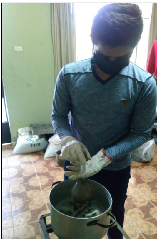
Ilustración N°4.33: Eliminación de aire en muestra C-01 – ensayo densidad específica. Fuente: Propia
