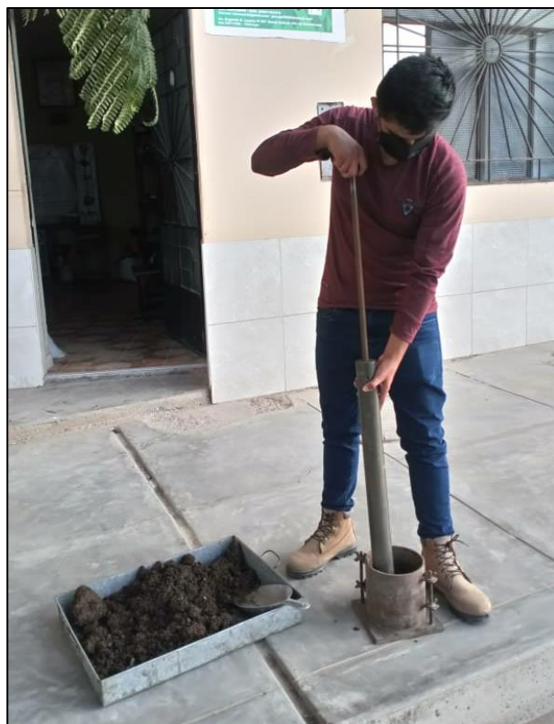
Ilustración N°4.39: Compactación de muestra natural C-01 – ensayo Proctor Fuente: Propia
