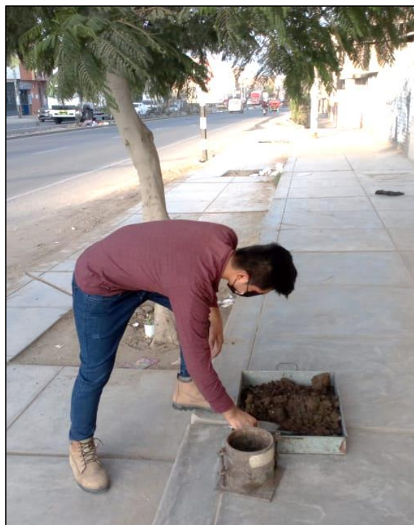
Ilustración N°4.38: Llenado de molde de compactación con muestra natural C-01 – ensayo Proctor Fuente: Propia
