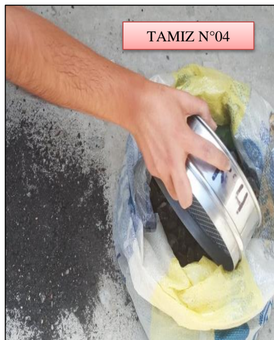
Ilustración N°4.11: Tamizado de agregados reciclados por el tamiz No 04. Fuente: Propia
