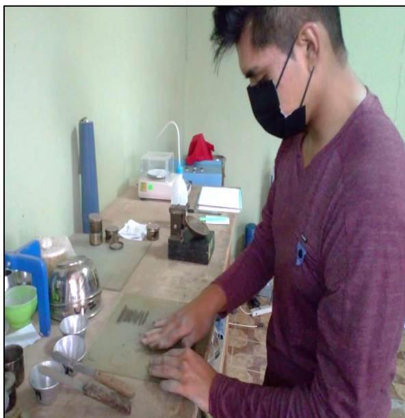
Ilustración N°4.36: Realización de cilindros con muestra natural C-01 – ensayo limite plástico. Fuente: Propia
