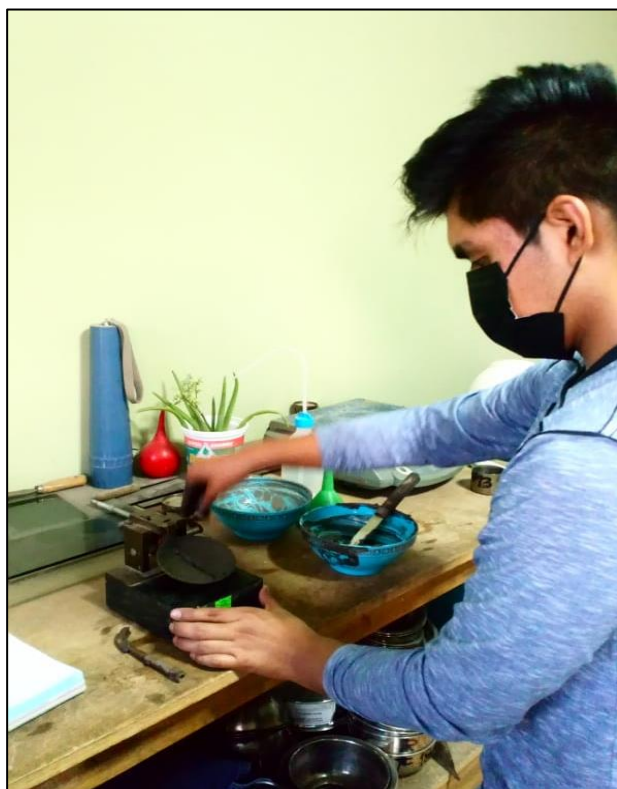
Ilustración N°4.40: Colocación de muestra experimental C-01 (1) en cuchara de Casagrande – ensayo límite líquido. Fuente: Propia
