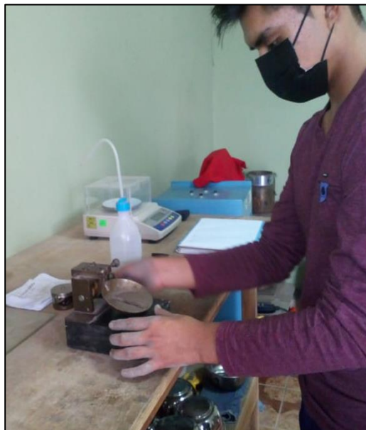
Figura 22: Ensayo límite líquido. Fuente: Propia
