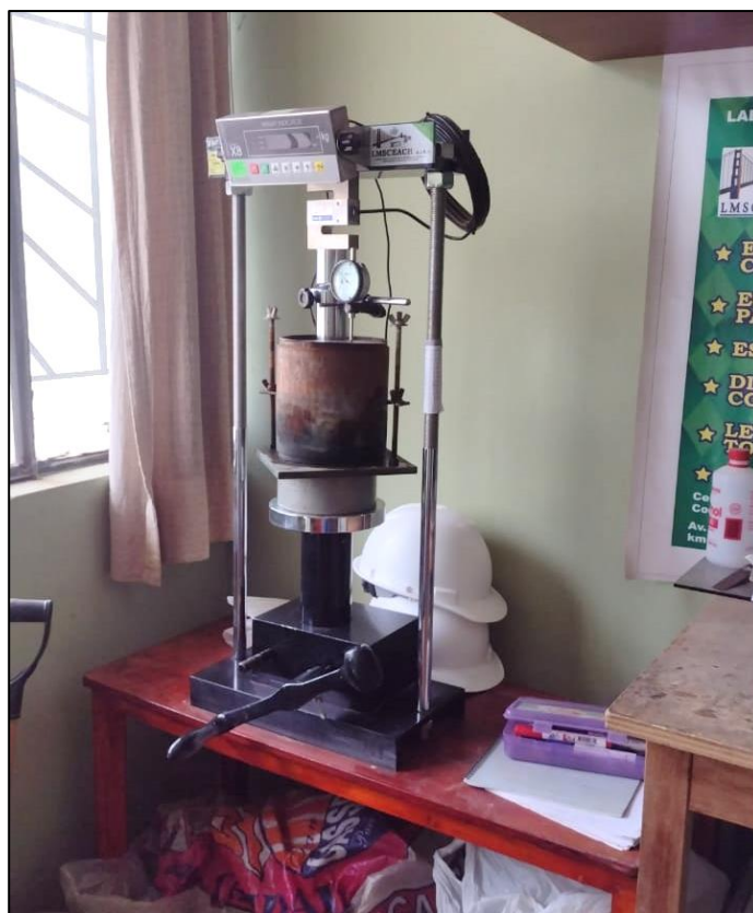
Ilustración N°4.47: Penetración de muestra experimental C-01 (1) – ensayo de CBR. Fuente: Propia
