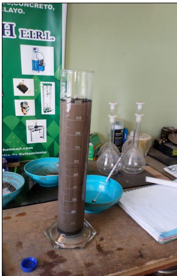
Ilustración N°4.30: Preparación de muestra natural C-01 – ensayo granulometría por sedimentación. Fuente: Propia
