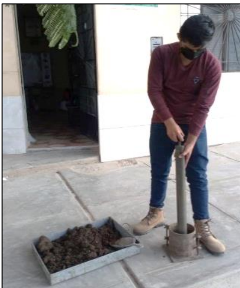
Figura 24: Ensayo Proctor modificado. Fuente: Propia
