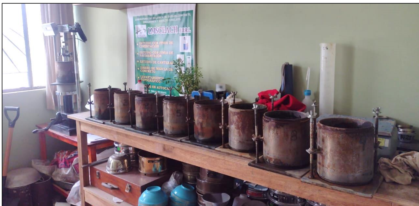
Ilustración N°4.45: Preparación de moldes para muestras experimentales C-01 – ensayo de CBR. Fuente: Propia
