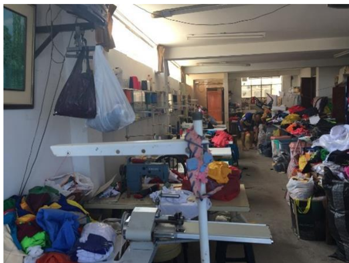
Figura 39: Acumulación de Residuos en los puestos de trabajo
