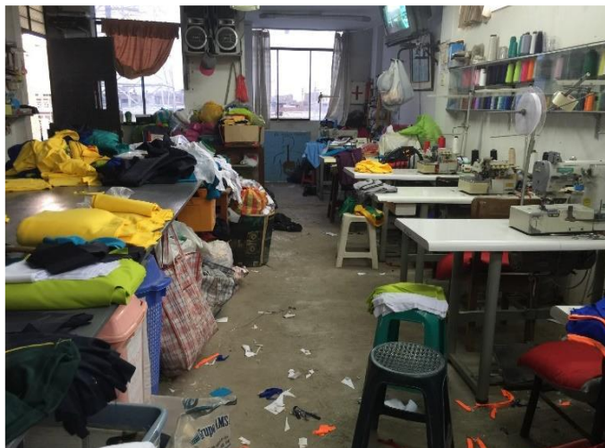
Figura 40: Acumulación de restos sobrantes en los puestos de trabajo Fuente: Elaboración Propia
