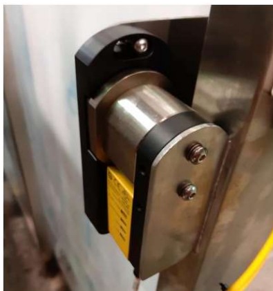
Figura. Montaje de chapa magnética de seguridad para puertas
