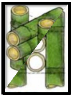
Ilustración 34.- Viga doble central
