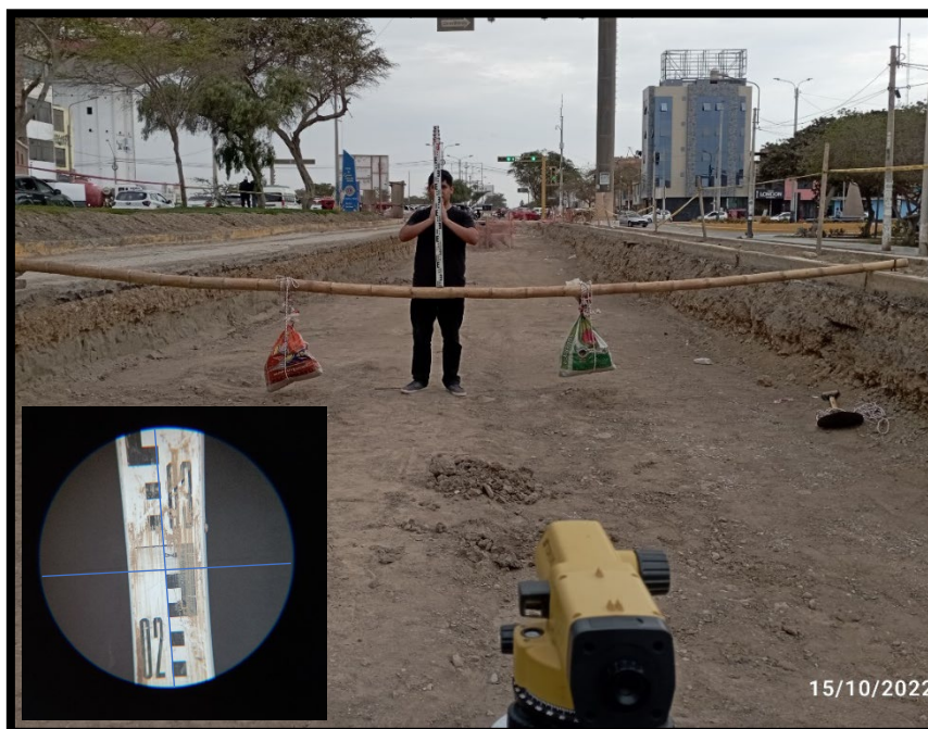
Ilustración 55.- Lectura en ensayo de deflexión con cargas de 50Kg
