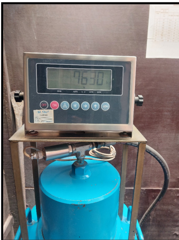
Ilustración 110.- Carga Esfuerzos Últimos para ensayos en Kg-F
