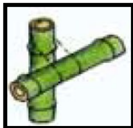
Ilustración 15.- Guadua a Descartar - No emplear Cuerdas desgastadas, elásticas o mal amarradas
