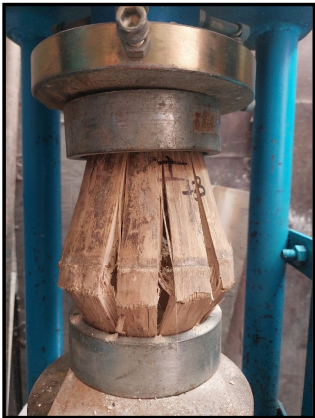
Ilustración 113.- Tipos de falla en culmos a compresión
