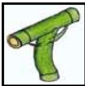
Ilustración 13.- Guadua a Descartar - Guaduas con Florecimiento o tronco muy torcido
