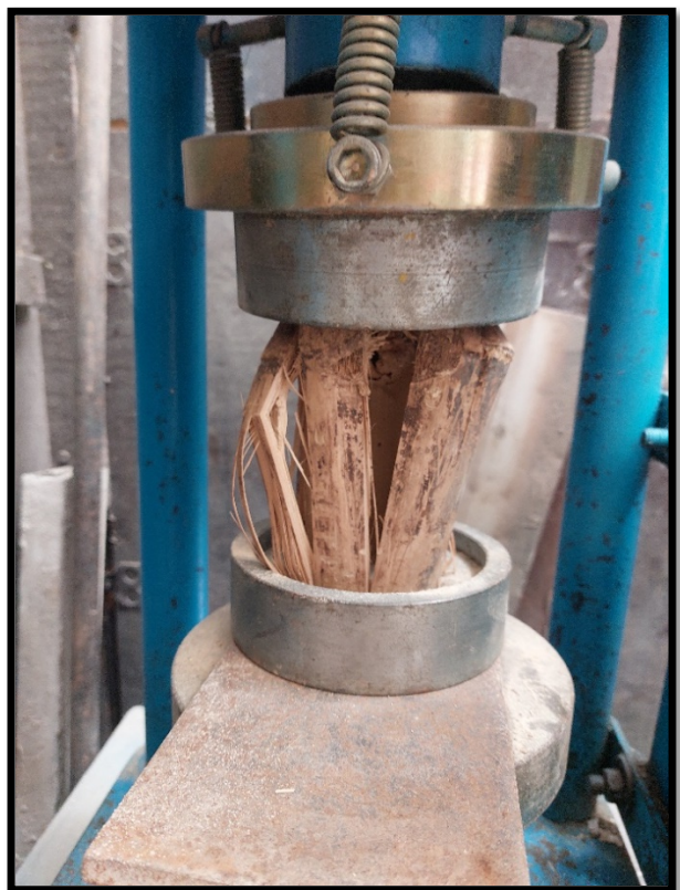
Ilustración 114.- Tipos de falla en culmos a compresión
