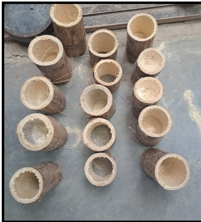
Ilustración 107.- Selección de culmos inferiores, intermedios y superiores para ensayos a compresión
