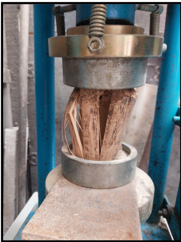
Ilustración 111.- Tipos de falla en culmos a compresión
