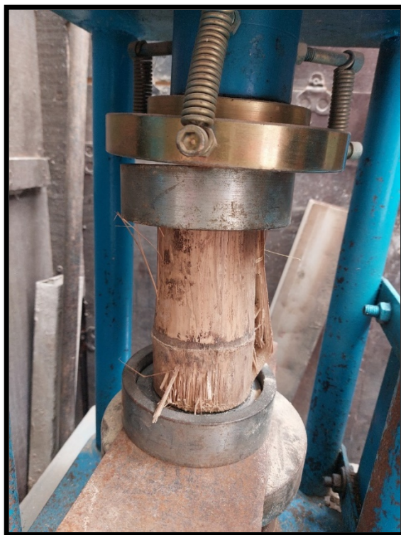
Ilustración 112.- Tipos de falla en culmos a compresión
