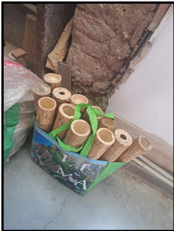
Ilustración 109.- Selección de culmos inferiores, intermedios y superiores para ensayos a flexión
