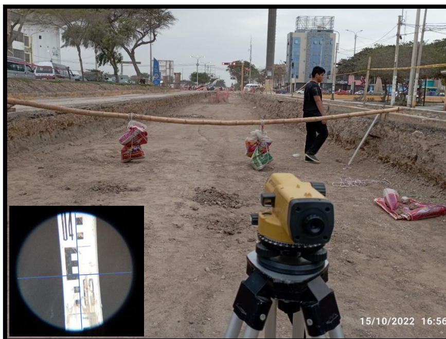
Ilustración 56.- Lectura en ensayo de deflexión con cargas de 100Kg
