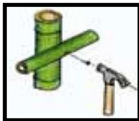
Ilustración 14.- Guadua a Descartar - Vigas clavadas lateralmente a columnas
