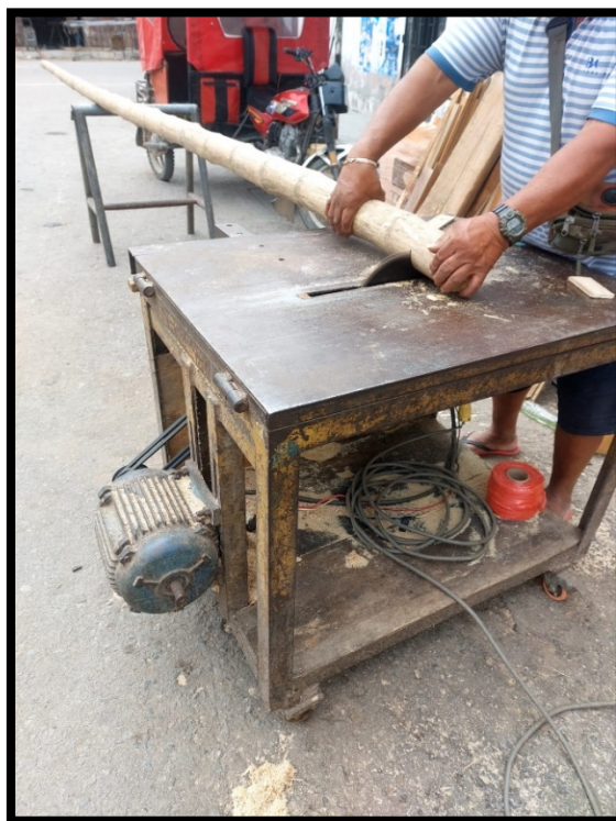
Ilustración 103.- Corte de la barra de bambú en culmos
