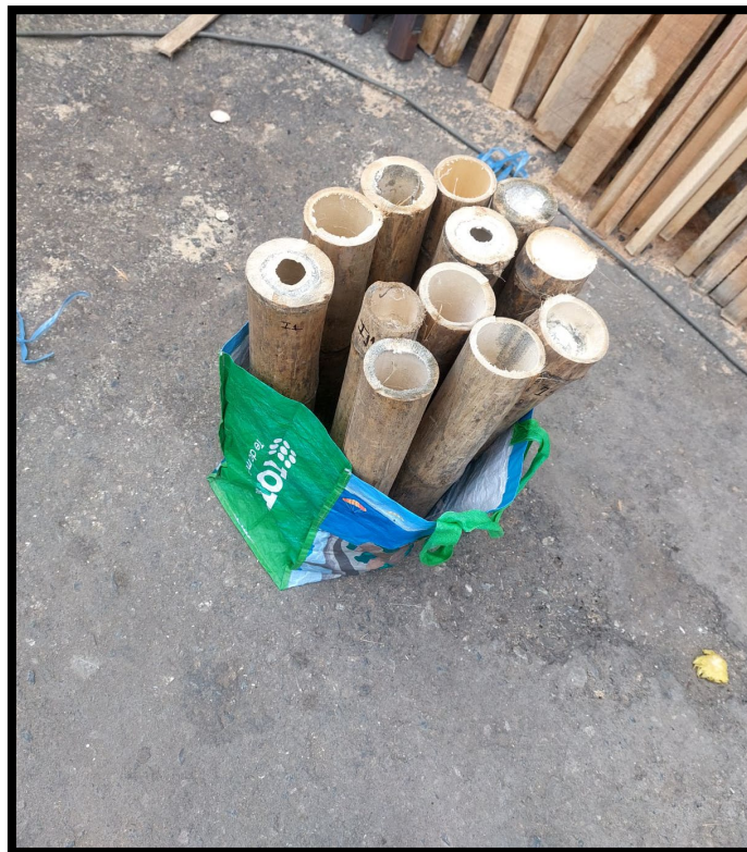
Ilustración 105.- Culmos cortados a medida y rotulados
