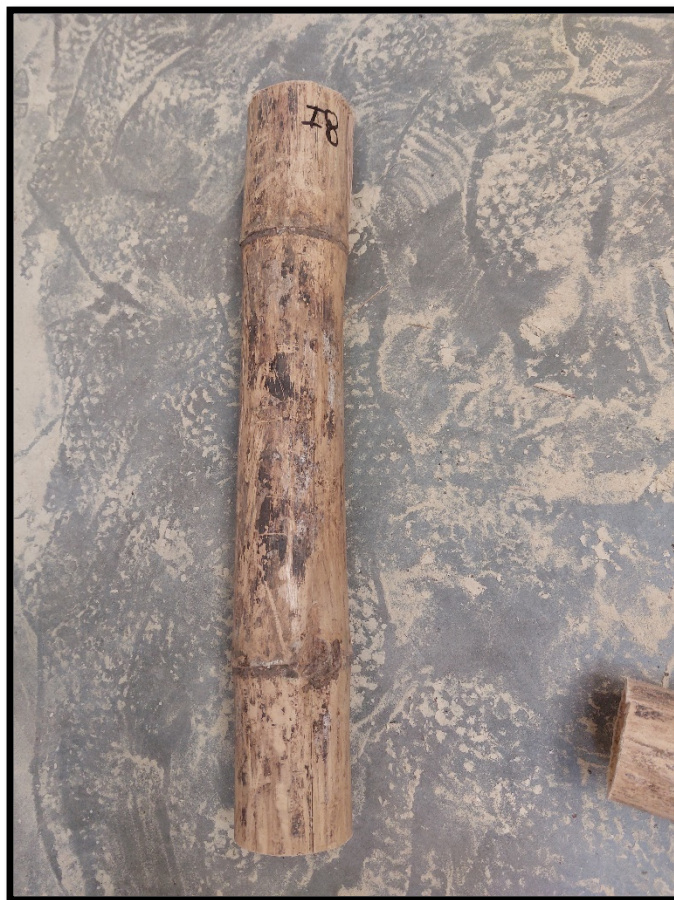
Ilustración 115.- Culmo a Flexión rotulado
