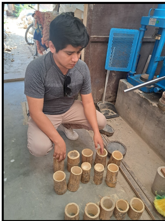
Ilustración 108.- Selección de culmos inferiores, intermedios y superiores para ensayos a corte
