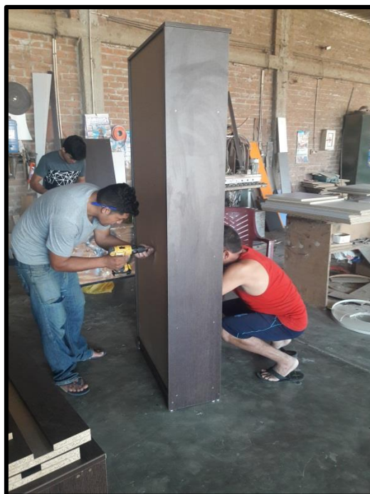
Figura 2. Armado de un Armario de Oficina de 1,6x1x0,4 m
