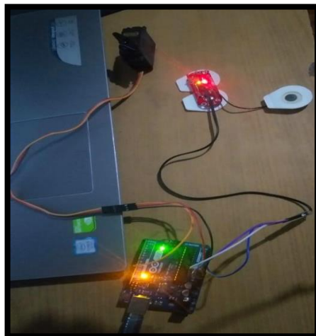
Figura 62. Circuito electrónico con el servomotor Fuente: elaboración propia.
