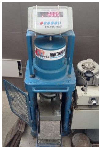
Anexo 51. Módulo de rotura a los 28 días de concreto liviano con 0.10% de nanoplacas (39 kg/cm 2 )
