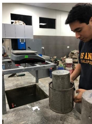
Imagen 18. Acondicionando el ensayo de densidades
