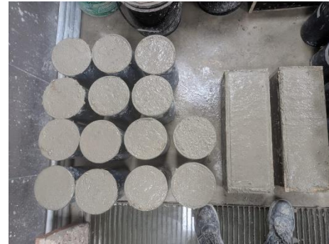
Anexo 22. Vaciado de mezclas de concreto liviano
