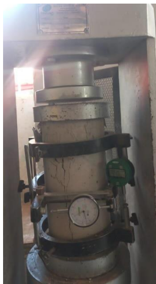
Imagen 15. Módulo de Elasticidad y Poisson a los 28 días de concreto liviano patrón.
