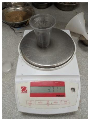
Anexo 18. Peso nanoplacas para mezcla de 0.15%
