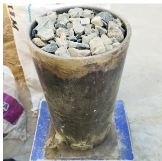
Imagen 9. Muestra de piedra para peso unitario suelto
