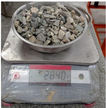
Anexo 7. Peso agregado grueso humedo
