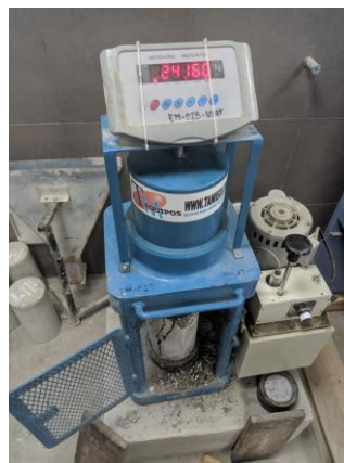
Anexo 36. Resistencia a la compresión de concreto liviano a los 7 días con 0.15% de nanoplacas (139 kg/cm 2 )
