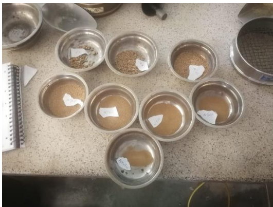
Imagen 2. Muestras de granulometría de arena
