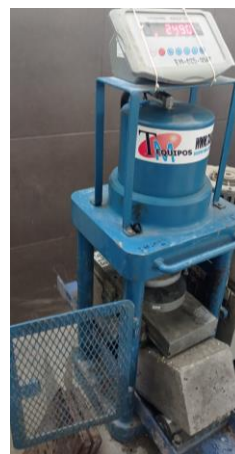
Anexo 52. Módulo de rotura a los 28 días de concreto liviano con 0.15% de nanoplacas (34 kg/cm 2 )
