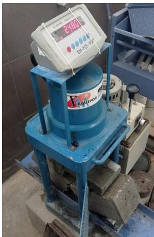
Imagen 16. Resistencia a la flexión a los 28 días de concreto con 0.15% de nanoplacas
