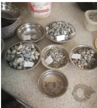
Imagen 1. Muestras de granulometría de piedra
