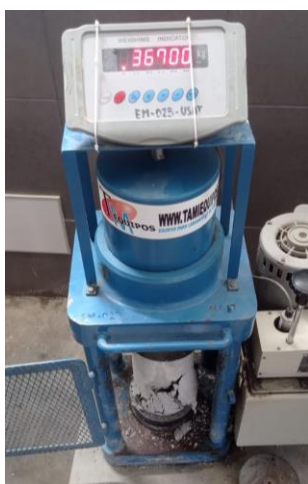
Anexo 41. Resistencia a la compresión a los 28 días de concreto liviano patrón (210 kg/cm 2 )
