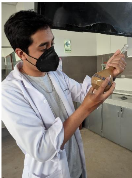
Imagen 4. Agitación de fiola para hallar el peso específico de la arena
