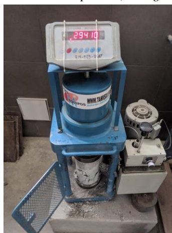
Anexo 40. Resistencia a la compresión de concreto liviano a los 14 días con 0.15% de nanoplacas (166 kg/cm 2 )
