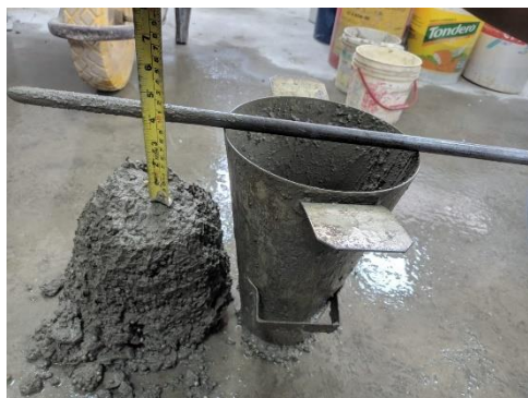
Anexo 27. Slump de concreto liviano con 0.05% nanoplastas
