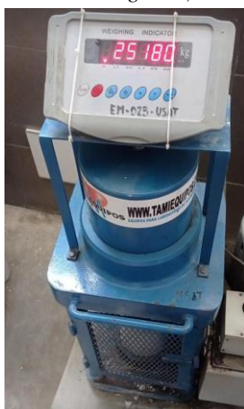
Anexo 35. Resistencia a la compresión de concreto liviano a los 7 días con 0.10% de nanoplacas (158 kg/cm 2 )
