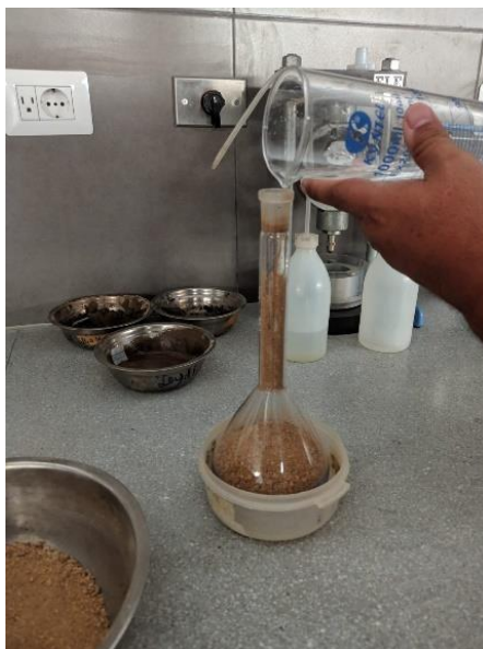
Imagen 6. Añadido de agua a fiola con arena
