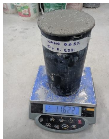
Anexo 30. Peso unitario de concreto con 0.05% de nanoplastas en estado fresco
