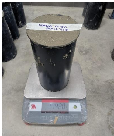
Anexo 32. Peso unitario de concreto liviano con 0.15% de nanoplacas en estado fresco
