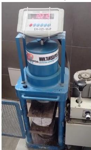
Anexo 45. Resistencia a la tracción a los 28 días de concreto liviano patrón (14 kg/cm 2 )
