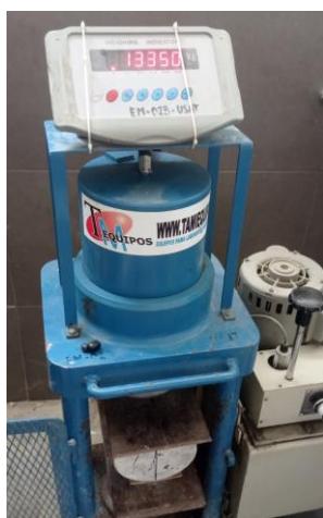
Anexo 47. Resistencia a la tracción de concreto liviano a los 28 días con 0.10% de nanoplacas (19 kg/cm 2 )
