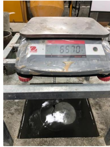
Anexo 58. Peso cilindro con 0.05% de nanoplacas saturado superficialmente seco (10.98 kg)
