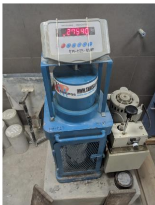
Anexo 35. Resistencia a la compresión de concreto liviano a los 7 días con 0.10% de nanoplacas (158 kg/cm 2 )
