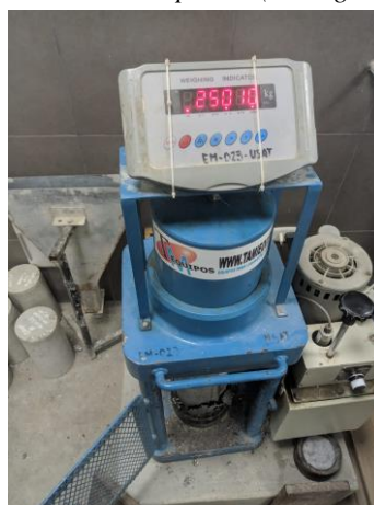
Anexo 36. Resistencia a la compresión de concreto liviano a los 7 días con 0.15% de nanoplacas (139 kg/cm 2 )
