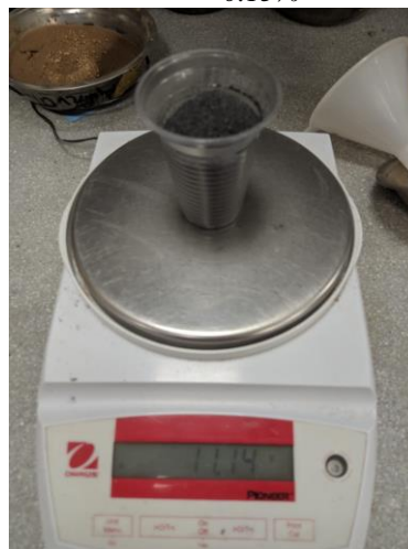
Anexo 18. Peso nanoplacas para mezcla de 0.15%
