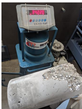
Anexo 39. Resistencia a la compresión de concreto liviano a los 14 días con 0.10% de nanoplacas (194 kg/cm 2 )
