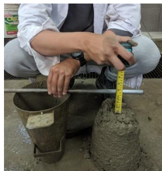
Anexo 28. Slump de concreto liviano con 0.10% de nanoplastas
