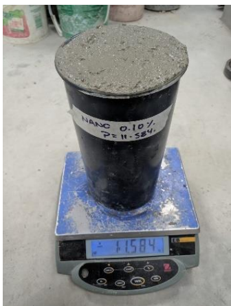
Anexo 31. Peso unitario de concreto liviano con 0.10% de nanoplacas en estado fresco
