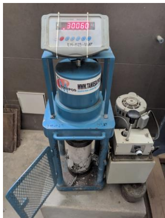
Anexo 39. Resistencia a la compresión de concreto liviano a los 14 días con 0.10% de nanoplacas (194 kg/cm 2 )
