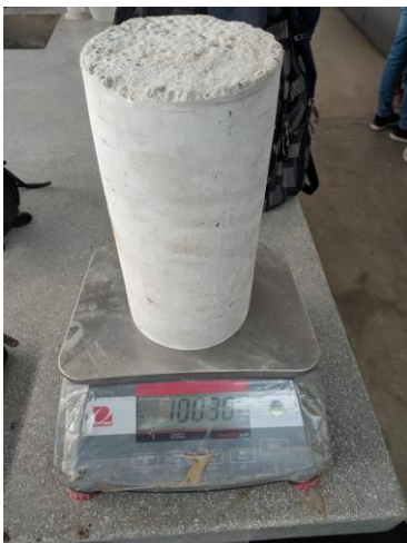
Anexo 59. Peso cilindro con 0.05% de nanoplacas seco al horno (10.04 kg)
