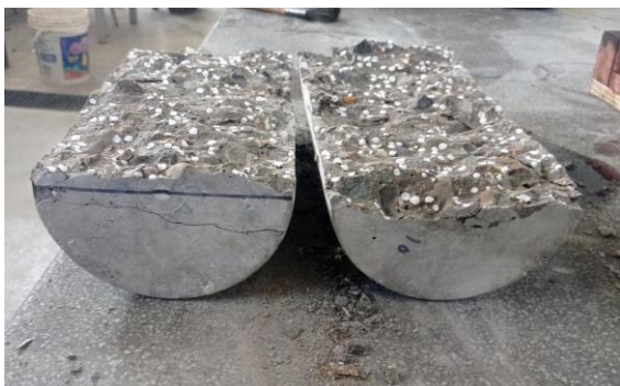
Anexo 65. Rotura de cilindros por tracción de concreto liviano con 0.10% de nanoplacas
