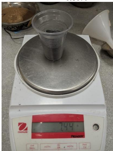
Anexo 17. Peso nanoplacas para mezcla de 0.10%
