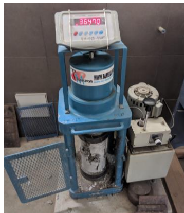
Anexo 44. Resistencia a la compresión de concreto liviano a los 28 días con 0.15% de nanoplacas (209 kg/cm 2 )
