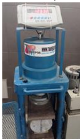
Anexo 46. Resistencia a la tracción a los 28 días de concreto liviano con 0.05% de nanoplacas (18 kg/cm 2 )
