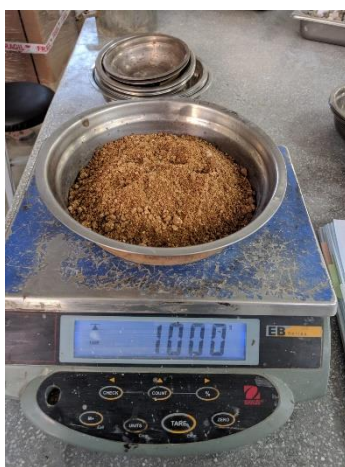
Imagen 7. Muestra de arena para granulometría
