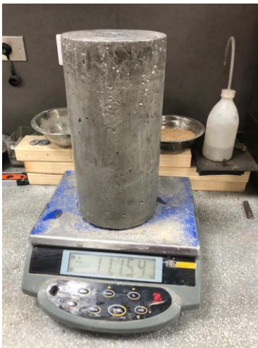
Anexo 59. Peso cilindro con 0.05% de nanoplacas seco al horno (10.04 kg)
