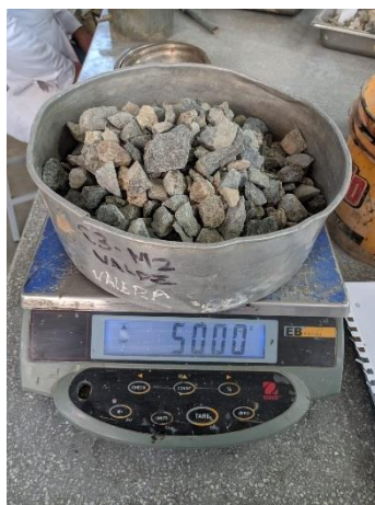
Imagen 8. Muestra de piedra para granulometría
