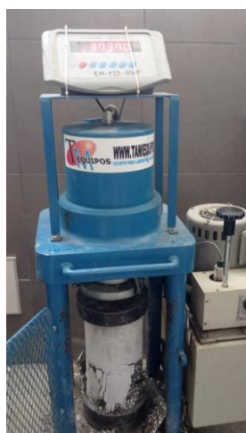
Anexo 42. Resistencia a la compresión a los 28 días de concreto liviano con 0.05% de nanoplacas (214 kg/cm 2 )
