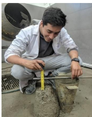
Imagen 12. Slump de mezcla de concreto patrón
