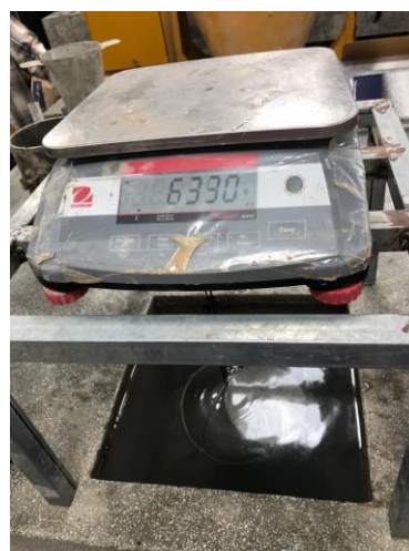
Anexo 54. Peso de cilindro sumergido con adición de 0.05% de nanoplacas (5.45 kg)
