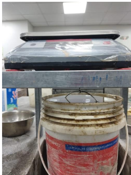
Imagen 3. Determinación del peso sumergido de la piedra
