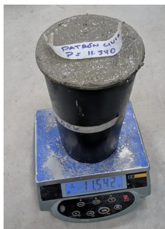
Anexo 29. Peso unitario de concreto patrón liviano en estado fresco
