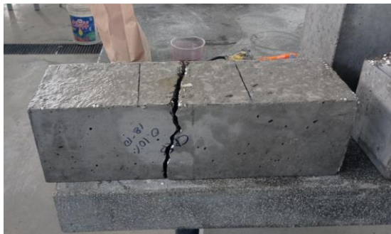
Anexo 61. Rotura de viga de concreto liviano con adición de 0.10% de nanoplacas
