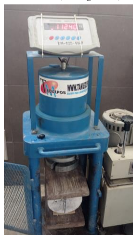
Anexo 48. Resistencia a la tracción de concreto liviano a los 28 días con 0.15% de nanoplacas (16 kg/cm 2 )
