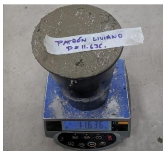
Imagen 13. Peso unitario de concreto liviano patrón
