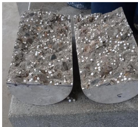
Anexo 66. Rotura de cilindros por tracción de concreto liviano con 0.05% de nanoplacas
