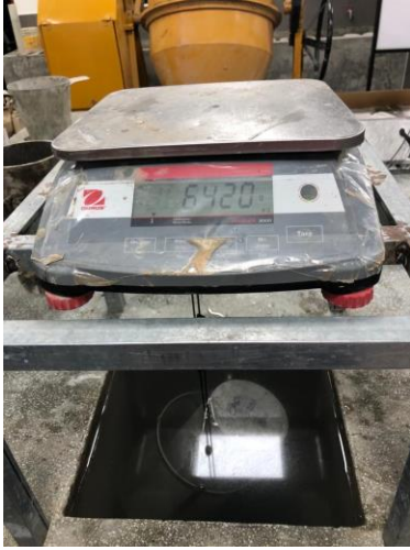
Anexo 57. Peso cilindro patrón saturado superficialmente seco (11.15 kg)
