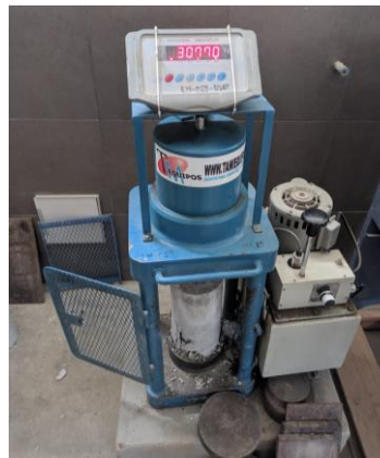
Anexo 38. Resistencia a la compresión a los 14 días de concreto liviano con 0.05% de nanoplacas (174 kg/cm 2 )
