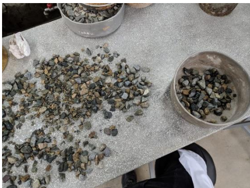
Anexo 5. Oreado de agregado grueso
