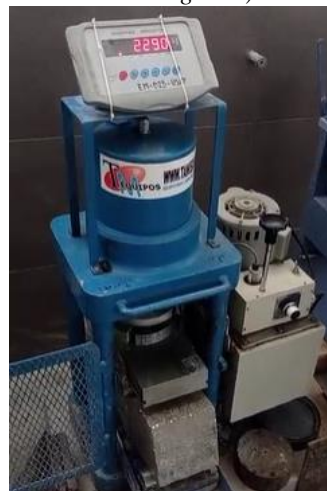
Anexo 54. Peso de cilindro sumergido con adición de 0.05% de nanoplacas (5.45 kg)
