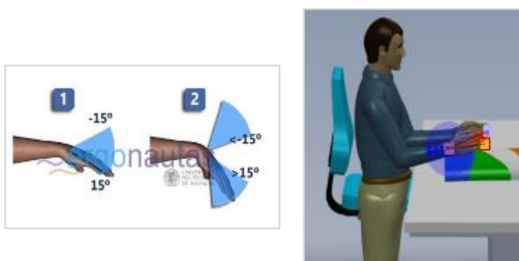
Figura 61. Nueva posición de la muñeca del operario de tendido, trazado y corte
