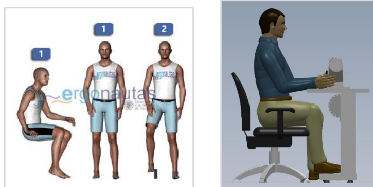
Figura 65. Nueva posición de la piernas del operario de remallado
