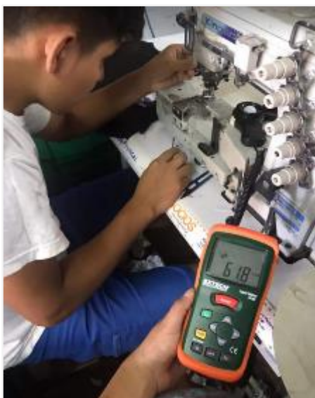
Figura 22. Medición de iluminación
