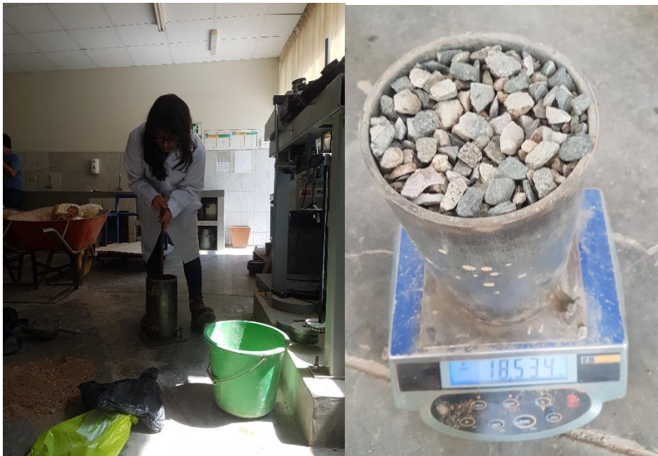
Anexo 31 Peso unitario compactado seco de los agregados
