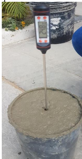
Imagen 15 Temperatura del concreto en estado fresco
