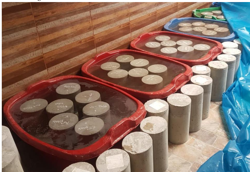
Imagen 18 Curado de muestras cilíndricas de concreto
