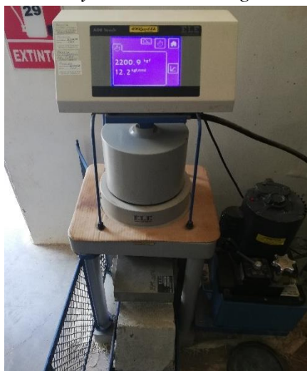
Imagen 20 Ensayo de Flexión- Vigas de concreto
