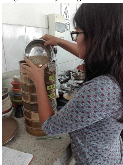
Imagen 7 Ensayo de granulometría
