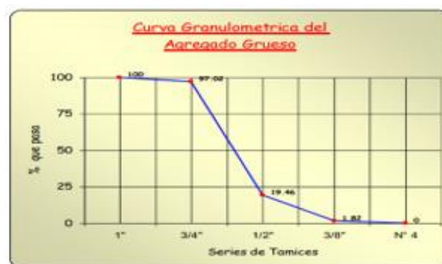
Imagen 5 Curva Granulométrica del agregado grueso
