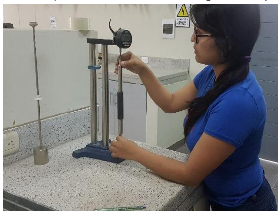
Imagen 22 Ensayo de durabilidad al ataque de sulfatos
