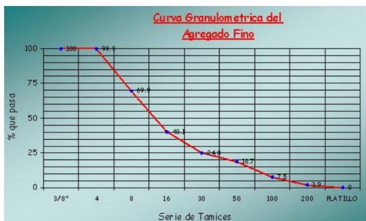
Imagen 6 Curva granulométrica del agregado fino
