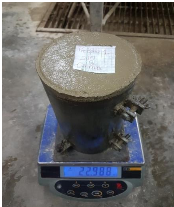
Imagen 16 Peso unitario del concreto en estado fresco
