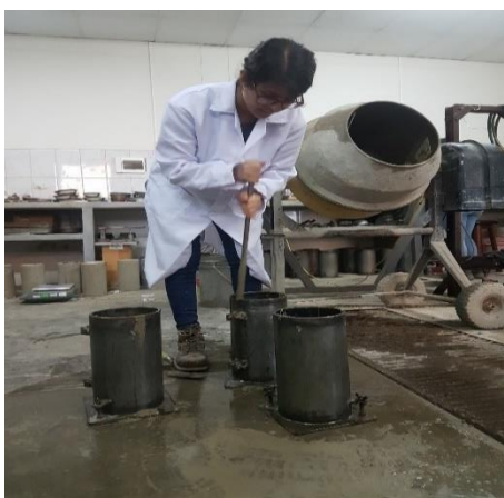
Imagen 12 Elaboración de probetas patrón
