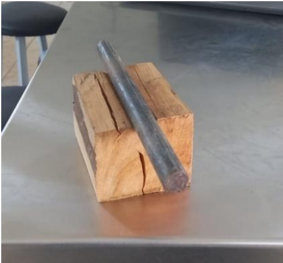
Anexo N° 08: Imagen 15- Falla de la madera a la prueba de tracción
