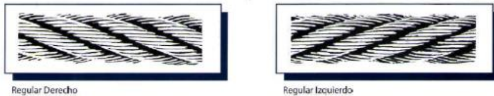
Ilustración 26 - Arrollamiento Regular Fuente: [24]
