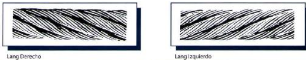
Ilustración 27 - Arrollamiento Lang Fuente: [24]
