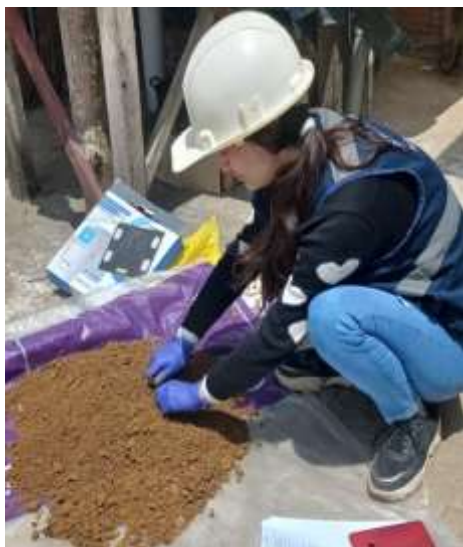
Figura 13: (M-1) en 2 kg; verificando de impurezas.
