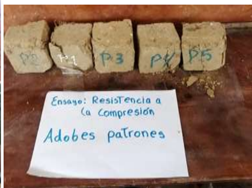
Foto14: Ensayo a compresión de adobes con baba de nopal
