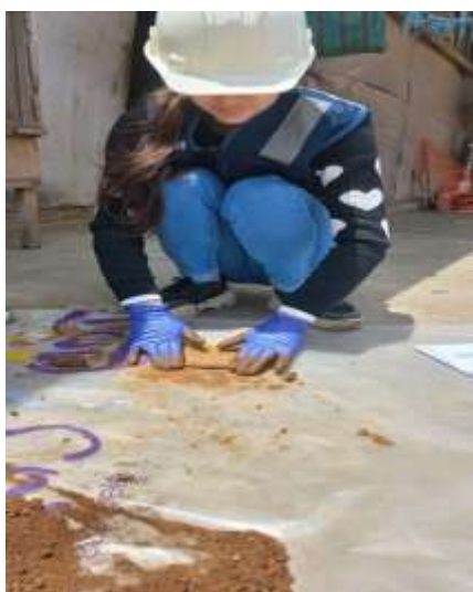
Figura 13: (M-1) en 2 kg; verificando de impurezas.
