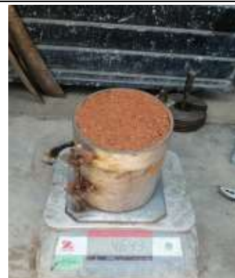
Figura 69: Peso suelto de la muestra RC
