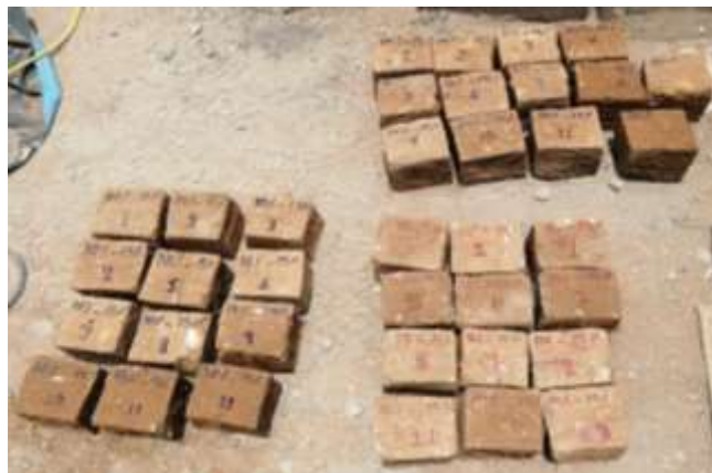
Figura 133: Cubos de adobe con 15% de baba de nopal con 10%, 20% y 30% de RC
