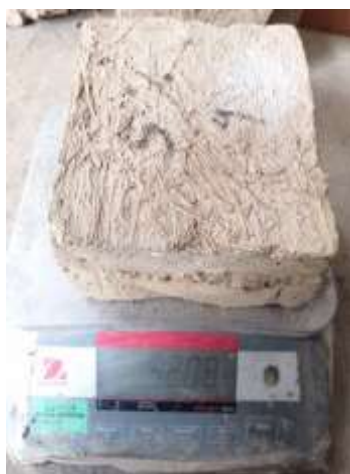
Foto12: Ensayo succión adobes con adobe de nopal y patrones
