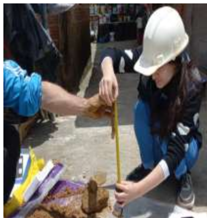
Figura 21: Medida de la cinta de barro M-3
