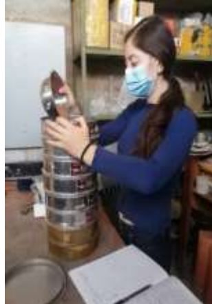
Figura 66: Proceso de tamizado de residuos cerámicos
