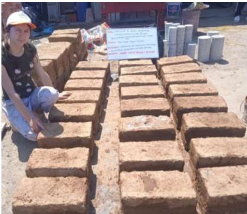
Figura 130: Especímenes de mortero con baba de nopal
