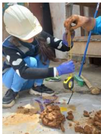
Figura 14: Mezclado con agua para dar trabajabilidad M-1
