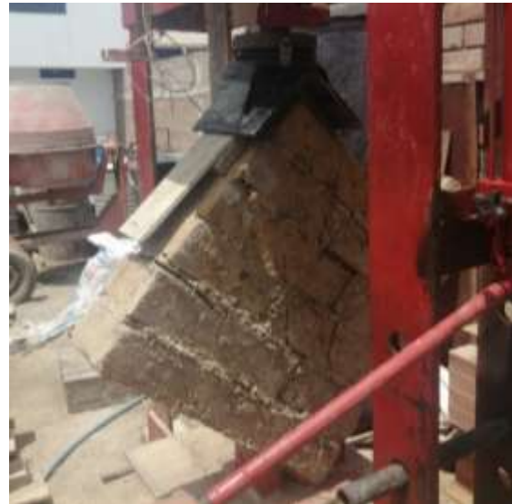
Figura 143: Falla diagonal en murete
