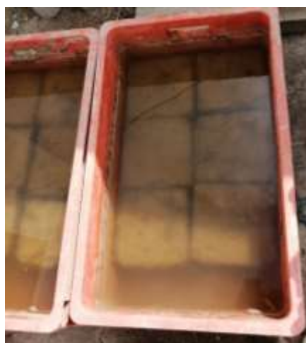
Figura 96: Adobes pasados las 24 horas del ensayo de absorción
