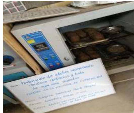
Figura 99: Muestras de cubos de adobes patrones y baba de nopal en horno por 43 horas
