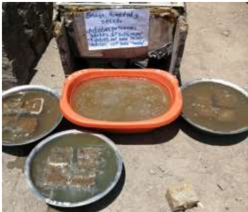
Figura 98: Cubos de adobes patrones y baba de nopal sumergidos en agua por 4 horas
