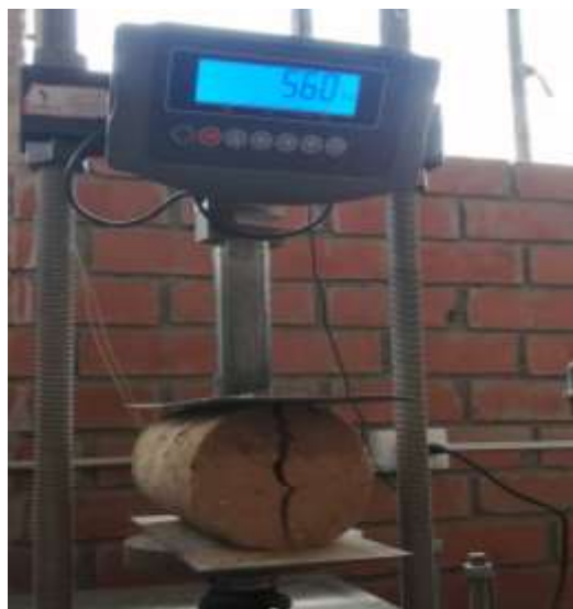
Figura 135:Ensayo brasileño de cilindros de barro
