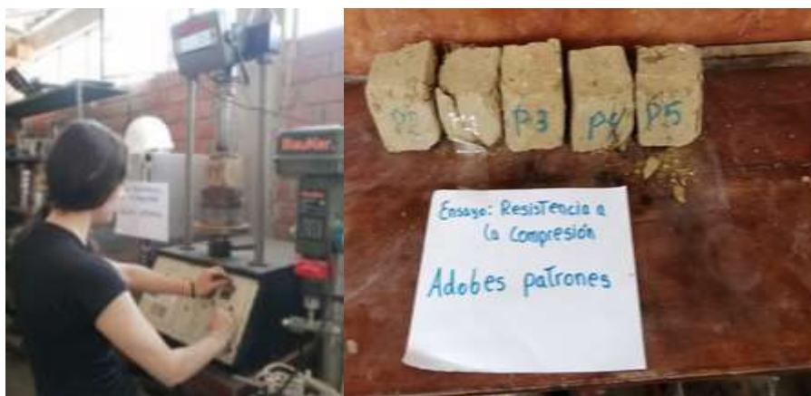
Figura 87: Ensayo de compresión adobes patrones
