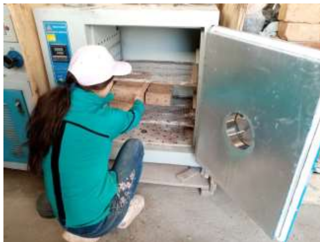
Figura 122: Medias unidades de adobes con baba de nopal más RC al horno
