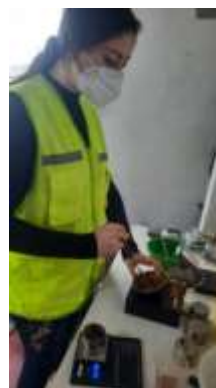
Figura 37: Colocación de la muestra en copa de Casagrande
