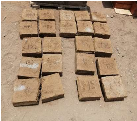
Figura 91: Medias unidades de adobes patrones y con baba de nopal puestas en horno
