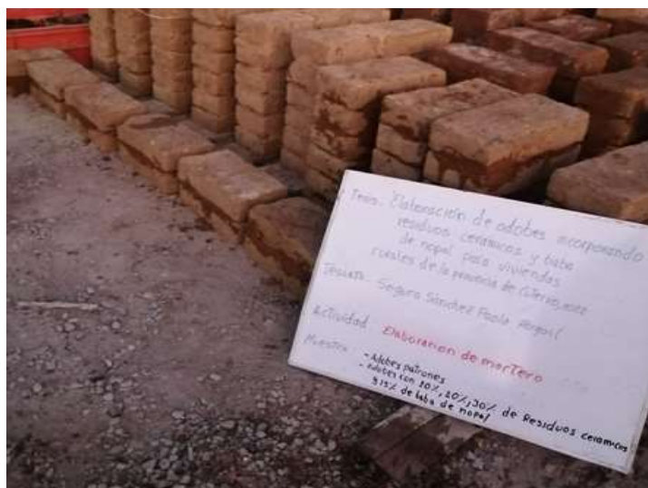
Figura 126: Especimen para ensayo de mortero con adobe patrón
