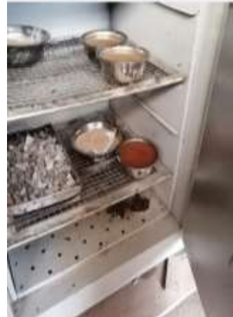
Figura 44: Muestra con agua destilada sacada de la fiola y colocada al horno
