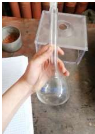
Figura 42: Materiales ensayo peso específico
