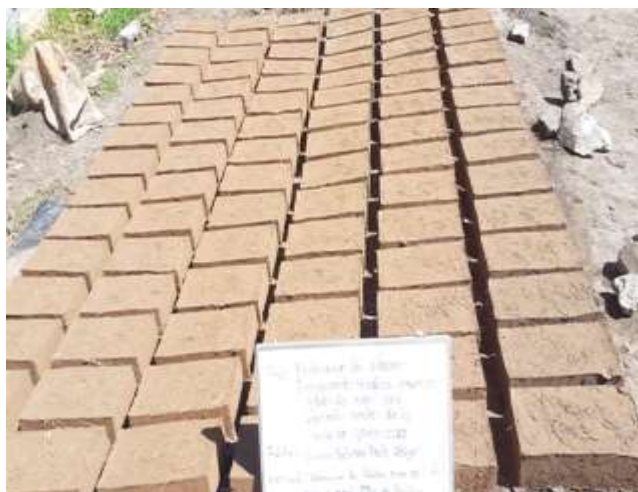
Figura 106: Secado de adobes con 20% de RC y 15% de baba de nopal
