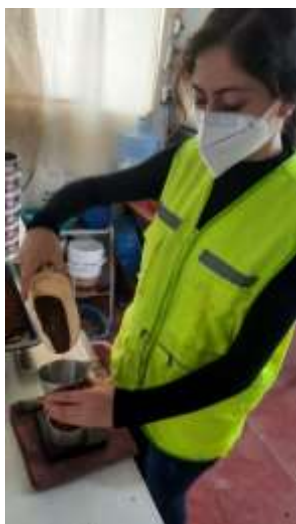
Figura 48: Colocación de 3 capas de la muestra
