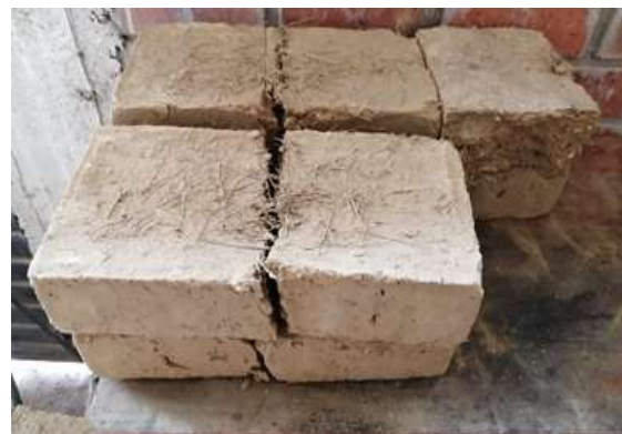
Figura 85: Adobes utilizados para ensayo de compresión
