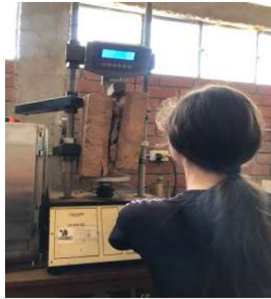
Figura 138: Ensayo de resistencia del mortero con abab de nopal
