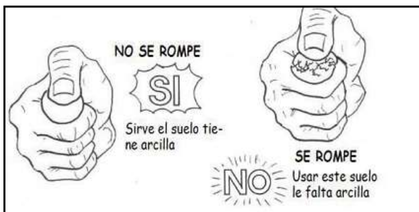
Figura 2: Prueba de aplastamiento de bolitas de tierra Fuente: Norma E080
