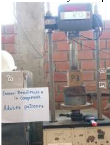
Foto14: Ensayo a compresión de adobes con baba de nopal
