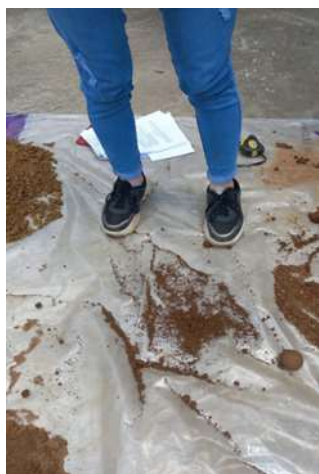
Figura 31: Caída de la bola de la M-1 en el piso
