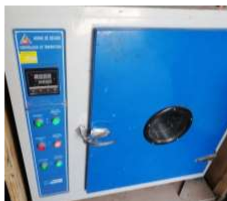
Figura 39: Secado en horno para limites
