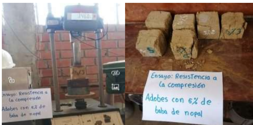
Figura 88: Ensayo de compresión adobes 5% baba de nopal
