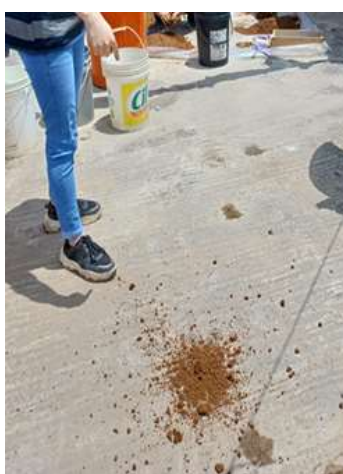
Figura 32: Caída de la bola de la M-2 en el piso
