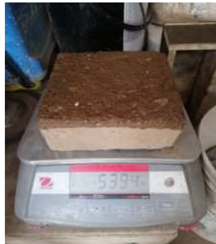
Figura 94: Peso de las unidades luego del ensayo de succión
