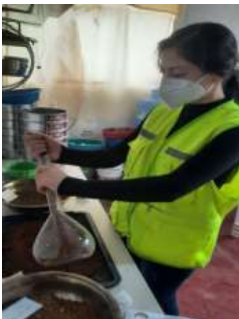
Figura 43: Colocación de la muestra en la fiola
