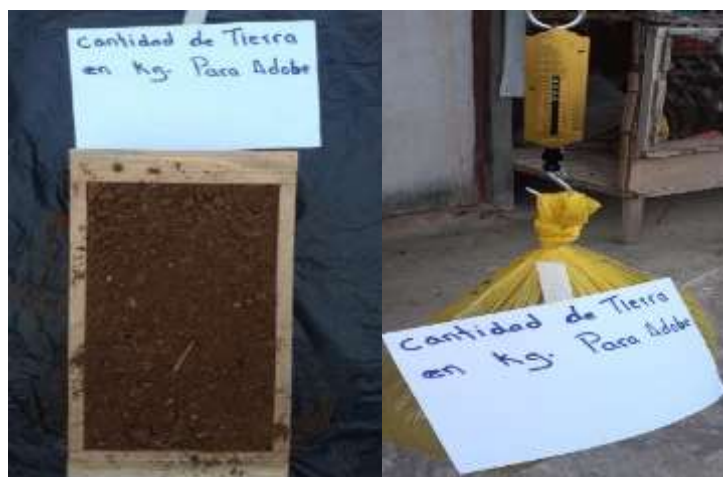
Figura 100: Peso de volumen de la tierra Peso en kg de la tierra suelta = 10kg
