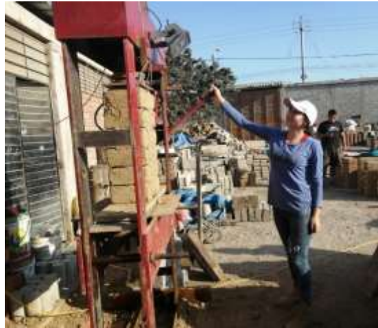
Figura 139:Compresión de pilas de adobe patrones y adobes con 15% de BN más 10%,20% y 30% de baba de nopal
