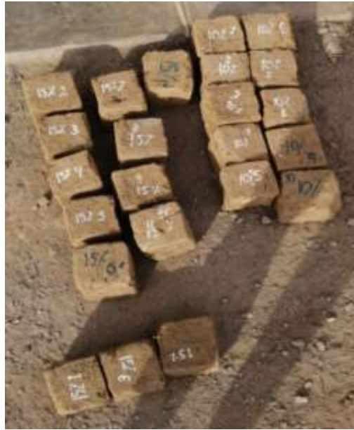
Figura 86: Cubos de adobe cortados para ensayo de compresión
