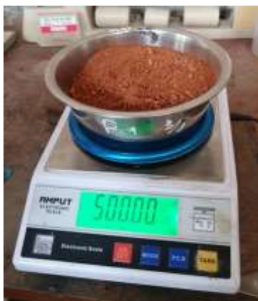
Figura 72: Peso de residuos para ensayo de peso específico
