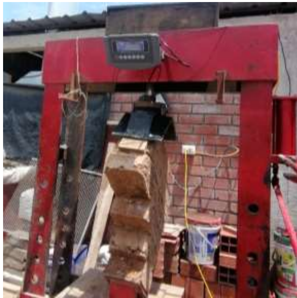
Figura 142: Falla por mortero
