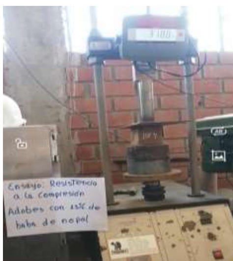
Figura 90: Ensayo de compresión adobes 15% baba de nopal
