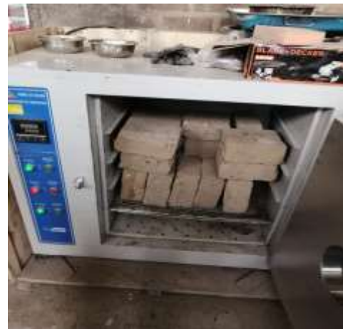
Figura 92: Colocación de unidades patrones y con baba de nopal al horno
