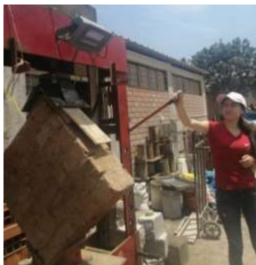
Figura 140:Compresión diagonal de prismas de adobe patrón y con 15% de BN con 10%,20% y 30% de baba de nopal
