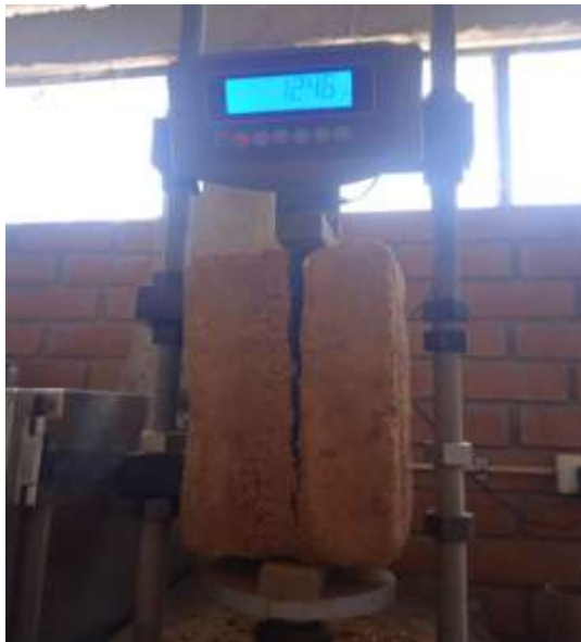
Figura 137: Ensayo de resistencia de mortero en adobes de BN más RC
