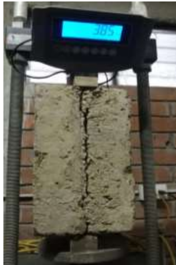
Figura 136: resistencia del mortero a la tracción en adobes patrones
