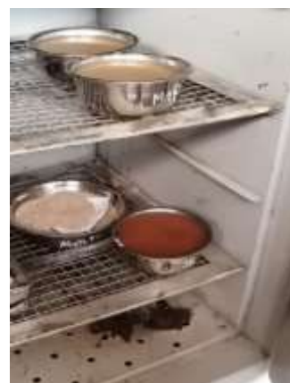
Figura 74: Muestra de peso específico en horno
