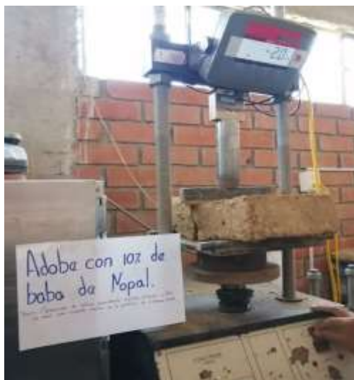
Foto12: Ensayo succión adobes con adobe de nopal y patrones
