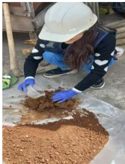
Figura 14: Mezclado con agua para dar trabajabilidad M-1
