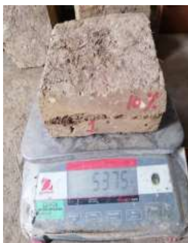
Foto12: Ensayo succión adobes con adobe de nopal y patrones
