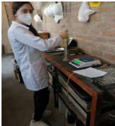
Figura 57: Colocación de la baba de nopal a la probeta
