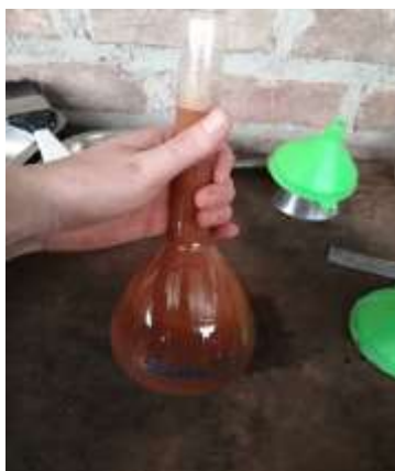
Figura 73: Agitado de la muestra para eliminar vacíos
