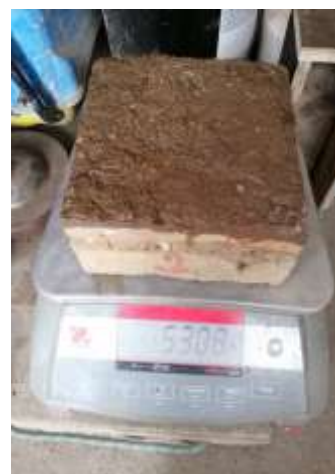
Foto12: Ensayo succión adobes con adobe de nopal y patrones
