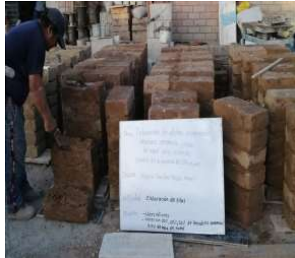
Figura 132: Elaboración de pilas y muretes de adobes patronos y de 15% de baba de nopal y 10%,20% y 30% de RC
