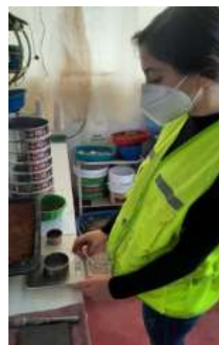
Figura 50: Pesado de la muestra compactada
