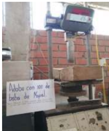
Figura 84: Módulo de ruptura de adobe
