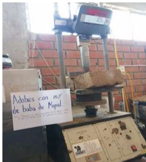
Foto12: Ensayo succión adobes con adobe de nopal y patrones
