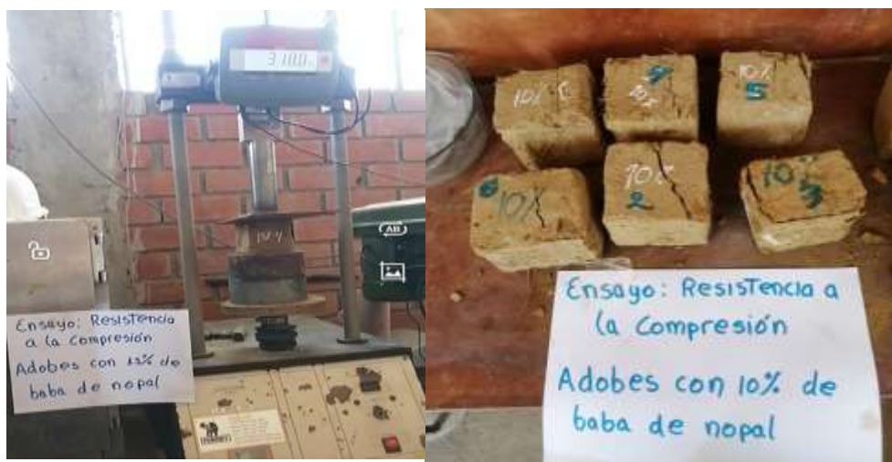
Figura 89: Ensayo de compresión adobes 10% baba de nopal
