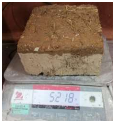
Figura 124: Peso de la muestra luego de la succión
