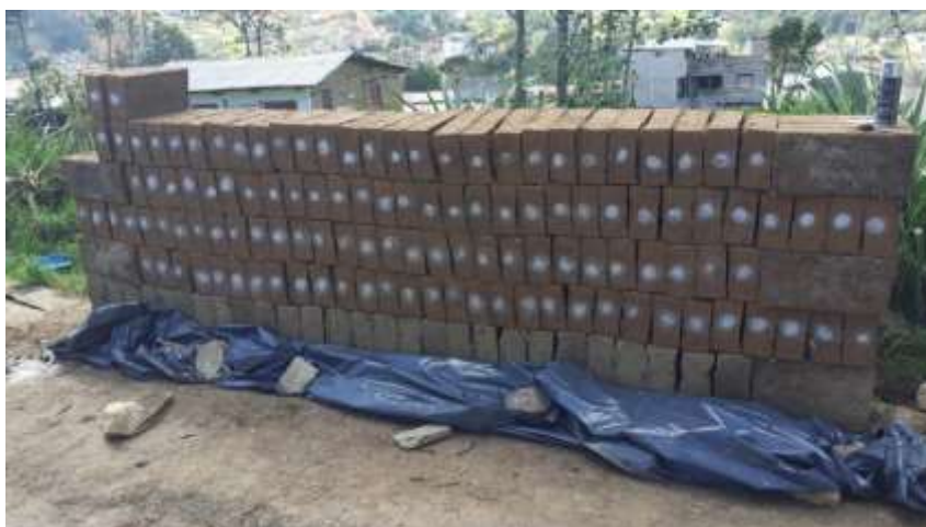
Figura 110: Señalización del adobe con spray
