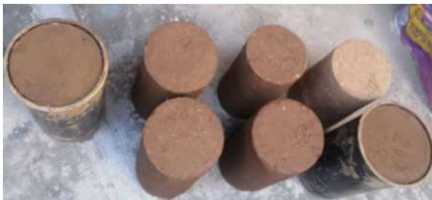
Figura 112: Cilindros de adobe, en muestra patrón y 15% de baba de nopal con 10%, 20% y 30% de RC
