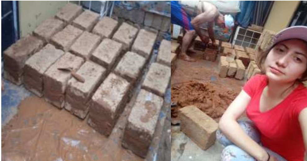
Figura 127: Especímenes para mortero de adobes con 10%.20% y 30% de RC más 15% de BN
