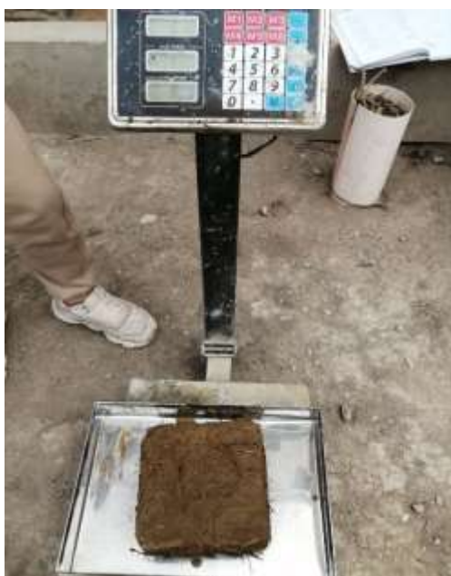
Figura 97: Peso de las medias unidades, luego de del ensayo de absorción
