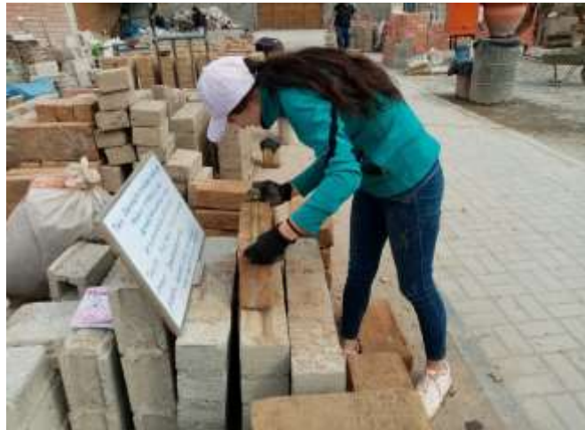
Figura 119: Medidas para dimensionamiento de adobes patrones y modificados con BN Y RC
