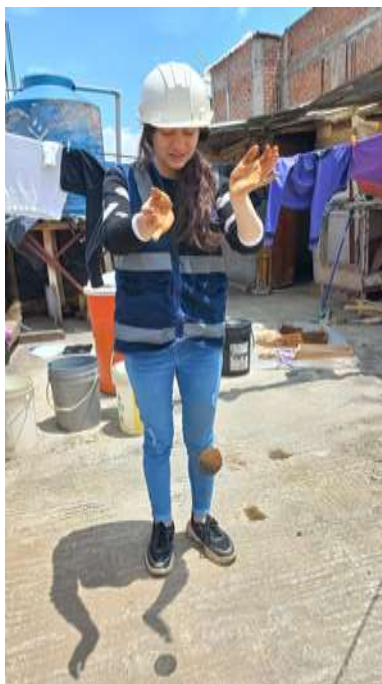
foto 5: Caída de bola de tierra en ensayo de humedad
