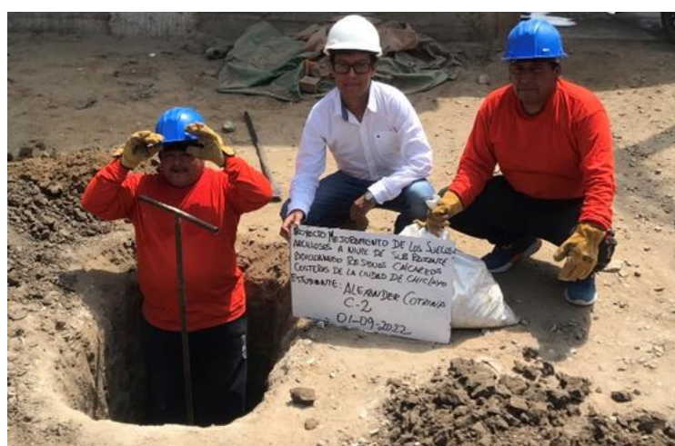
Figura 01. Obtención de muestras subrasantes arcillosas
