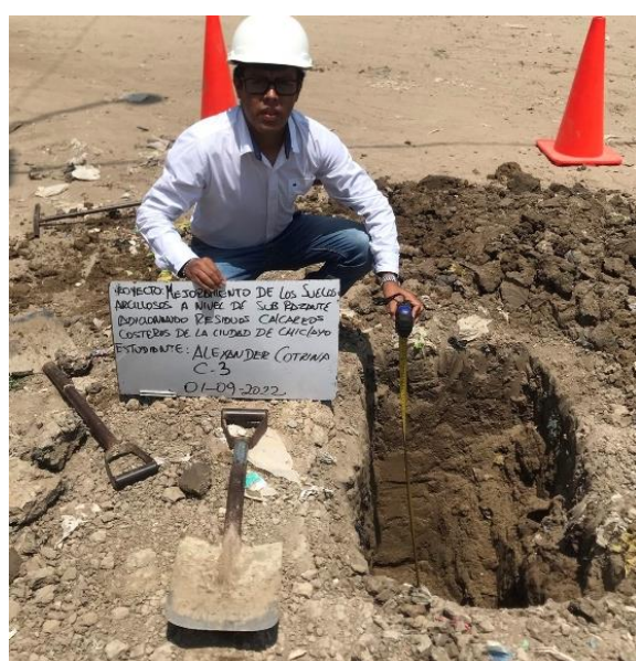
Figura 01. Obtención de muestras subrasantes arcillosas
