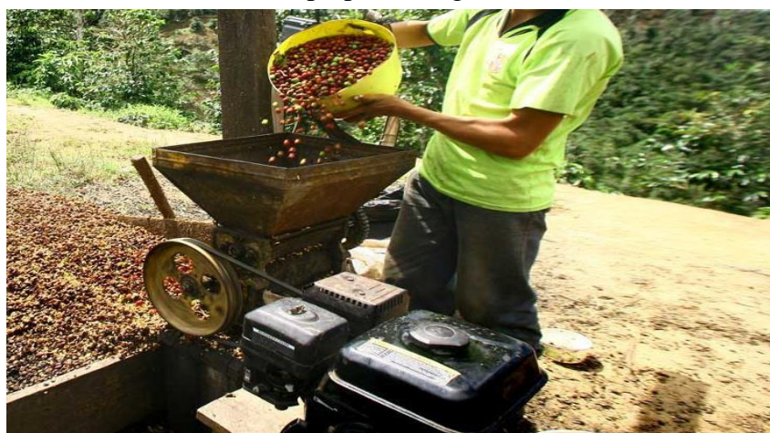
Ilustración 6 despulpado del grano de café
