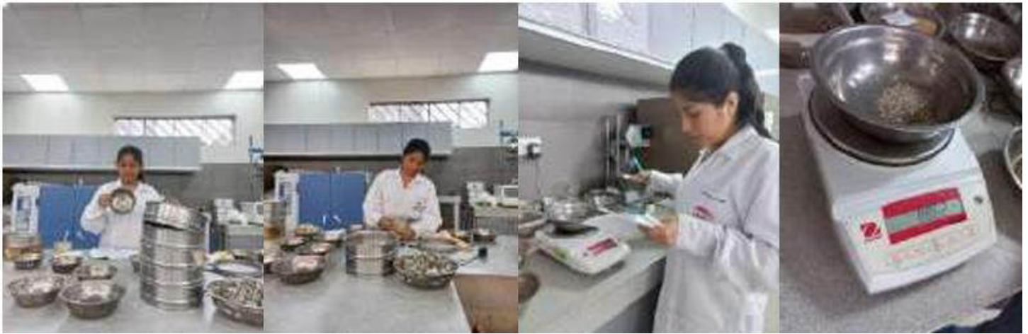
Figura 13: Realización de granulometría
