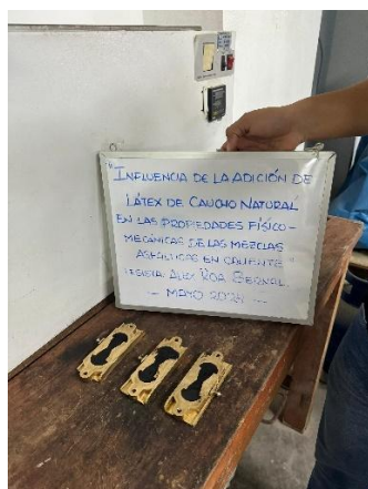
Ilustración 33: Molde de bronce con vaciado de cemento asfáltico
