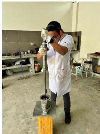
Ilustración 36: Compactación de la MAC
