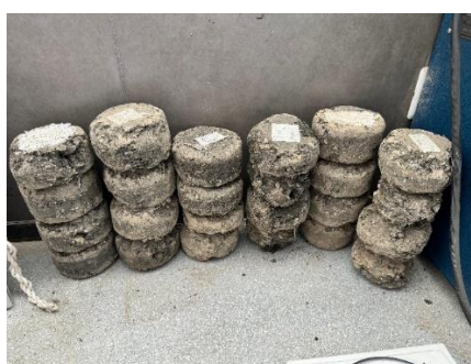
Ilustración 45: Evidencias de briquetas desgastadas por abrasión
