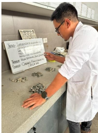
Ilustración 20: Selección de agregado con caras fracturadas
