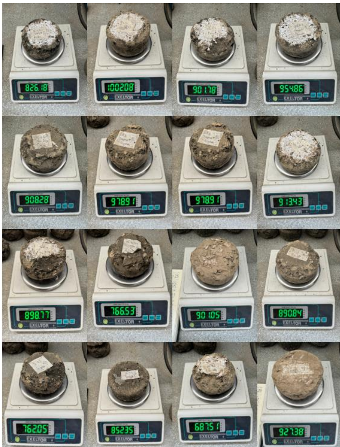
Anexo 65: Evidencias fotográficas de briquetas desgastadas por cantabro
