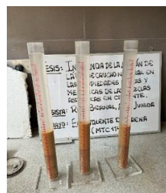
Ilustración 26: Sedimentación de la arcilla
