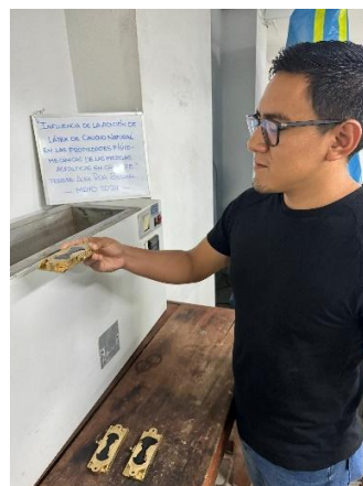
Ilustración 34: Colocación de molde de bronce a baño de agua
