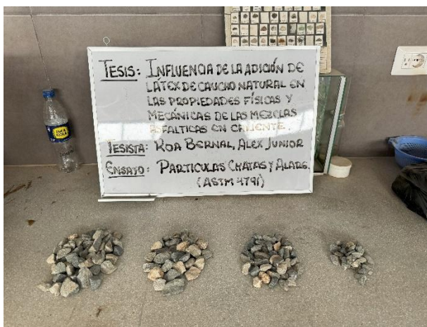
Ilustración 19: Conformación de las masas en función de la forma
