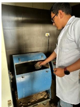
Ilustración 43: Ejecución de la evaluación de pérdida por desgaste por cántabro
