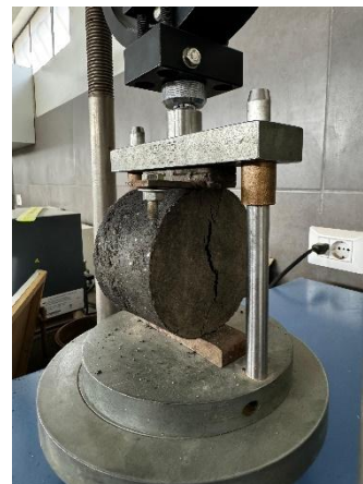
Ilustración 42: Presencia de la falla durante el ensayo de TSR
