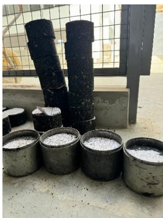
Ilustración 37: Enfriado y desmolde de briquetas
