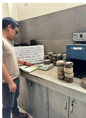
Ilustración 44: Procesamiento de datos para el ensayo de pérdida por desgaste por cántabro
