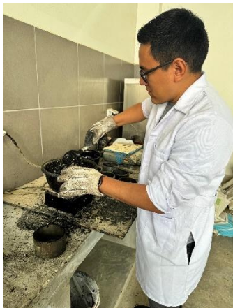
Ilustración 35: Elaboración y conformación de la MAC
