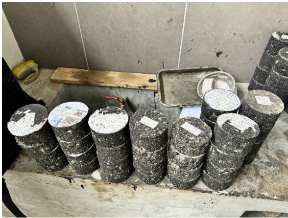
Ilustración 39: Grupo de briquetas secas para ensayo de TSR
