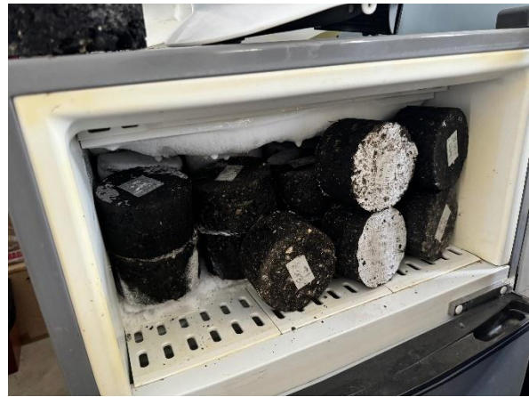
Ilustración 40: Grupo de briquetas llevadas a enfriamiento para ensayo de TSR
