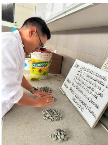
Ilustración 18: Selección de las formas del agregado
