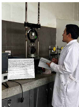
Ilustración 38: Ensayo de estabilidad y fluencia
