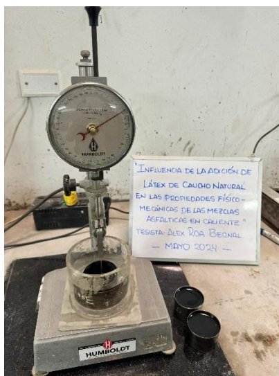
Ilustración 32: Ensayo de penetración al cemento asfáltico patrón y modificado
