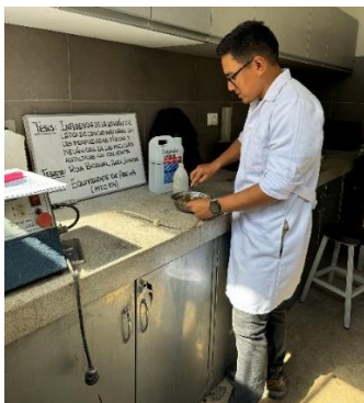
Ilustración 23: Mezclado y reducción de muestra
