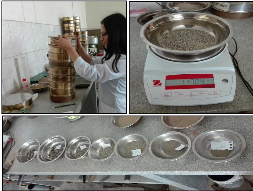
Figura. 5. Ensayo de Granulometría del Agregado Fino
