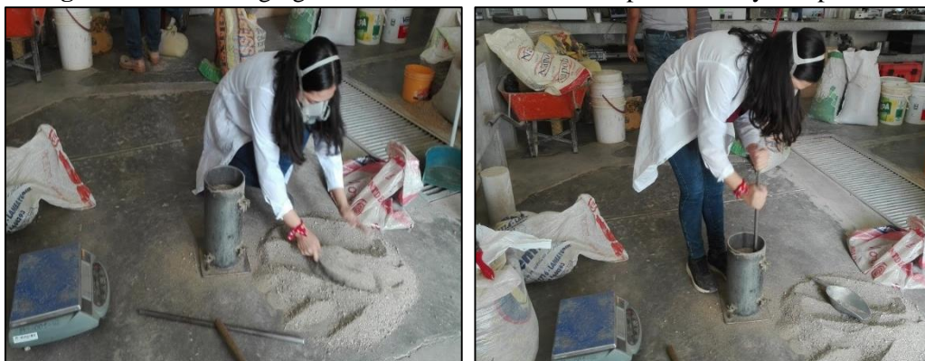
Figura. 9. Muestra agregado fino, determinación de su peso suelto y compactado
