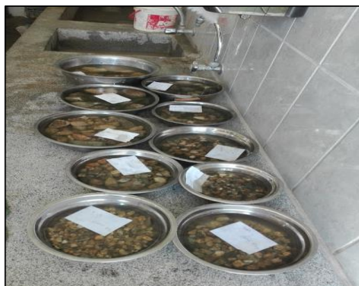
Figura. 11. Primer ciclo de muestra de agregado grueso
