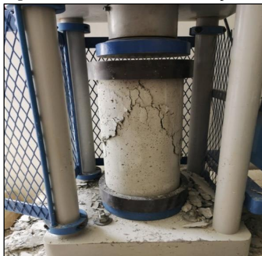
Figura. 16. Muestra sometida a compresión
