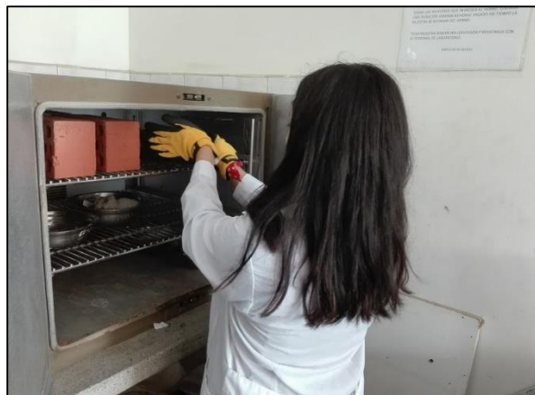
Figura. 6. Muestra de agregado grueso colocada en el horno.
