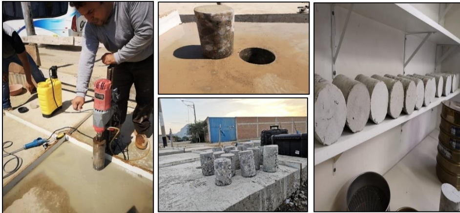
Figura. 17. Extracción de corazones diamantinos en las losas elaboradas en la Ciudad de Olmos
