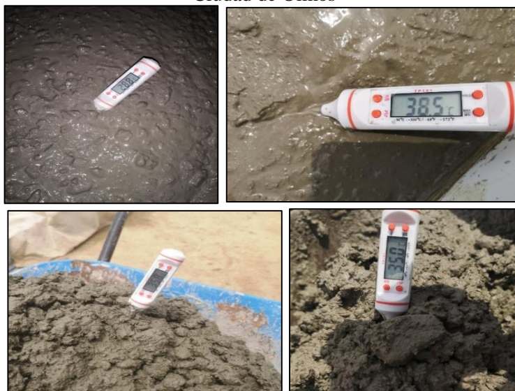
Figura. 15. Temperaturas internas registradas en las muestras, Ciudad de Olmos
