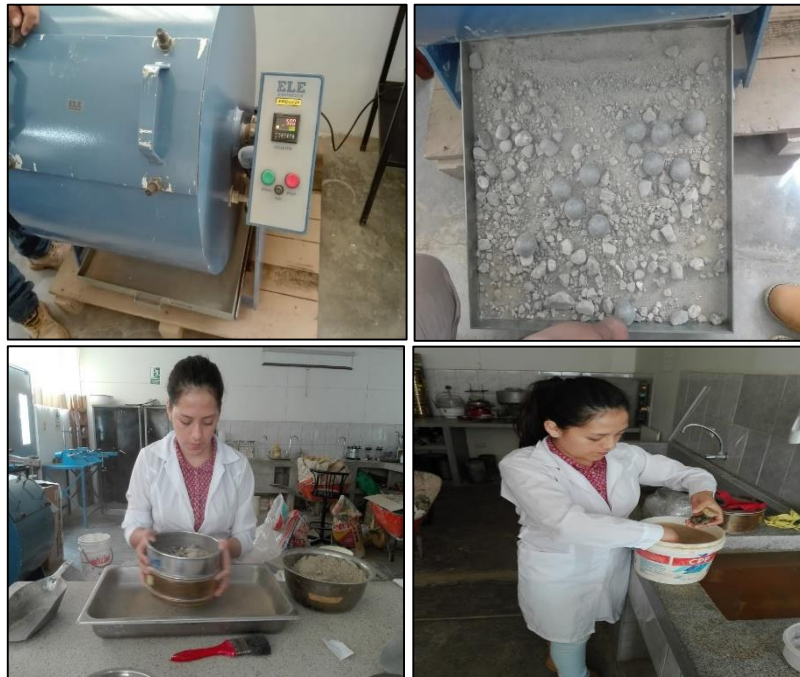
Figura. 12. Muestra de Agregado grueso en el ensayo de Abrasión
