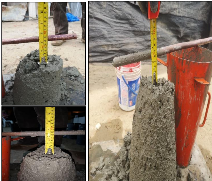
Figura. 14. Ensayo de asentamiento realizado a las muestras, elaboradas en la Ciudad de Olmos.
