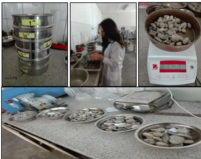
Figura. 4. Ensayo de Granulometría del Agregado Grueso
